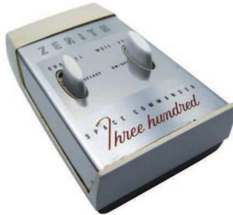
FIGURE 2.1: Zenith Space Command 300, 1956. Deux boutons permettent de contrôler la chaîne et le volume.
