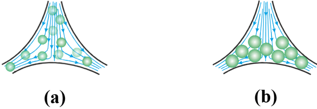
FIGURE 4.15 – Schémas de Vertex avec particules non piégées (a) et particules piégées (b)
