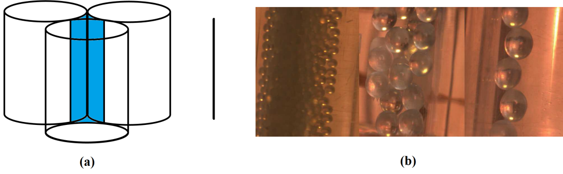
FIGURE 3.15 – (a) Bord de Plateau idéal formé par trois cylindres au contact. (b) Photos d'expériences visant à déterminer la compacité de billes monodisperses dans une telle géométrie. 0,2 < \lambda < 0,8 .
