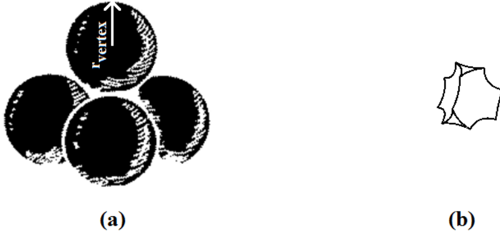
FIGURE 1.7 – (a) Tétrahédre formé de quatre billes. (b) Volume interstitiel formé des quatre billes.
