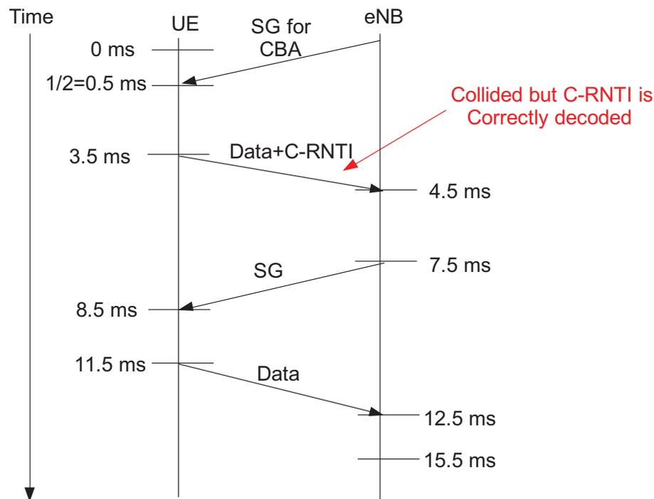
Figure A.11: L'accès de contention sur la base de la détection de collision
