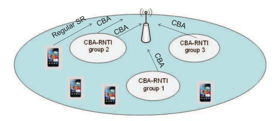
Figure A.9: Acc ès au canal de liaison montante avec acc ès argument fondé
