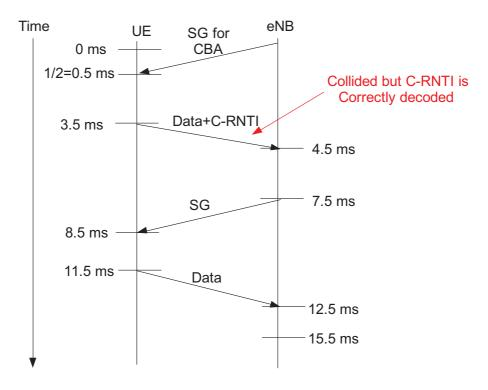
Figure A.11: L'accès de contention sur la base de la détection de collision
