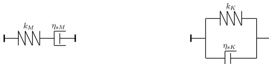
FIGURE 3.2 – Schémas élémentaires de Maxwell (gauche) et Kelvin (droite).
