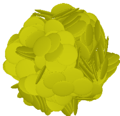
FIGURE 2.15 – Détails de la microstructure aux inclusions ellipsoïdales.
