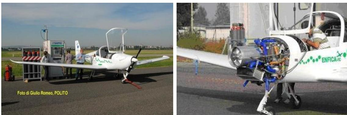
Figure 13 : Rapid 200 modifié équipé d'un système PEMFC du projet ENFICA-FC.
