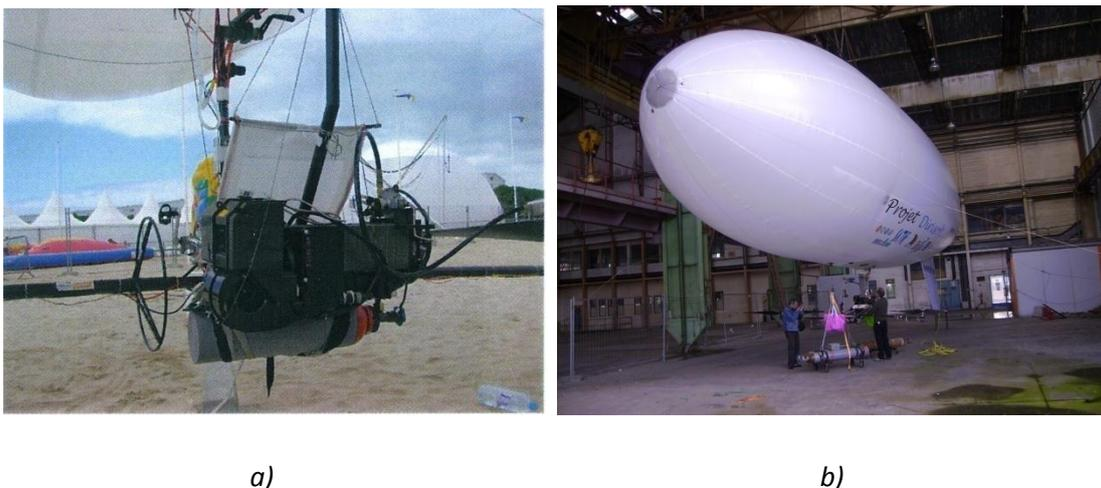
Figure 8 : Photographies du dirigeable Dirisoft MC 160 (b) et de sa PEMFC (a) (NEXA Ballard 1,2 kW).
