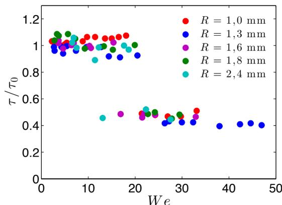
FIGURE 5.22 – Temps de contact  $\tau$  en présence d’une bille superhydrophobe adimensionné par  $\tau_0$  (temps de contact sur une surface plane) en fonction du nombre de Weber  $We$ . Les données expérimentales, correspondant à 5 tailles de gouttes (de rayon  $R$  varié entre 1 et 2,4 mm) se superposent bien. La transition entre  $\tau = \tau_0$  et  $\tau = \tau_0/2$  semble avoir lieu pour un nombre de Weber de l’ordre de 20.
