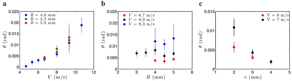
FIGURE 2.18 – Angle  $\theta$  d’inclinaison d’un petit palet en plexiglas en lévitation au dessus d’une surface en mouvement. **a.**  $\theta$  en fonction de la vitesse  $V$  de la surface, pour palets de rayons  $R$  différents et d’épaisseur  $e = 2$  mm. **b.**  $\theta$  en fonction du rayon  $R$  des palets d’épaisseur  $e = 2$  mm pour trois vitesses  $V$  de plateau. **c.**  $\theta$  en fonction de l’épaisseur  $e$  du palet ( $R = 4,5$  mm).
