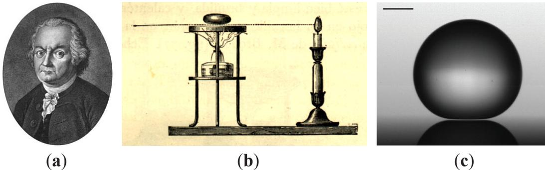
FIGURE 5 – Effet Leidenfrost. **a.** Portrait de Johann Gottlob Leidenfrost (1715-1794). **b.** Schéma expérimental du montage de Leidenfrost. La goutte est maintenue dans un récipient creux, chauffé par dessous. A l'aide d'une bougie, on peut observer le film de vapeur sous la goutte, qui lui permet de rester en lévitation. **c.** Image d'une goutte d'eau millimétrique en caléfaction. La barre indique 1 mm.
