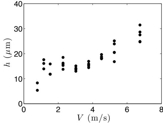
FIGURE 2.3 – Hauteur de lévitation  $h$  de gouttes d’huile silicone de viscosité  $\eta = 100$  mPa.s et de rayon  $R = 1,24$  mm en fonction de la vitesse  $V$  de la surface sur laquelle elles sont déposées.
