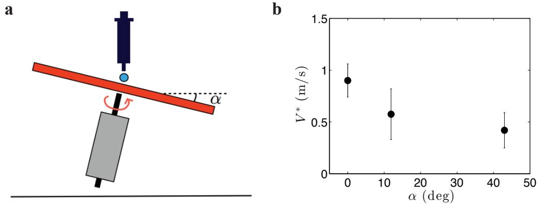
FIGURE 1.13 – Seuil de lévitation  $V^*$  d'une goutte d'huile silicone de viscosité  $\eta = 100$  mPa.s et de rayon  $R = 1,5$  mm posée sur le plateau en rotation, incliné d'un angle  $\alpha$ . **a** Présentation de l'expérience; **b** Seuil  $V^*$  en fonction de l'angle d'inclinaison  $\alpha$ .
