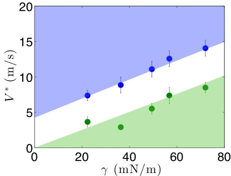
FIGURE 1.11 – Diagramme de phase montrant les différents régimes (en vert : mouillage ; en blanc : lévitation sporadique ; en bleu : lévitation) de gouttes de mélange eau/éthanol (de viscosité  $\eta \simeq 1$  mPa.s et de rayon  $R = 1,4 \pm 0,1$  mm) en fonction de la tension de surface  $\gamma$  du mélange et de la vitesse  $V$  du plateau. Le seuil de mouillage sporadique  $V_p$  est représenté par les points verts et  $V^*$  par les points bleus.
