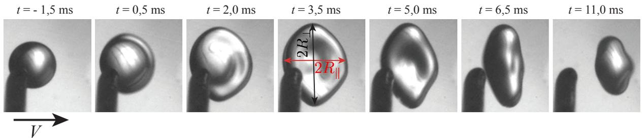
FIGURE 6.3 – Vue de dessus de l'impact d'une goutte d'huile silicone de viscosité  $\eta = 5$  mPa.s sur une surface de plexiglas en mouvement à une vitesse  $V = 24$  m/s. Les gouttes ont un rayon  $R = 1,1$  mm. Le liquide s'étale de façon asymétrique, et on note  $R_{\perp}$  et  $R_{\parallel}$  la taille du film à l'étalement maximal dans les directions perpendiculaire et parallèle au mouvement du substrat.
