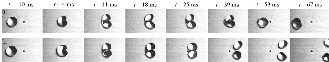
FIGURE A.2 – Vue du dessus de l'impact de gouttes de rayon  $R = 1,7$  mm avec une fibre de rayon  $b = 15$   $\mu\text{m}$ . Les gouttes sont posées sur une surface d'aluminium traité pour être superhydrophobe. **a.** Pour une vitesse d'impact  $U = 24$  cm/s, la goutte se déforme et rebondit, malgré le très fort rapport d'aspect  $R/b = 110$  entre le liquide et le fil. **b.** A  $U = 26$  cm/s, la goutte est coupée par le fil pendant l'impact.
