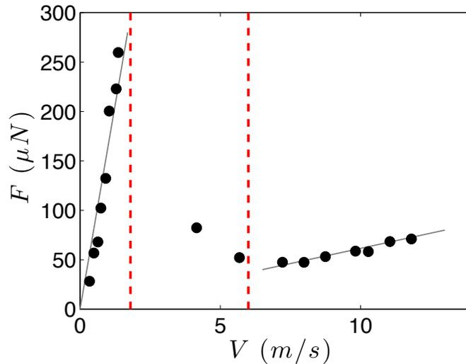
FIGURE 3.17 – Force  $F$  responsable de l'entrainement de gouttes (de viscosité  $\eta = 100$  mPa.s et de rayon  $R = 1,3$  mm) posées sur une surface superhydrophobe en mouvement à vitesse  $V$ . Les deux traits rouges verticaux tracent les vitesses pour lesquelles les gouttes se déstabilisent, ce qui empêche les mesures.
