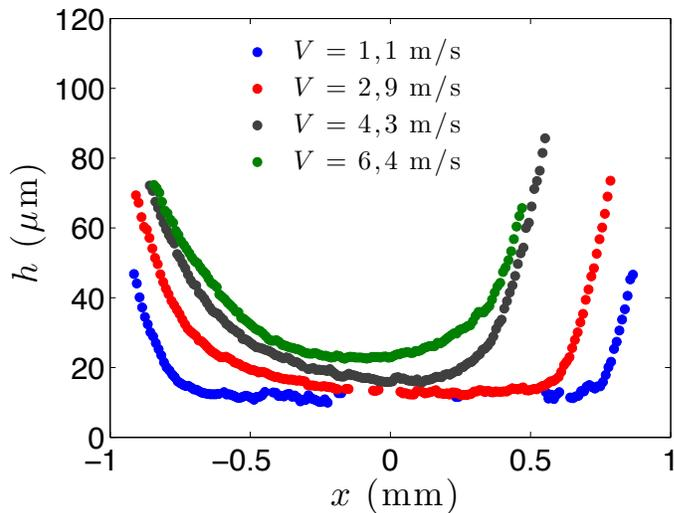
FIGURE 2.7 – Épaisseur  $h$  du film d'air en fonction de la position  $x$  sous la goutte et de la vitesse  $V$  de la surface, pour une goutte d'huile silicone de viscosité  $\eta = 100$  mPa.s et de rayon  $R = 1,24$  mm.
