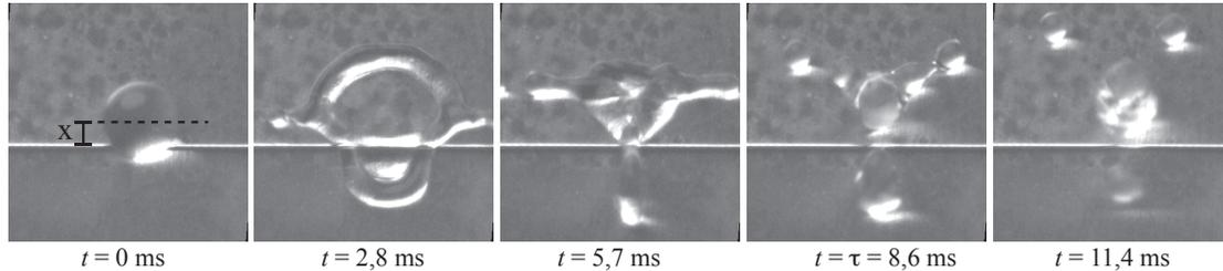
FIGURE 5.13 – Séquence d'images montrant de dessus un rebond excentré d'une goutte d'eau sur un fil superhydrophobe de rayon  $b = 100$   $\mu\text{m}$ . La distance  $x$  entre l'axe du fil et le centre des gouttes est égal à  $0,8$  mm. La goutte a un rayon  $R = 1,3$  mm et sa vitesse d'impact vaut  $U = 1,1$  m/s
