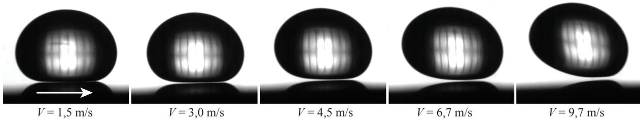
FIGURE 2.1 – Gouttes d'huile silicone (de rayon  $R = 1,24$  mm et de viscosité  $\eta = 100$  mPa.s) en lévitation dynamique pour différentes vitesses  $V$  de plateau. La flèche blanche indique le sens de déplacement de la surface.
