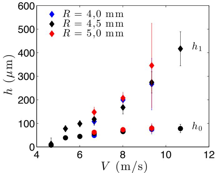
FIGURE 2.17 – Hauteur de lévitation des palets au-dessus de la surface en mouvement. Les hauteurs minimale ( $h_0$ , ronds) et maximale ( $h_1$ , losanges) sont tracées en fonction de la vitesse  $V$  du plateau. Les données correspondant à trois palets de rayon  $R = 3$  mm,  $R = 4$  mm et  $R = 5$  mm sont représentées par des couleurs différentes
