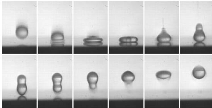
FIGURE 4.10 – Rebond d'une goutte d'eau sur une plaque d'acier chauffée à 300°C. Le rayon  $R$  des gouttes est de 1 mm et la vitesse d'impact  $U = 0,8$  m/s. Les images sont séparées de 1,8 ms. (Crédit : A.-L. Bianco [19])
