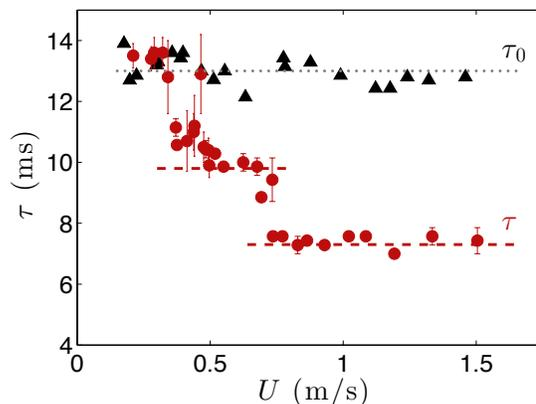
FIGURE 5.7 – Temps de contact de gouttes d’eau de rayon  $R = 1,3$  mm sur une surface superhydrophobe classique (temps  $\tau_0$ , triangles noirs) et sur une surface texturée par un fil de rayon  $b = 100$   $\mu\text{m}$  (temps  $\tau$ , ronds rouges), en fonction de leur vitesse d’impact  $U$ . Les lignes en pointillés gris (pour  $\tau_0$ ) et tirets rouges (pour  $\tau$ ) sont des guides pour l’œil.
