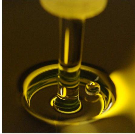
FIGURE 1.3 – Goutte d’huile silicone de rayon  $R = 1$  mm en lévitation dans un ressaut hydraulique du même liquide (Crédit : A. Duschesne *et al.* [34]).
