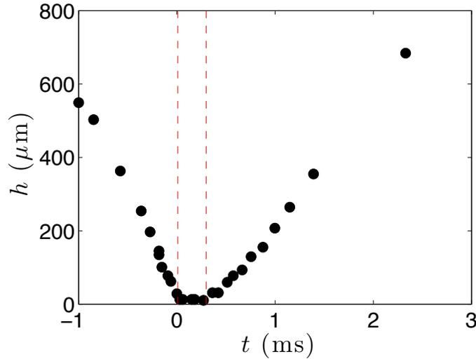
FIGURE 6.9 – Distance  $h$  entre le bas d’une goutte d’éthanol de rayon  $R = 0,75$  mm et une surface en mouvement en fonction du temps  $t$ . La goutte arrive avec une vitesse initiale  $U = 0,07$  m/s, et la surface se déplace à une vitesse  $V = 29$  m/s. Les deux traits pointillés correspondent à la zone pour laquelle l’épaisseur  $h$  est minimale, ce qui permet de définir un temps de contact  $\tau_H = 0,3$  ms.
