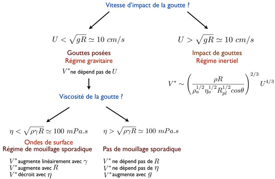
FIGURE 1.24 – Diagramme montrant la dépendance de la vitesse seuil de lévitation  $V^*$  en fonction de la vitesse d'impact  $U$ , la tension de surface  $\gamma$ , la viscosité  $\eta$  et le rayon  $R$  des gouttes.
