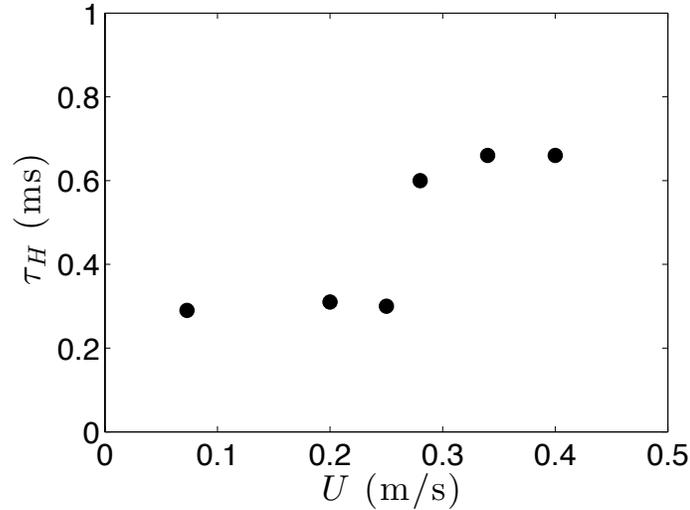
FIGURE 6.10 – Temps de contact  $\tau_H$  correspondant au temps nécessaire pour repousser le bas d'une goutte d'éthanol de rayon  $R = 0,75$  mm en fonction de sa vitesse d'impact  $U$ . La vitesse de la surface est constante et vaut  $V = 28$  m/s.
