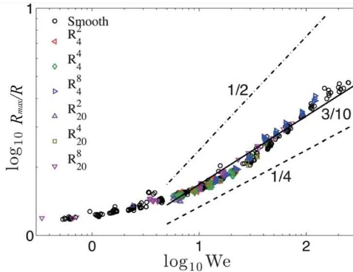
FIGURE 4.11 – Rayon maximal d'étalement de gouttes d'eau ( $R_{max}$  (adimensionné par leur rayon  $R$ ) en fonction du nombre de Weber  $We$ , sur différentes surfaces : les ronds noirs correspondent à des surfaces lisses, et les autres points à des surfaces texturées par des piliers micrométriques dont le pas a été varié. Cette figure est tirée de [89].
