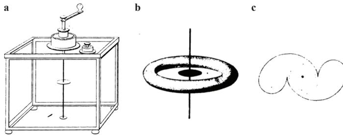
FIGURE 3.11 – Expérience de Plateau **a**. Montage : une masse d'huile d'olive (de 10 cm environ) est placée dans un mélange eau/éthanol de même densité. On fait tourner cette masse à l'aide d'une manivelle. **b**. Forme d'anneau prise par la goutte d'huile. **c**. Forme à deux lobes.
