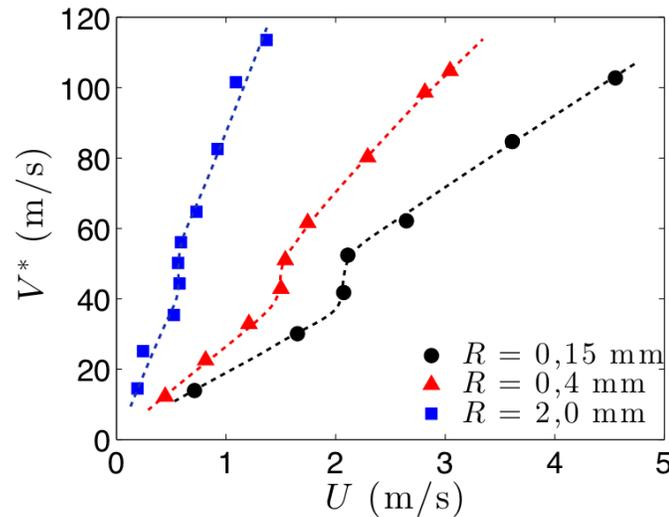
FIGURE 1.19 – Vitesse seuil  $V^*$  de rebond de gouttes d'eau en fonction de leur vitesse d'impact  $U$  pour  $R = 0,15$  mm (ronds noirs),  $R = 0,3$  mm (triangles rouges) et  $R = 2$  mm (carrés bleus). Les pointillés sont des guides pour l'oeil. Autour de  $V = 50$  m/s, on distingue un saut dans les mesures expérimentales, qui correspond au passage d'une couche limite laminaire à turbulente sur le plateau. Données tirées de [37].
