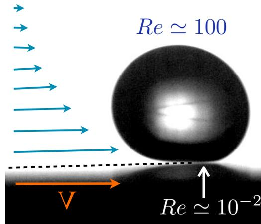
FIGURE 1.15 – Image représentant le film d’air autour d’une goutte d’huile silicone de rayon  $R = 0,9$  mm et de viscosité  $\eta = 100$  mPa.s lévitant au-dessus d’une surface en mouvement à une vitesse  $V$  de l’ordre de quelques m/s. On a représenté la forme (et la taille) de la couche limite par des flèches bleues, et écrit la valeur des nombres de Reynolds autour de la goutte (en bleu) et dans le film d’air sous la goutte (en blanc) pour une vitesse  $V = 1$  m/s.
