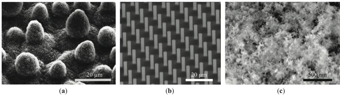
FIGURE 4 – Images de textures sur des surfaces superhydrophobes naturelles ou artificielles, prises au microscope électronique à balayage (MEB). **a.** Surface d'une feuille de lotus. Crédit : C. Neinhuis et W. Barthlott. **b.** Surface de silicium, texturée artificiellement par de petits piliers. Crédit : M. Reyssat. **c.** Surface d'aluminium, traitée par de l'Ultra Ever Dry, qui forme une couche micrométrique de particules de silicium de 20 nm de diamètre environ.
