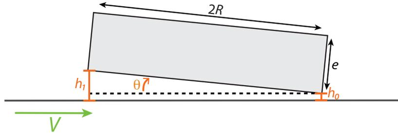
FIGURE 2.16 – Schéma d’un petit palet en lévitation au-dessus d’une surface en mouvement à la vitesse  $V$ . Le palet a un diamètre  $2R$  et une épaisseur  $e$ . Il lévite, incliné d’un angle  $\theta$ . On note  $h_0$  la distance minimale à la surface et  $h_1 = h_0 + 2R\theta$  l’épaisseur maximale du film d’air sous le palet.
