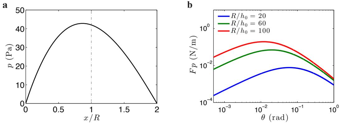
FIGURE 2.20 – **a**. Représentation de la pression  $p(x)$  sous le palet (calculée à partir de la formule (2.11)) pour  $R = 1$  mm,  $V = 1$  m/s,  $\theta = 10^{-3}$ . La ligne en pointillés en  $x = R$  indique le milieu du palet. **b**. Force de portance créée par le confinement de l'air dans un coin en fonction de l'angle  $\theta$ .  $F_p$  est tracée pour différentes valeurs de  $R/h_0$ , prises entre  $R/h_0 = 20$  et  $R/h_0 = 100$ .
