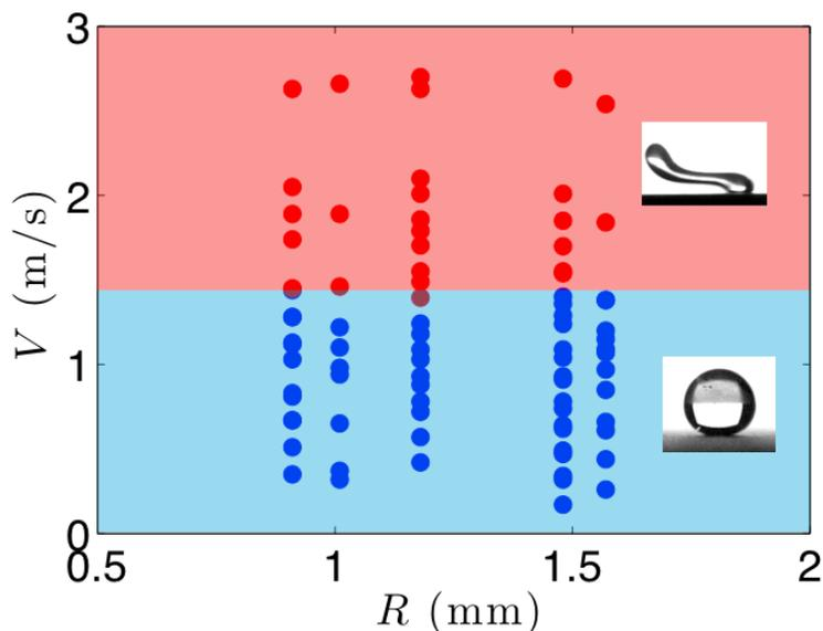
FIGURE 3.10 – Diagramme de phase montrant la forme prise par des gouttes (d'un mélange de glycérol et d'eau de viscosité  $\eta = 100$  mPa.s) en fonction de leur rayon  $R$  et de la vitesse  $V$  de la surface superhydrophobe sur laquelle elles sont posées. Dans la zone bleue, le liquide a une forme sphérique, alors que dans la zone rouge, il prend une forme à deux lobes.
