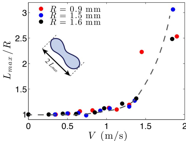
FIGURE 3.9 – Taille maximale  $L_{max}$  de gouttes (adimensionnée par leur rayon  $R$ ) en fonction de la vitesse  $V$  de la surface superhydrophobe sur laquelle elles sont posées. La viscosité  $\eta$  du mélange eau/glycérol est fixée à  $\eta = 100$  mPa.s et trois rayons  $R$  sont considérés ( $R = 0,9$  mm,  $R = 1,5$  mm et  $R = 1,6$  mm). Le petit schéma indique comment  $L_{max}$  est mesuré. La ligne pointillée grise est un guide pour l'oeil.
