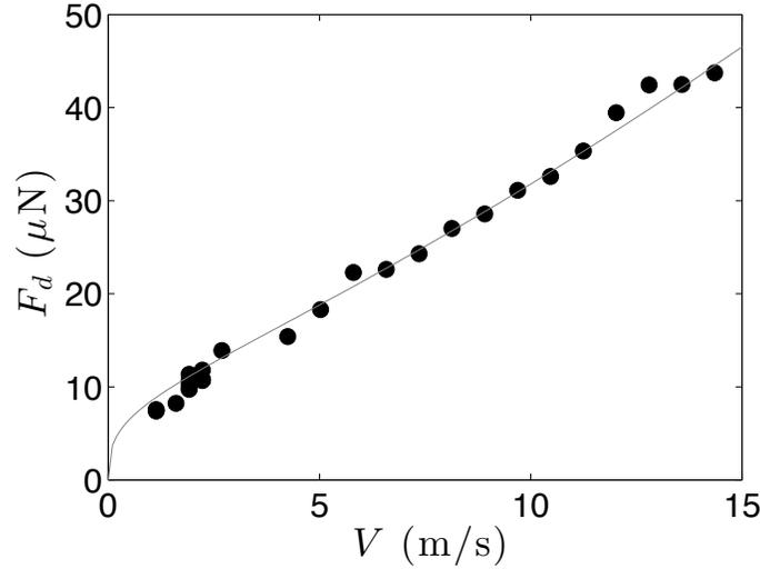
FIGURE 2.10 – Mesure de la force de friction  $F_d$  exercée par l’air sur une goutte de glycérol ( $\eta = 1000$  mPa.s) en fonction de la vitesse  $V$  du plateau. Le rayon  $R$  des gouttes vaut  $R = 1,2$  mm. La courbe pointillée est un ajustement par une fonction de la forme  $F_d = \alpha (\eta_a^{1/3} \gamma^{2/3}) R V^{1/3} + \beta \sqrt{\eta_a \rho_a R_{pl}} R V^{3/2}$ , où  $\alpha = 1,5$   $\beta = 0,3$  sont des constantes (eq. (2.6)).
