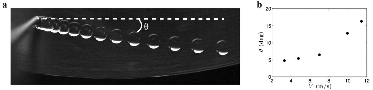
FIGURE 2.8 – **a.** Positions successives d’une goutte d’huile silicone de rayon  $R = 1,25$  mm posée à 1 cm environ du bord du plateau en mouvement. La vitesse de la surface sous l’aiguille est  $V = 3,5$  m/s. Les images sont séparées de 12,5 ms. **b.** Mesure de l’angle  $\theta$  entre la trajectoire de la goutte et la tangente au plateau (pointillés en **a**), en fonction de la vitesse  $V$  de la surface.
