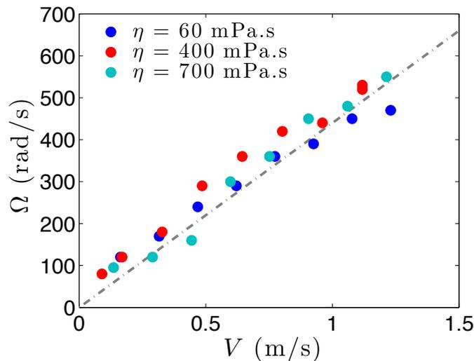
FIGURE 3.7 – a. Vitesse angulaire  $\Omega$  en fonction de la vitesse  $V$  de la surface superhydrophobe pour des gouttes de viscosité  $\eta$  variée entre 60 et 700 mPa.s. Le rayon  $R$  des gouttes est fixé à  $R = 0,9$  mm. La ligne en pointillés est un guide pour l'œil.
