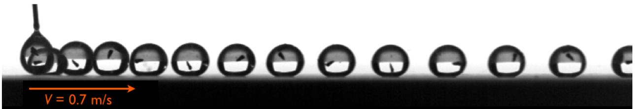
FIGURE 3.2 – Chronophotographie montrant le mouvement d'une goutte de rayon  $R = 0,9$  mm et de viscosité  $\eta = 100$  mPa.s sur une surface superhydrophobe en mouvement ( $V = 0,7$  m/s). Un grain de poivre est placé dans la goutte pour rendre visible le mouvement du liquide. Les images sont séparées de 8,3 ms.
