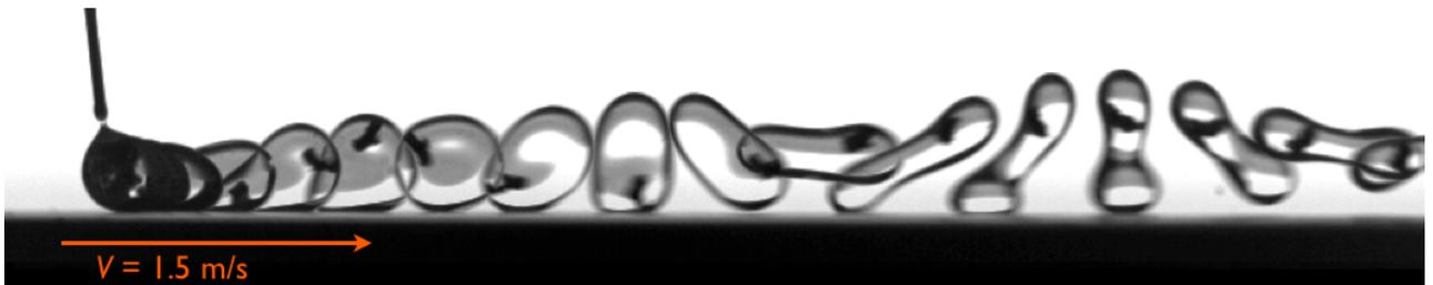
FIGURE 3.8 – Chronophotographie montrant le comportement d'une goutte de rayon  $R = 0,9$  mm posée sur une surface superhydrophobe en mouvement (dans le sens de la flèche) à  $V = 1,5$  m/s. Le liquide est un mélange de glycérol et d'eau, de viscosité  $\eta = 100$  mPa.s. Les images sont séparées de 2,6 ms.
