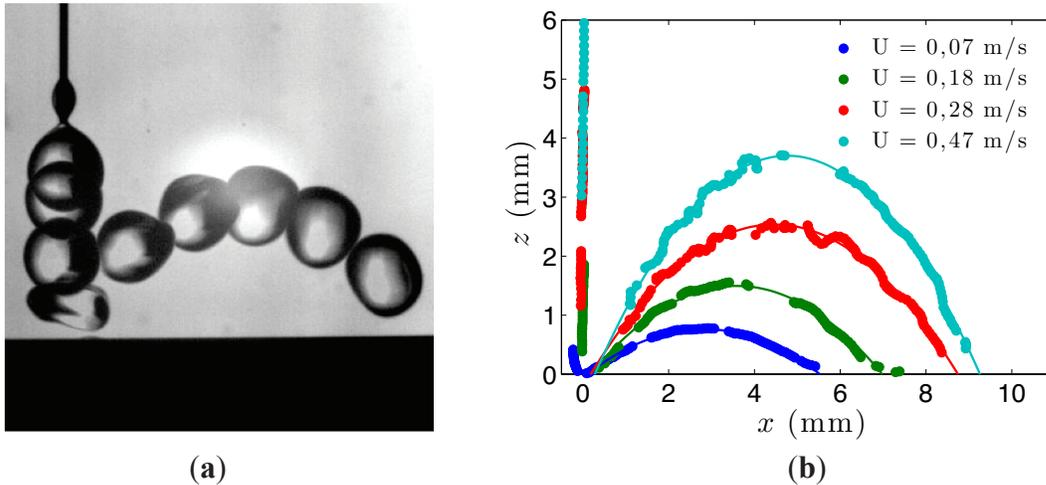
FIGURE 6.11 – a. Séquence d'images montrant la trajectoire suivie par une goutte d'eau lorsqu'elle tombe sur une surface en mouvement. b. Mesure de la position  $z(x)$  du centre de masse de gouttes d'eau de rayon  $R = 1,0$  mm en fonction du temps au cours de leur rebond sur la surface du plateau, pour différentes vitesses d'impact  $U$
