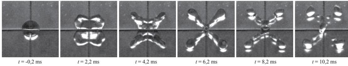
FIGURE 5.17 – Vue du dessus de l’impact d’une goutte d’eau de rayon  $R = 1,3$  mm sur des fils superhydrophobes (de rayon  $b = 100$   $\mu\text{m}$  disposés en croix. La vitesse d’impact est  $U = 0,9$  m/s. Dès les premiers instants, la texture fragmente la goutte en 4 sous-unités de même taille. Le temps de contact  $\tau$  vaut  $\tau = 6,6$  ms, une valeur très proche  $\tau_0/2 = 6,5 \pm 0,4$  ms, où  $\tau_0$  est le temps de contact sur une surface superhydrophobe non texturée.
