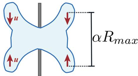
FIGURE 5.10 – Schéma montrant la rétraction d'une goutte divisée en 4 lobes. Les 4 lobes, initialement séparés d'une distance  $\alpha R_{max}$  se rapprochent deux à deux à une vitesse  $u \sim \sqrt{\frac{\gamma}{\rho R}}$ . La transition 4/2 lobes a lieu lorsque les 4 sous-unités ont le temps de se regrouper en deux fragments de part et d'autre du fil avant que la goutte ne rebondisse.
