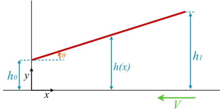
FIGURE 2.19 – Schéma du film d'air sous le palet entrainé par la surface se déplaçant de la droite vers la gauche à la vitesse  $V$ . La partie inférieure du palet, représentée en rouge, est inclinée d'un angle  $\theta$ . L'épaisseur du film d'air à la position  $x$  est notée  $h(x)$ . On a  $h(x) = h_0 + x\theta$ , où  $h_0$  est l'épaisseur minimale du film, à l'aval. En  $x = 2R$ , l'épaisseur du film est notée  $h_1$ , avec  $h_1 = h_0 + 2R\theta$ .
