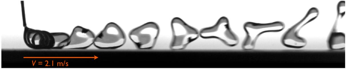
FIGURE 3.14 – Chronophotographie montrant le mouvement et les formes successives prises par une goutte de rayon  $R = 0,9 \text{ mm}$  posée sur une surface superhydrophobe qui se déplace à vitesse  $V = 2,1 \text{ m/s}$ . Les images sont séparées de 3,6 ms. La goutte adopte de façon temporaire une forme à trois lobes, qui se déstabilise ensuite en deux lobes.
