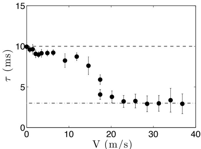
FIGURE 6.15 – Temps de rebond  $\tau$  d'une goutte d'eau de rayon  $R = 1,05$  mm de vitesse  $U = 0,37$  m/s en fonction de la vitesse  $V$  de la surface superhydrophobe sur laquelle elle tombe. La ligne en tirets trace le temps de rebond  $\tau_0 = 10$  ms sur la surface superhydrophobe immobile, et la ligne pointillés le temps de rebond dynamique  $\tau = 3$  ms sur la surface en mouvement à grande vitesse  $V$ .
