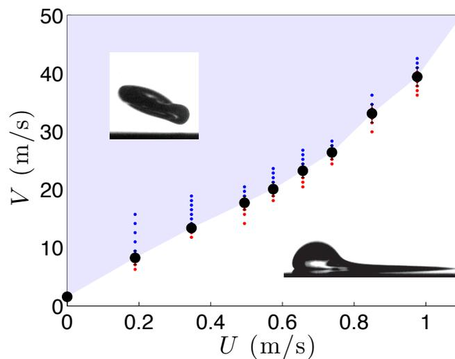
FIGURE 1.17 – Comportement de gouttes d'huile silicone de viscosité  $\eta = 96$  mPa.s approchant à vitesse  $U$  une surface de vitesse  $V$ . Les points en bleu (et la zone bleue) montrent les cas où la goutte est repoussée par la surface en mouvement, et les points rouges correspondent aux cas où la goutte touche la surface. Les gouttes ont un rayon  $R = 0,9$  mm. Les cercles noirs indiquent le seuil de rebond des gouttes.
