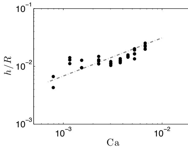
FIGURE 2.5 – Diagramme en log-log montrant l'épaisseur  $h$  du film d'air sous la goutte (adimensionnée par leur rayon  $R$ ) en fonction du nombre capillaire  $Ca = \frac{\eta_a V}{\gamma}$  pour une goutte d'huile silicone ( $\eta = 100$  mPa.s) de rayon  $R = 1,24$  mm. La courbe en pointillés a pour équation  $h/R = 0,65 Ca^{0,66}$ .
