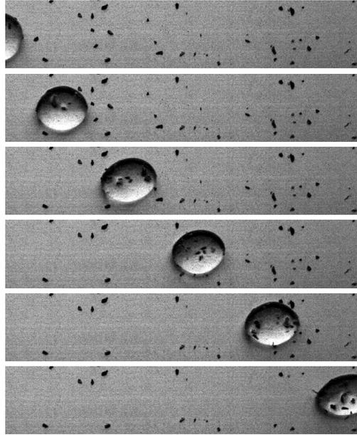
FIGURE 3.1 – Images successives d'une goutte d'eau dévalant un plan incliné superhydrophobe, "sali" par des grains de poivre. La goutte, en s'avançant sur le substrat, emporte avec elles les grains, laissant la surface propre après son passage.
