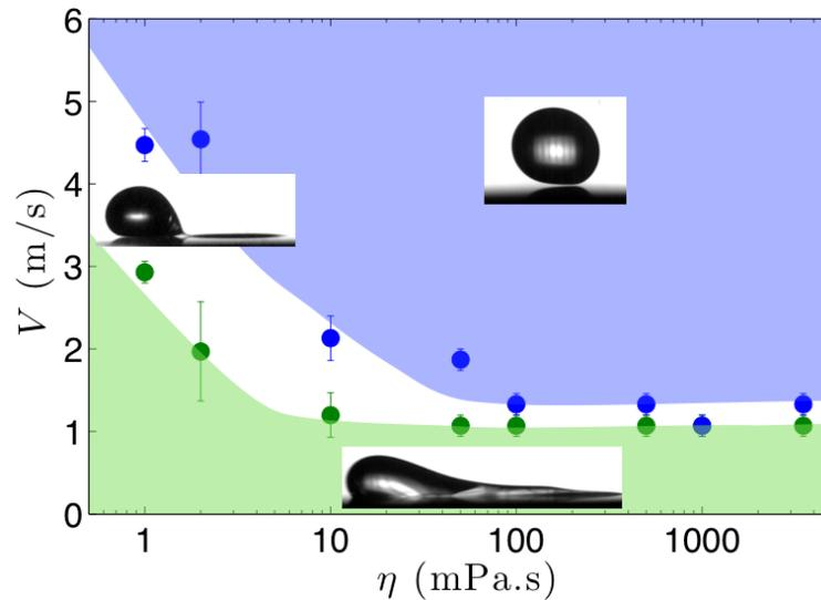
FIGURE 1.10 – Diagramme de phase montrant les différents états d'une goutte posée sur la surface d'un plateau en mouvement en fonction de leur viscosité  $\eta$  et de la vitesse  $V$  de la surface. Les ronds verts représentent le seuil de mouillage sporadique  $V_p$  et les ronds bleus le seuil de lévitation  $V^*$ . Couleurs de fond : en vert : mouillage ; en blanc : lévitation sporadique ; en bleu : lévitation.
