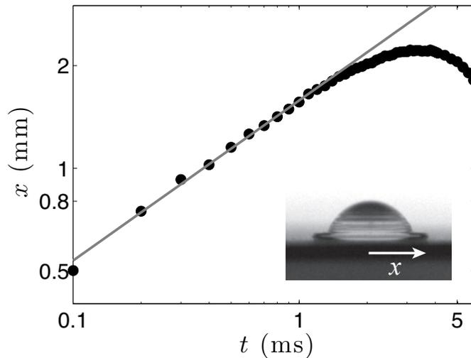
FIGURE 4.6 – Position  $x(t)$  du film de liquide au cours de l'étalement d'une goutte d'eau de rayon  $R = 1,3$  mm sur une surface superhydrophobe. L'image indique comment est mesuré  $x(t)$ . La vitesse d'impact est  $U = 0,8$  m/s. Pour  $t < 1$  ms, tous les points s'alignent sur une même droite (en log-log), ce qui montre que  $x$  est de la forme  $x \propto t^\alpha$  avec  $\alpha = 0,47 \pm 0,02$ .
