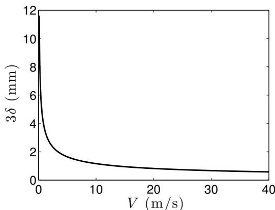
FIGURE 1.7 – Epaisseur de la couche limite en fonction de la vitesse  $V$  du plateau. L'épaisseur de la couche limite est prise à une hauteur  $z = 3\delta$  pour laquelle la vitesse de l'air  $v_a$  vérifie  $v_a < V/10$ .
