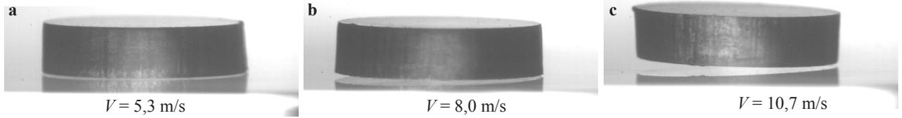
FIGURE 2.15 – Images d’un palet de rayon  $R = 4,5$  mm et d’épaisseur  $e = 2$  mm en lévitation au-dessus d’une surface en mouvement pour trois différentes vitesses :  $V = 5,3$  m/s (a),  $V = 8,0$  m/s (b) et  $V = 10,7$  m/s (c). On distingue clairement un mince film d’air entre le disque et son reflet, qui caractérise de la lévitation.
