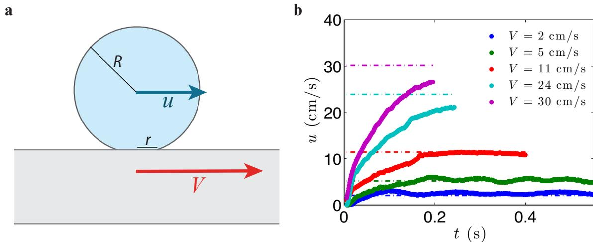
FIGURE 3.3 – **a.** Schéma montrant une goutte posée sur une surface superhydrophobe en mouvement. La vitesse de son centre de masse est notée  $u$ . **b.**  $u$  en fonction du temps  $t$  pour différentes vitesses  $V$  du substrat superhydrophobe. Les lignes en pointillés montrent la vitesse  $V$ , correspondant à la série de points de la même couleur. Les gouttes ont un rayon  $R = 0,9$  mm et sont formées d'un mélange d'eau et de glycérol de viscosité  $\eta = 100$  mPa.s.
