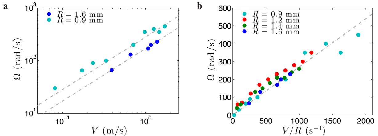
FIGURE 3.6 – a. Vitesse angulaire  $\Omega$  de gouttes de viscosité  $\eta = 100$  mPa.s en fonction de la vitesse  $V$  de la surface superhydrophobe sur laquelle elles sont posées (pour deux rayons  $R$ ). Les lignes en pointillés sont des droites de pente 1 en échelle logarithmique. b.  $\Omega$  en fonction de  $V/R$ . La ligne en pointillé est une droite de pente 0,27.
