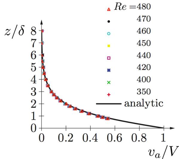
FIGURE 1.6 – Comparaison de mesures expérimentales de la vitesse  $v_a$  de l'air entraîné par le mouvement du plateau (adimensionnée par la vitesse  $V$  de la surface) en fonction de la distance au plateau  $z$  (adimensionnée par l'épaisseur caractéristique de la couche limite  $\delta$ ), pour différents nombres de Reynolds. Cette figure est tirée de [42].
