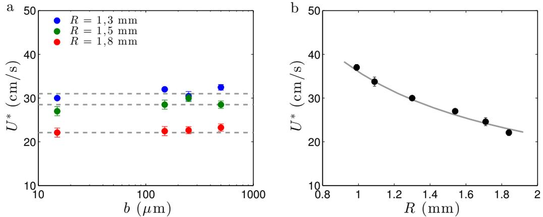
FIGURE A.3 – **a.** Vitesse seuil de coupure  $U^*$  en fonction du rayon  $b$  du fil, pour différentes tailles de gouttes. **b.**  $U^*$  en fonction du rayon  $R$  des gouttes, pour  $b = 15 \mu\text{m}$ . La ligne en gris montre l’ajustement des données par une courbe de la forme  $U^* \sim R^\alpha$ , avec  $\alpha = -0,74$ .
