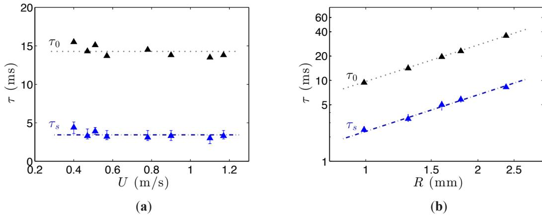
FIGURE 4.5 – Temps de contact  $\tau_0$  (triangles noirs) et d'étalement  $\tau_s$  (triangles bleus) de gouttes d'eau sur une surface superhydrophobe. **a.** En fonction de la vitesse d'impact  $U$  des gouttes **b.** En fonction de leur rayon  $R$ . Les données sont ajustées par les courbes d'équation  $\tau_0 = 2,6\sqrt{\frac{\rho R^3}{\gamma}}$  (pointillés gris) et  $\tau_s = \tau_0/4$  (tirets bleus).
