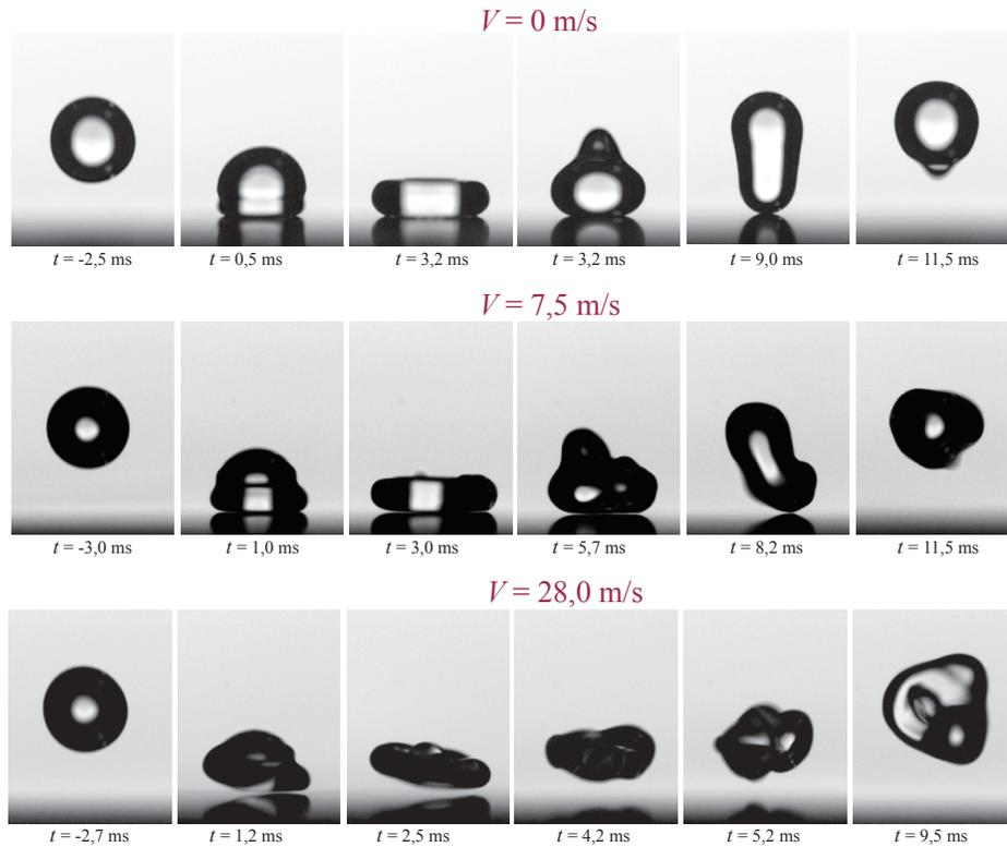
FIGURE 6.14 – Rebond de gouttes d'eau de rayon  $R = 1$  mm sur une surface superhydrophobe en mouvement, pour trois vitesses de la surface  $V = 0$  m/s,  $V = 7,5$  m/s et  $V = 28$  m/s. La vitesse d'impact  $U$  de l'eau est constante ( $U = 0,37$  m/s)
