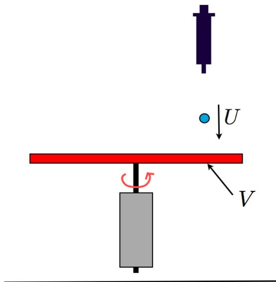
FIGURE 1.5 – Dispositif expérimental. On fait tomber à l'aide d'une seringue une goutte sur un plateau en rotation. La vitesse de la goutte au moment de l'impact est notée  $U$  et la vitesse du plateau sous la goutte  $V$ .
