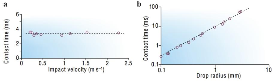
FIGURE 4.4 – Temps de contact  $\tau_0$  de gouttes d’eau sur une surface superhydrophobe. **a.** En fonction de la vitesse d’impact  $U$  des gouttes. **b.** En fonction de leur rayon  $R$  (Graphiques extraits de [14]).
