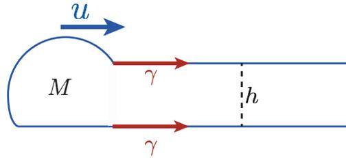
FIGURE 4.9 – Schéma en coupe montrant un film liquide en train de se rétracter à vitesse  $u$ . Le bourrelet de liquide, de masse variable  $M$ , est entraîné par la tension de surface  $\gamma$  sur ses deux faces.
