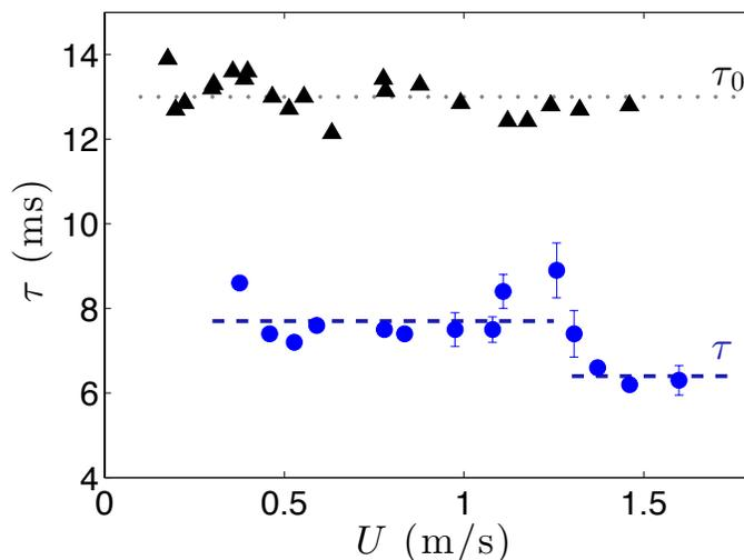
FIGURE 5.16 – Temps de contact de gouttes d’eau (de rayon  $R = 1,3$  mm) sur une surface superhydrophobe plane (temps  $\tau_0$ , triangles noirs) et sur une surface texturée par trois fils (de rayon  $b = 100$   $\mu\text{m}$  disposés en Y (temps  $\tau$ , ronds bleus).  $\tau_0$  et  $\tau$  sont représentés en fonction de la vitesse d’impact  $U$  des gouttes. Les lignes pointillées et en tirets sont des guides pour l’œil.
