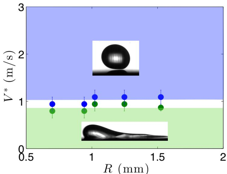
FIGURE 1.12 – Diagramme de phase montrant les seuils de lévitation partielle (ronds verts) et de lévitation totale (ronds bleus) en fonction du rayon  $R$  des gouttes et de la vitesse  $V$  de la surface sur laquelle elles sont déposées.
