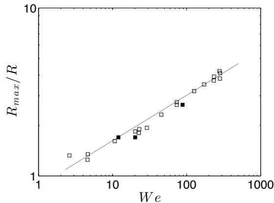
FIGURE 4.3 – Rayon maximal d'étalement  $R_{max}$  (adimensionalisé par  $R$ ) de gouttes d'eau (carrés blancs) et de mercure (carrés noirs) sur une surface superhydrophobe en fonction du nombre de Weber ( $We$ ). La droite en gris trace la courbe de formule  $R_{max}/R = 0,9 We^{0,27}$ . Les données de ce graphique sont tirées de [75].
