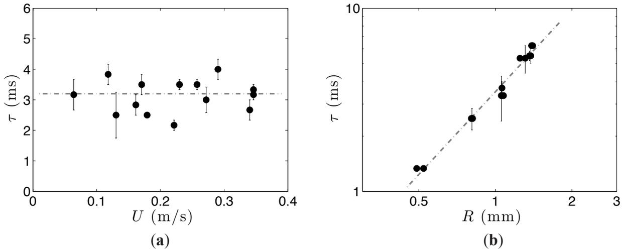
FIGURE 6.7 – Temps de rebond  $\tau$  d'une goutte d'éthanol sur une surface en mouvement à une vitesse  $V = 16$  m/s. **a.**  $\tau$  en fonction de la vitesse d'impact  $U$ , pour un rayon  $R = 0,83$  mm, et une vitesse de plateau  $V = 16$  m/s; **b.**  $\tau$  en fonction de  $R$ , pour  $U = 0,4$  m/s.
