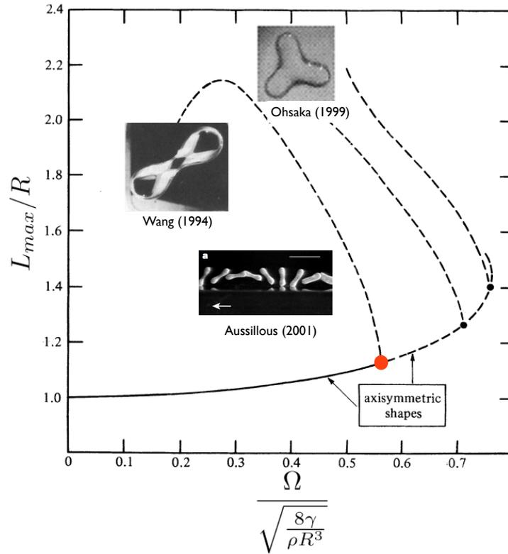
FIGURE 3.12 – Taille adimensionnée  $L_{max}/R$  de gouttes en rotation en fonction de leur vitesse de rotation angulaire  $\Omega$  adimensionnée par une pulsation inertio-capillaire  $\sqrt{\frac{\gamma}{\rho R^3}}$ . Figure tirée de [64], les images (tirées de [65], [66] et [67]) ont été ajoutées.
