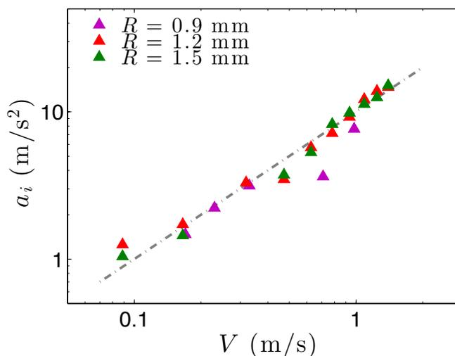
FIGURE 3.4 – Accélération initiale  $a_i$  d'une goutte de viscosité  $\eta = 100$  mPa.s posée sur une surface superhydrophobe en fonction de la vitesse  $V$  du substrat, pour trois rayons  $R$  de gouttes. La ligne en pointillés gris montre la pente 1.
