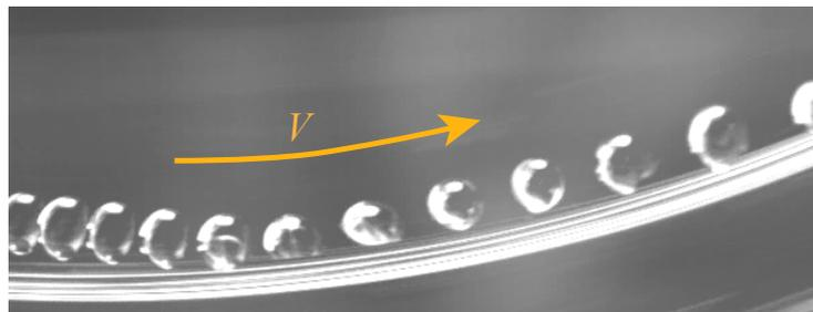
FIGURE 2.14 – Vue de dessus d'une goutte d'huile silicone de rayon  $R = 1,25$  mm rebondissant sur un mur circulaire de 4 mm de hauteur placé au bord du plateau. La flèche orange indique la direction de mouvement du plateau, qui se déplace à une vitesse  $V = 7$  m/s au niveau du mur.
