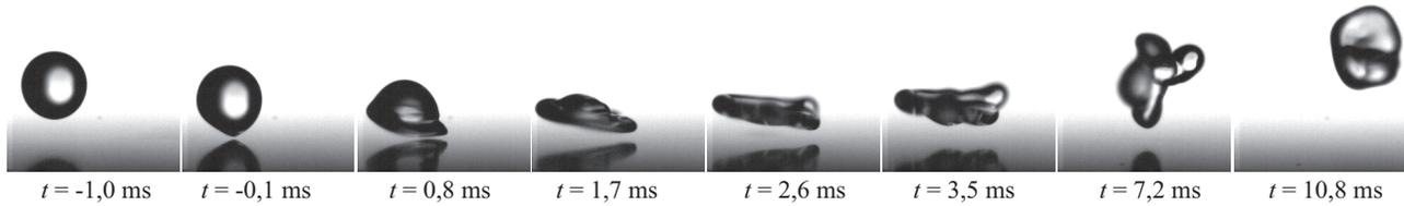
FIGURE 6.1 – Rebond d'une goutte d'éthanol sur un plateau en mouvement de la gauche vers la droite à la vitesse  $V = 29$  m/s. La goutte a un rayon  $R = 0,75$  mm et une vitesse d'impact  $U = 0,4$  m/s. Le temps de rebond  $\tau$ , mesuré entre le moment de l'impact ( $t = 0$ ) et le moment où toute la masse de la goutte s'éloigne de la surface vaut  $\tau = 2,7$  ms.
