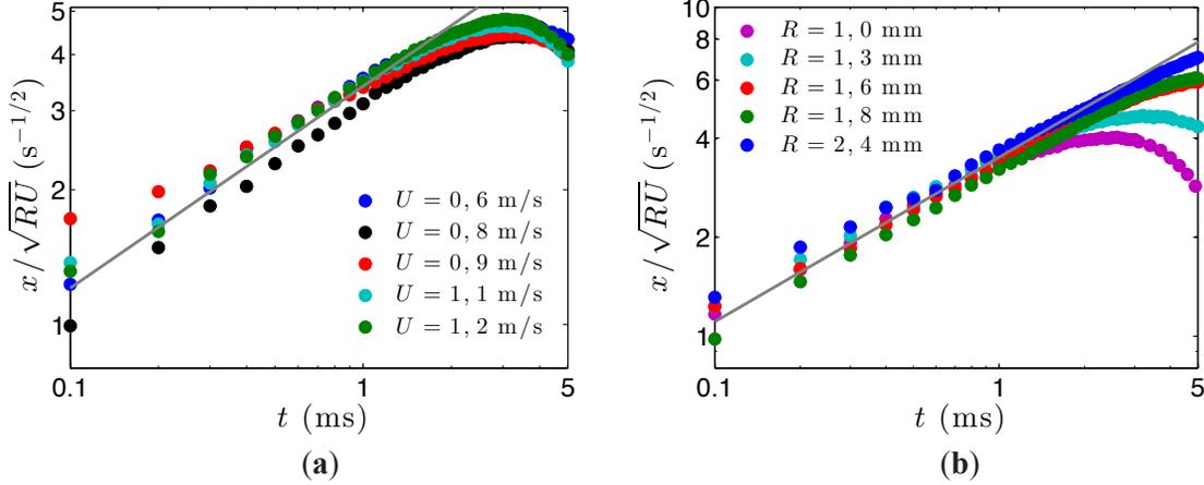
FIGURE 4.8 – Rayon d'étalement sur une surface superhydrophobe  $x$  divisé par la quantité  $\sqrt{RU}$  (en  $\text{m/s}^{1/2}$ ) en fonction du temps  $t$ . Les données sont tracées en échelle logarithmique. **a**  $\frac{x}{\sqrt{RU}} = f(t)$  pour différentes vitesses d'impact  $U$ . La droite grise a une pente  $\alpha = 0,45$ . **b**  $\frac{x}{\sqrt{RU}} = f(t)$  pour différents rayons de gouttes  $R$ . La droite grise a une pente  $\alpha = 0,5$ .
