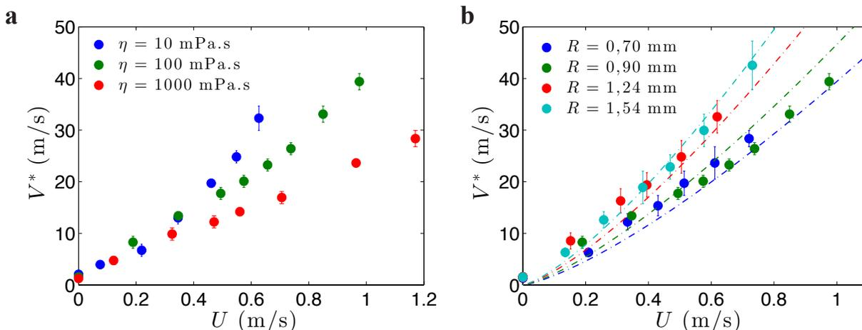
FIGURE 1.18 – Vitesse seuil de rebond en fonction de la vitesse d'impact  $U$  de pour des gouttes d'huile silicone
