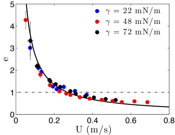
FIGURE 6.13 – Coefficient de restitution  $e = u/U$ , qui compare la vitesse de gouttes avant et après rebond sur une surface en mouvement en fonction de leur vitesse d’impact  $U$ . Trois liquides sont considérés : de l’eau (de tension de surface  $\gamma = 72$  mN/m), de l’éthanol ( $\gamma = 22$  mN/m) et un mélange des deux ( $\gamma = 48$  mN/m). La ligne grise en pointillés trace la limite  $e = 1$  et la ligne noire continue a pour équation  $1/U$ .
