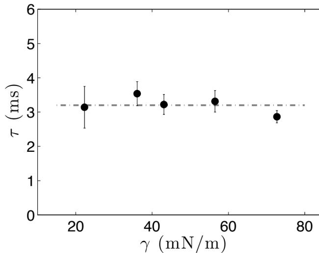
FIGURE 6.8 – Temps de rebond  $\tau$  en fonction de la tension de surface  $\gamma$  de gouttes formées d'un mélange d'eau et d'éthanol. Le rayon  $R$  des gouttes vaut  $R = 1,05 \pm 0,05$  mm et leur vitesse d'impact  $U = 0,25$  m/s. Le plateau se déplace à une vitesse  $V = 25$  m/s.
