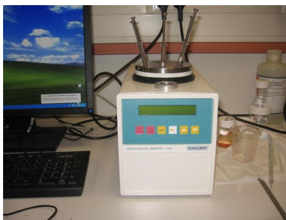
Figure 17 : Photographie de l'osmomètre à pression de vapeur utilisé
