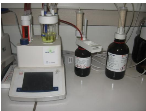
Figure 36 : Photographie de l'appareil de Karl-Fischer utilisé
