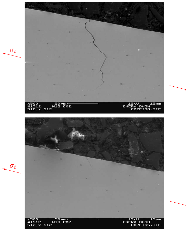
FIG. 4.15. Fissures non-critiques dans le fût de l'éprouvette C02 testée en fatigue répétée à 0,7% en amplitude de déformation. La microstructure de cette éprouvette contient des \gamma' tertiaires plus fins que ceux de la microstructure standard (MEB).
