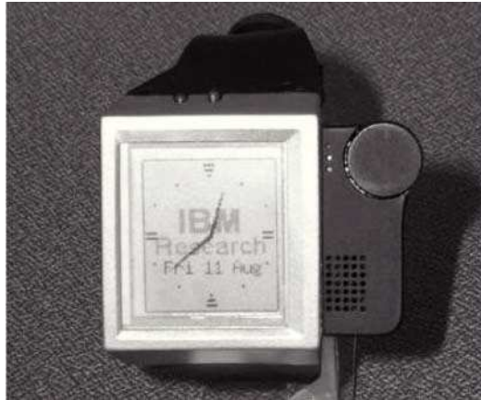
FIGURE 1.2 – La montre IBM embarque un système d’exploitation Linux en 2001.
