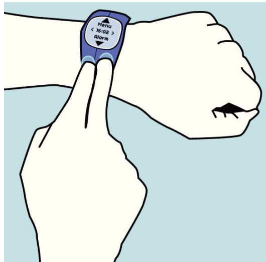
FIGURE 8.29 – Illustration d'un geste de glissement à 2 contacts simultanés sur le bracelet interne.
