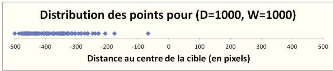
FIGURE 2.4 – Exemple d’une distribution de mouvements pour une tâche extrêmement facile de paramètres D=1000 pixels et W=1000 pixels ( ID de Shannon = 1 bit).
