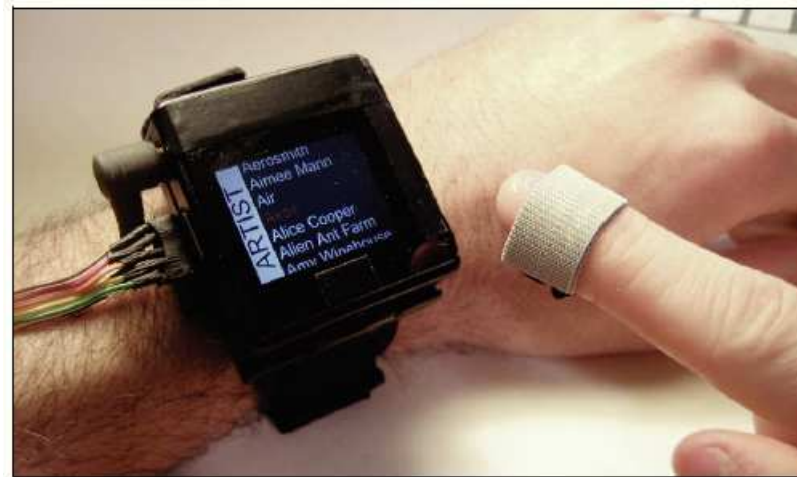
FIGURE 8.8 – Abracadabra détecte la position de l’aimant fixé sur le doigt de l’utilisateur grâce à un magnétomètre.
