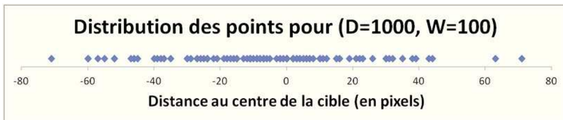
FIGURE 2.3 – Exemple de distribution de mouvements pour une tâche de difficulté moyenne où D=1000 pixels et W=100 pixels ( ID de Shannon = 3,46 bits). Les valeurs négatives sont des under-shoots.
