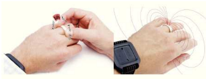
FIGURE 8.5 – L'anneau interactif Nenya. L'interaction se fait grâce à l'aimant situé sur l'anneau, et dont les mouvements sont captés par un magnétomètre dans le bracelet.
