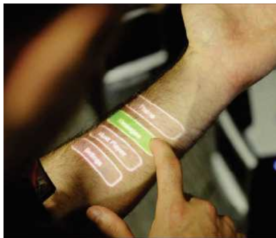
FIGURE 7.18 – Avec Skinput (Harrison et al., 2010), un menu est projeté sur le bras de l'utilisateur. En effectuant un "tap" sur un élément, il peut le sélectionner facilement.
