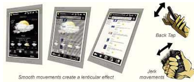
FIGURE 7.13 – TimeTilt (Roudaut et al. , 2009a) détecte l'inclinaison du téléphone pour basculer d'une application à l'autre.
