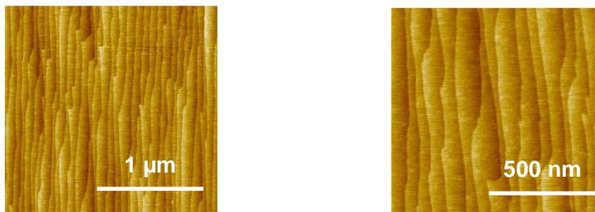
*Figure 54 : Images AFM d'une surface 100% acide, préparée par voie thermique et rincée à l'acide acétique, selon la procédure habituelle.*
