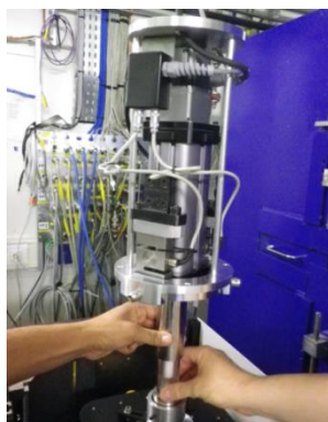
Figure 19. Machine in-situ du laboratoire Navier montée sur la platine de rotation de la ligne BM05.
