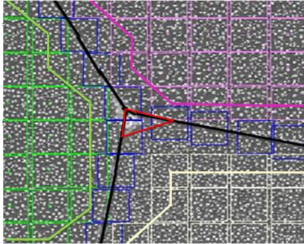
Figure 12. Point triple défini par trois grains. La zone représentée par le triangle rouge au point triple du grain est incluse dans l'estimation de \underline{\underline{\Delta F}} donnée par la méthode 1. Les contours des grains utilisés pour calculer les gradients moyens "sans interface" sont représentés en couleur dans chaque grain.
