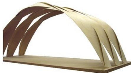
**Figure C.1 - Tressage de poutres anisotropes**
