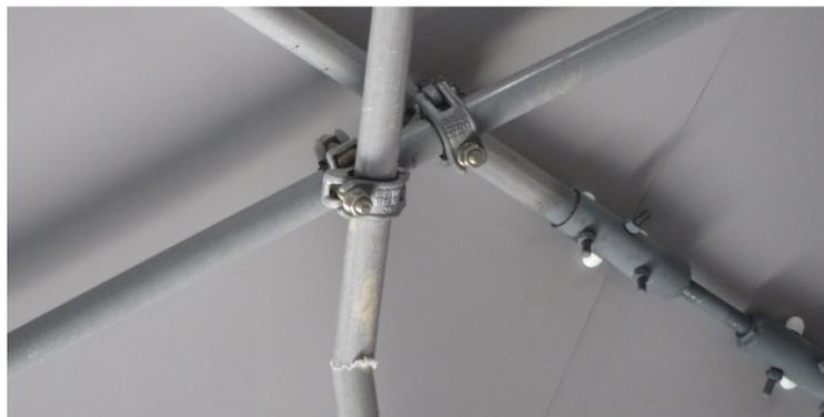
**Figure 4.6 - Rupture observée sur une poutre du gridshell de Créteil**
