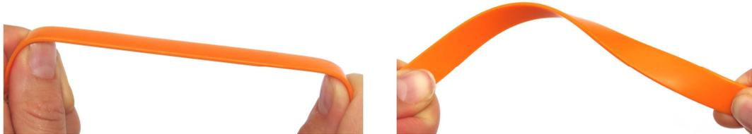
**Figure 4.7 - Illustration des comportements d'une poutre élancée**
