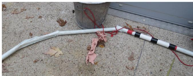
**Figure 2.58 - Endommagement de la poutre raboutée**
