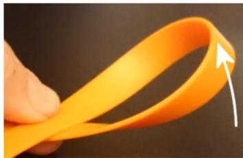
**Figure 4.1 - Exemple de déformation de poutre à section rectangulaire**
