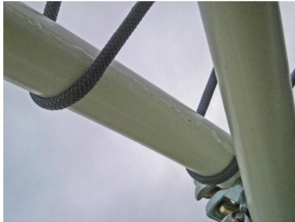
**Figure 2.38 - Endommagement d'une rive située au niveau d'une porte**
