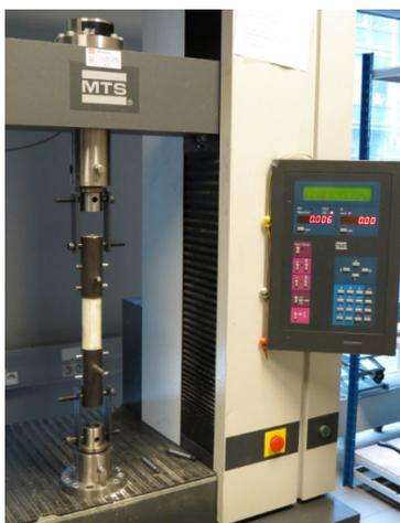
**Figure 2.53 - Montage à trois goupilles en phase de tests**
