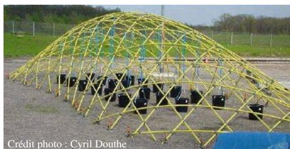
**Figure 2.17 - Chargement du prototype de gridshell**
