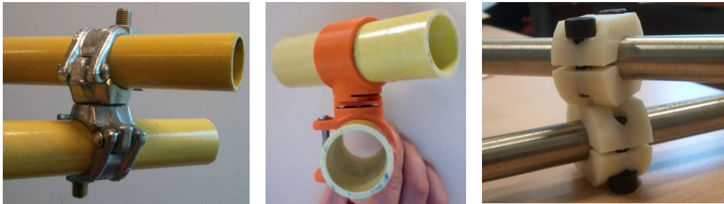
Figure 2.13 - noix de connexions laissant libre le degré de liberté en cisaillement
