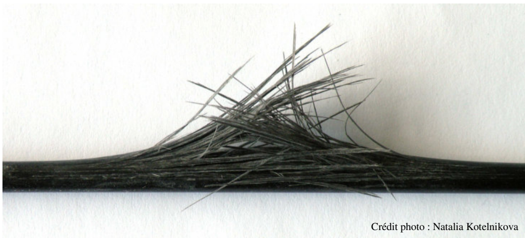
Figure 4.4 - Mode de rupture différée en flexion permanente
