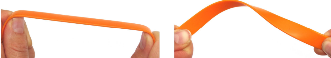
Figure 4.7 - Illustration des comportements d'une poutre élancée
