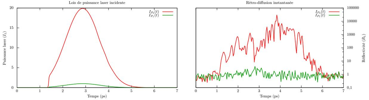
FIGURE 6.12 – Lois laser et réflectivités associées. L'impulsion  $P_0$ , au dessus du seuil de déclenchement de l'instabilité, produit une réflectivité importante, tandis que l'impulsion  $P_1$  ne permet pas au couplage Raman de se développer : la réflectivité reste celle associée au bruit.
