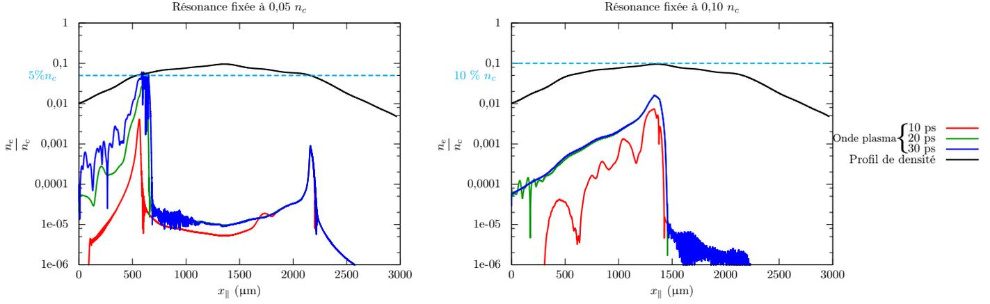
FIGURE 6.4 – Évolution des ondes plasma électroniques pour différents accords avec prise en compte des effets non linéaires cinétiques.
