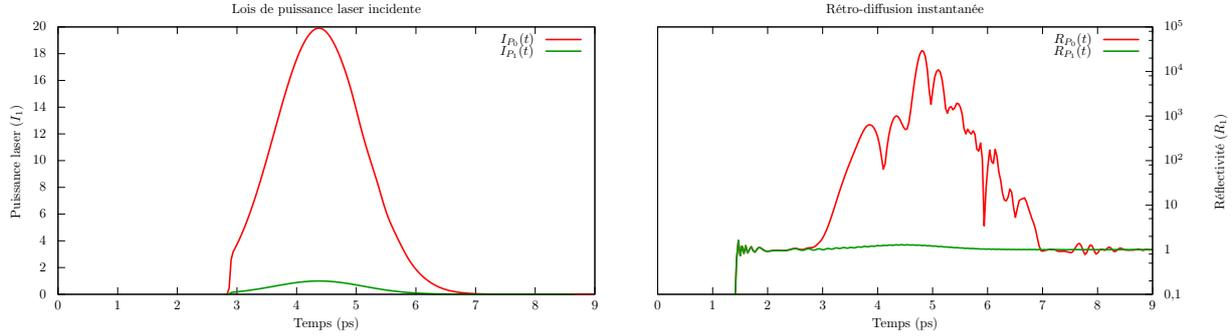
FIGURE 6.9 – Lois laser et réflectivités associées. L’impulsion  $P_0$ , au dessus du seuil de déclenchement de l’instabilité, produit une réflectivité importante, tandis que l’impulsion  $P_1$  ne permet pas au couplage Raman de se développer : la réflectivité reste celle associée au germe.
