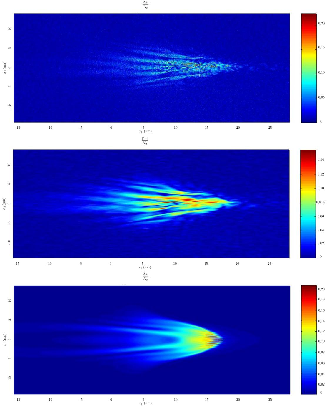
FIGURE 5.10 – Champ calculé par EM2D de  $\left| \frac{\delta n_e}{N_0} \right|$  à  $6400\omega_0 t = 1,17$  ps, pour le cas  $L_\nabla = 75,75 \mu\text{m}$ . Haut : données PIC. Milieu : enveloppe extraite. Bas : SIERA. L'extension spatiale du signal est assez bien reproduite, ainsi que l'arrière du signal, notamment avec le même nombre de filaments : 7. L'avant est un peu moins bien traité, notamment la forme du front moins pointue. Les filaments commencent à se casser pour former des îlots.
