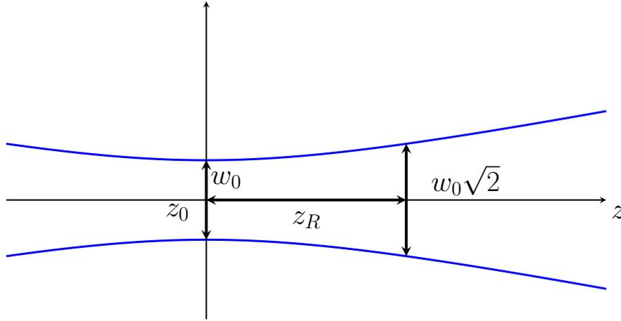
FIGURE 1.3 – Schéma d'un faisceau gaussien sur lequel nous présentons les différents paramètres. Pour  $z \gg z_R$ , il est courant de considérer la pente de l'élargissement du faisceau comme constante.
