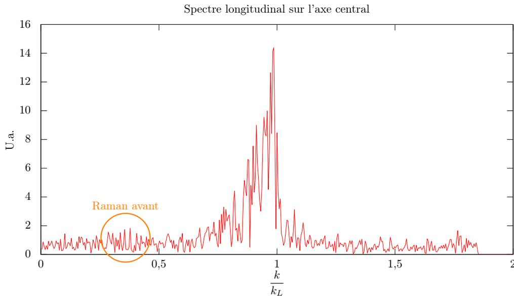
FIGURE 5.8 – Nous représentons ici le spectre associé au signal présenté en figure 5.7. Bien que la fréquence dominante soit celle associée à la diffusion Raman ( $k = k_L$ ), il y a néanmoins une certaine largeur autour de ce mode. Une multitude d’autres modes sont également présents. Par exemple, nous identifions autour de  $\frac{k}{k_L} = 0,4$ , le mode associé au « Raman avant ».
