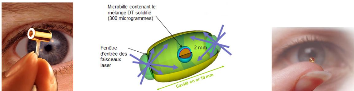
FIGURE 1.1 – Images issues de [6] et [7]. À gauche, une photographie d'une cavité NIF. Au milieu, un schéma d'une cavité et d'une cible LMJ. À droite, une cible – capsule ou microballon – de deutérium-tritium NIF.
