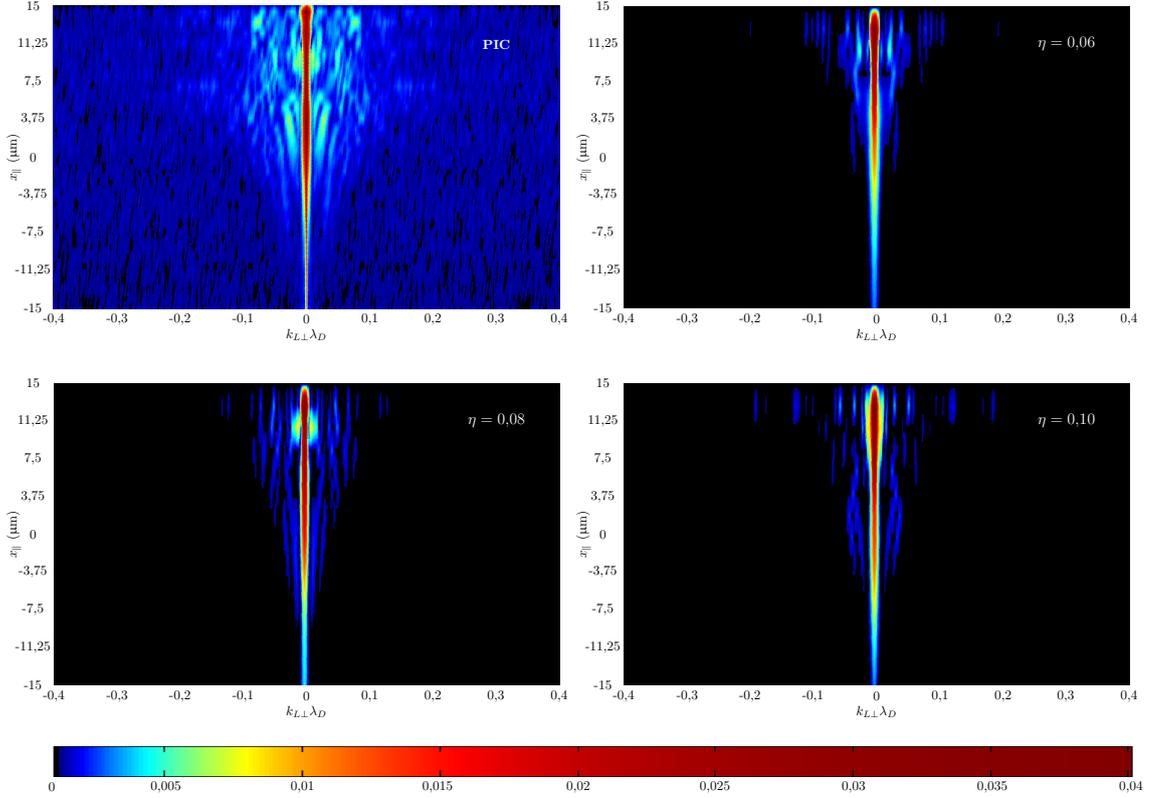
FIGURE 5.15 – Comparaison de spectres transverses autour du point de résonance. Nous représentons les spectres transverses (abscisses) pour l’ensemble des points situés jusqu’à  $15 \mu\text{m}$  de part et d’autre de la résonance (ordonnées). Nous voyons très clairement sur cette figure, qui complète la figure 5.14, que l’allure globale du cas  $\eta = 0,08$  est la plus proche de celle relative à la simulation PIC.
