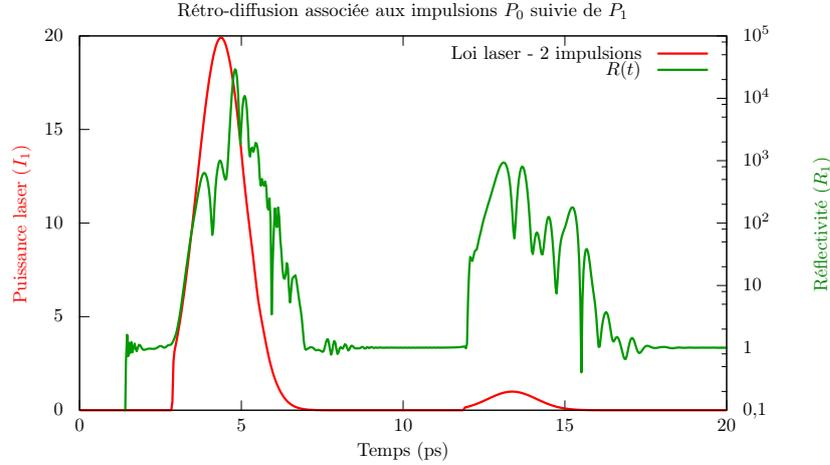
FIGURE 6.10 – En rouge nous représentons la loi laser totale. Les deux impulsions sont envoyées à environ 9 ps d’intervalle (crête à crête), ce qui laisse le temps à la première de s’évacuer totalement du système avant que la seconde n’y entre. En vert, nous représentons la réflectivité instantanée associée à cette loi laser. Il est très clair que la réflectivité associée à l’impulsion faible est beaucoup plus importante qu’en régime isolé (un facteur 1 000).
