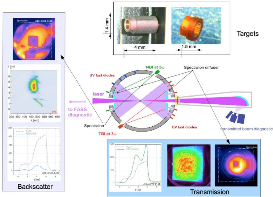
FIGURE 6.1 – Diagnostics LIL et cibles. Issu de [81]. Les diagnostics présents permettent de mesurer les caractéristiques de la lumière rétro-diffusée (spectres Raman et puissance rétro-diffusée notamment).
