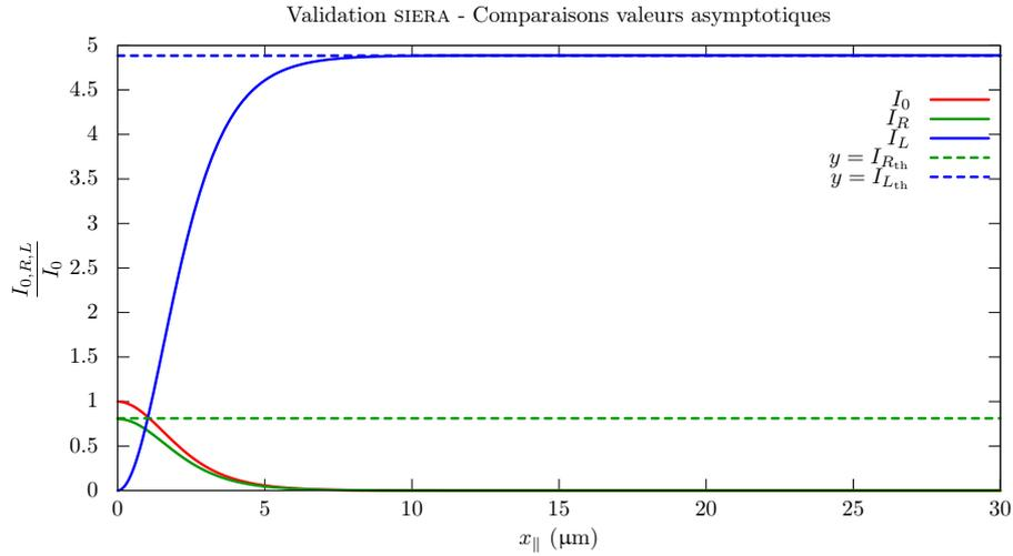
FIGURE 4.4 – Même test que celui relatif à la figure 4.3, effectué avec un maillage 10 fois plus fin ( $\Delta x = 0,1\lambda_0$ ). La précision obtenue est proche de 100%. Cependant, le gain de précision obtenu n'est pas spécialement rentable compte tenu du coût supplémentaire en temps de calcul que cela représente.
