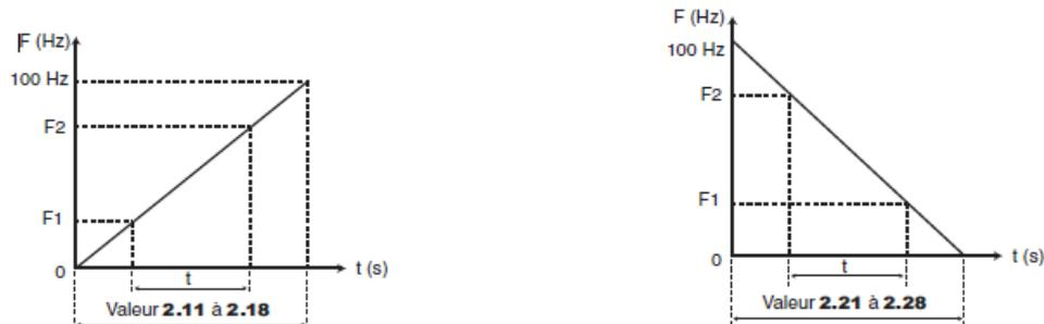
Figure 34- Rampe d'accélération et de décélération du variateur de vitesse (DIGIDRIVE-SK, 2008)
