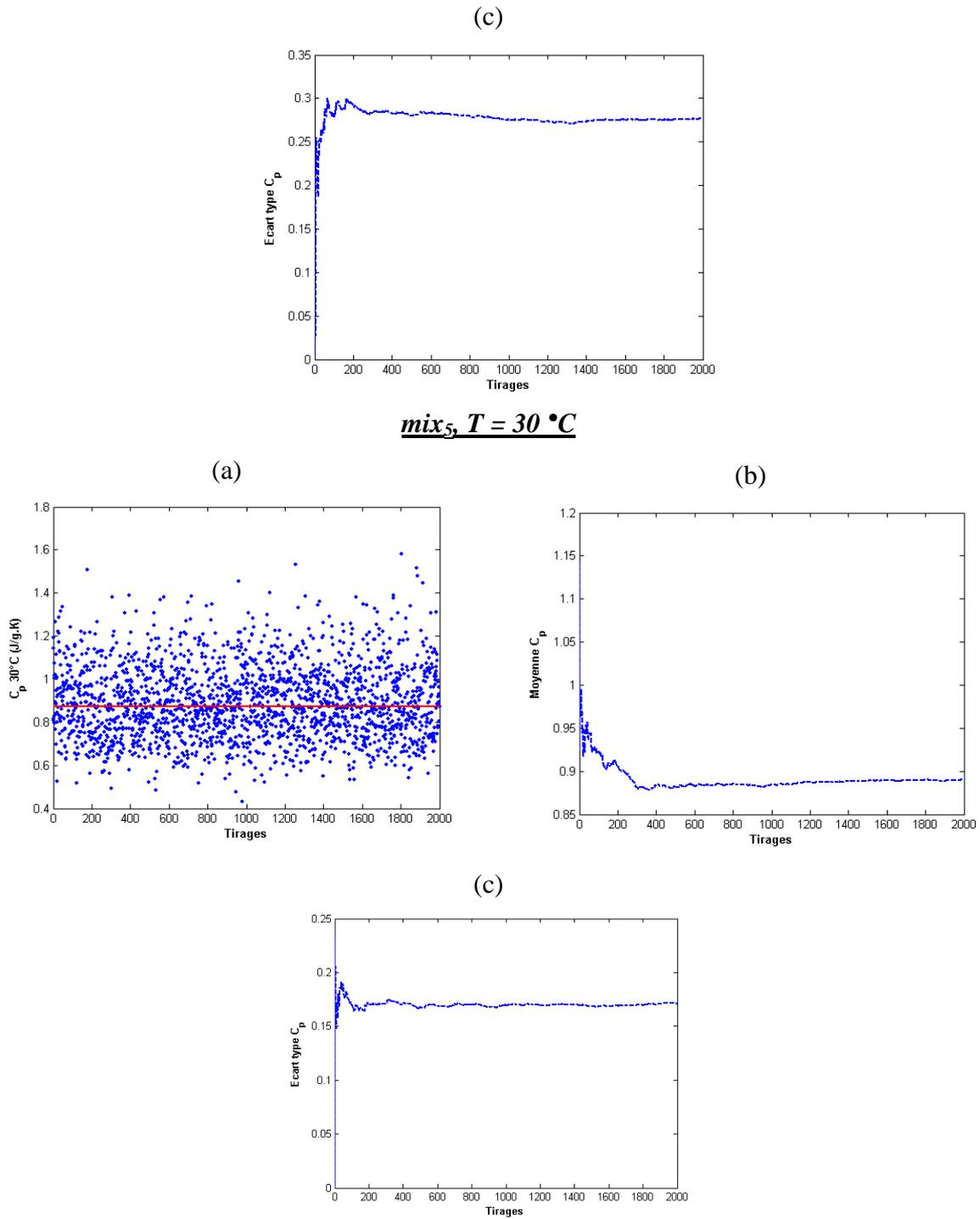
**Figure. 1 :** Différentes réalisations aléatoire selon la pdf ((a)) et simulation Monte Carlo ( (b) et (c)) de la chaleur spécifique des bétons  $mix_1$  et  $mix_5$  avant vieillissement à  $T = 10\text{ }^\circ\text{C}$  et  $T = 30\text{ }^\circ\text{C}$ .
