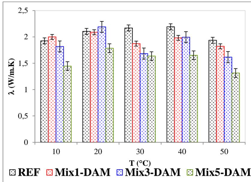
**Figure 1.** Conductivité thermique des bétons-DAM mesurées après vieillissement.
