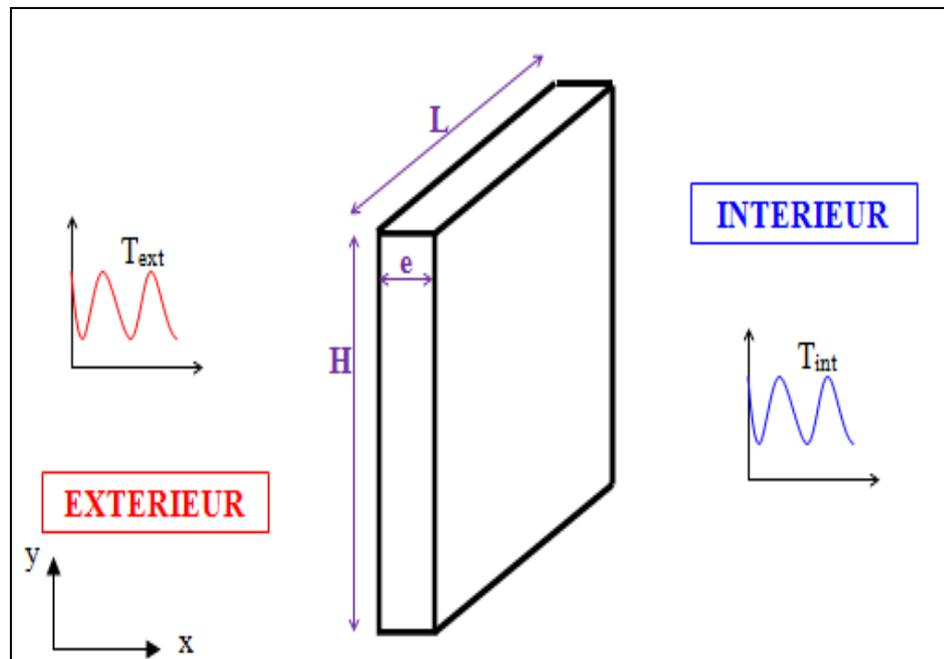
**Figure 5. 1 :** *Modèle géométrique avec conditions aux limites.*
