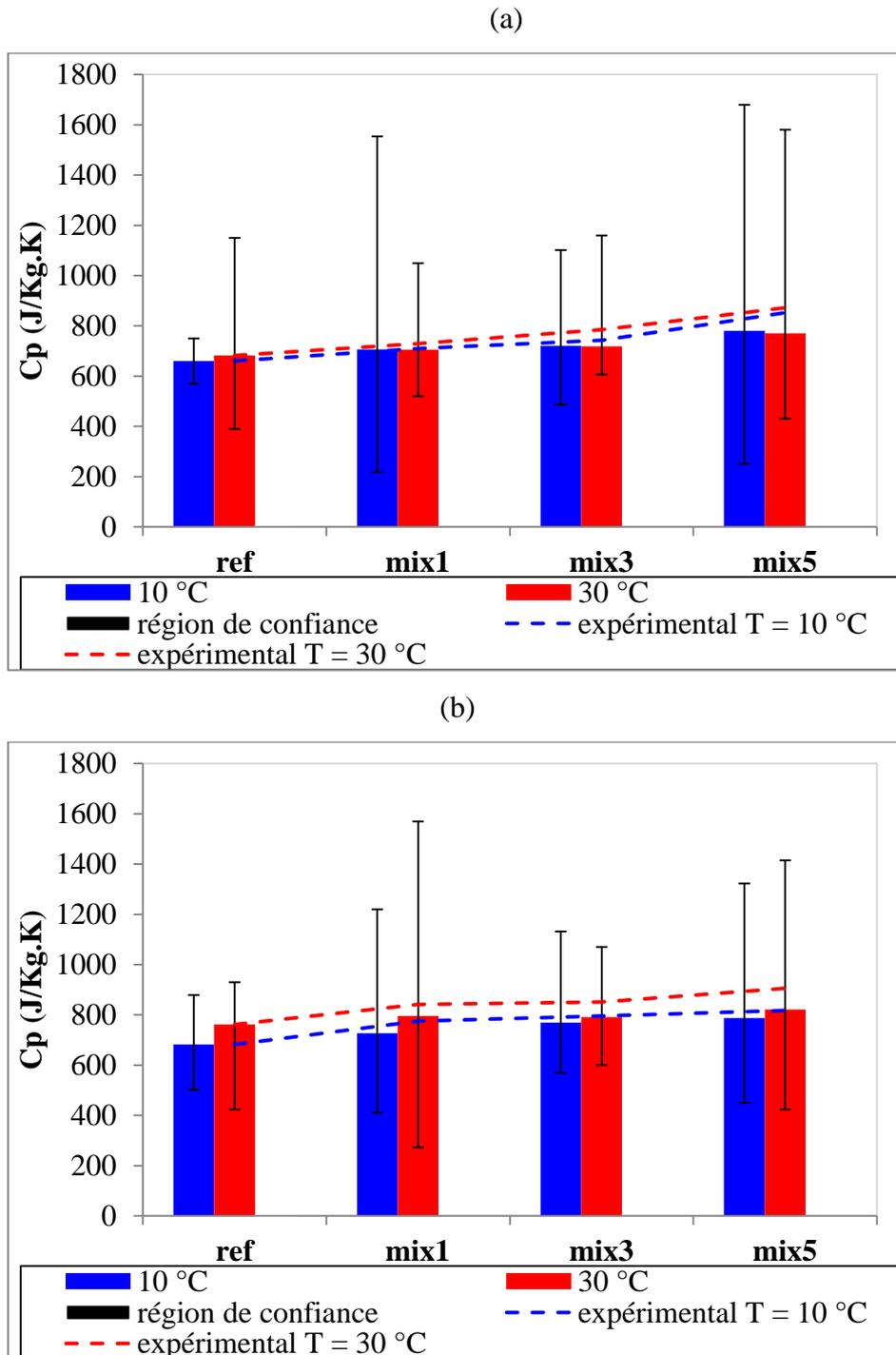
**Figure 4. 8 :** *Chaleur spécifique des différents bétons-NAT étudiés calculée théoriquement en comparaison avec le modèle micro-macro et les régions de confiance : (a)avant vieillissement, (b) après vieillissement.*
