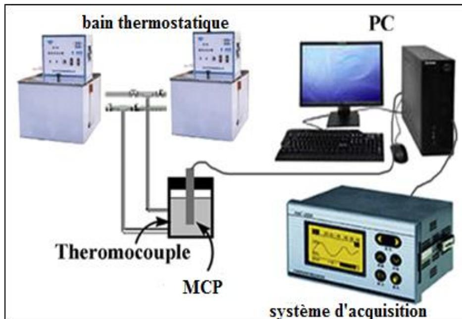
**Figure 1. 15 :** *Dispositif expérimental utilisé pour les essais de cycles thermiques ([Hawlder, 2003 \[47\]](#)).*
