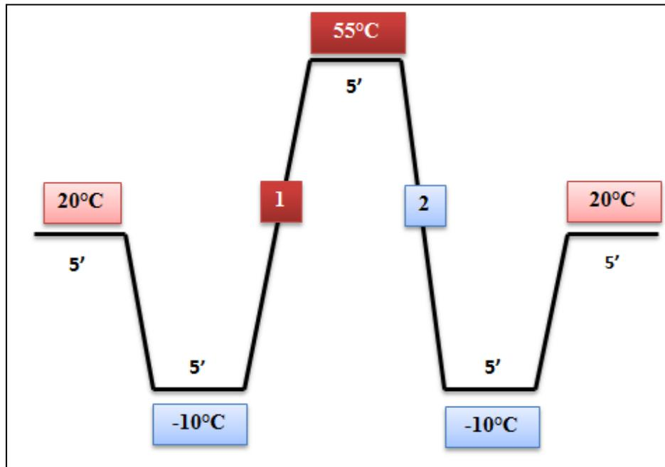
**Figure 2. 8 :** Programme d'essai DSC (1 : segment endothermique, 2 : segment exothermique) [67].
