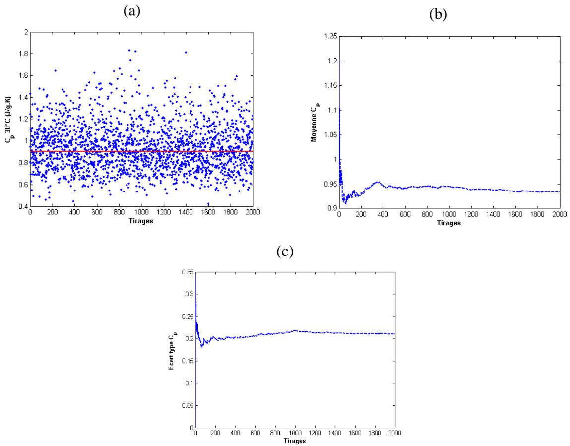
**Figure. 2 :** Différentes réalisations aléatoire selon la pdf ((a)) et simulation Monte Carlo ( (b) et (c)) de la chaleur spécifique des bétons  $mix_1$  et  $mix_5$  après vieillissement à  $T = 10\text{ °C}$  et  $T = 30\text{ °C}$ .
