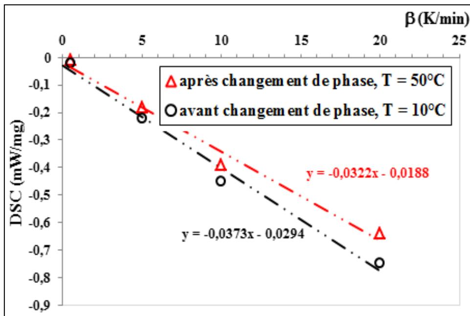
**Figure 2. 21 :** Evolution des flux de chaleur des MCP-NAT en fonction de la cinétique de chauffe, à  $T = 10^\circ\text{C}$  (cercle noir) et à  $T = 50^\circ\text{C}$  (triangle rouge),  $m = 12\text{mg}$ .
