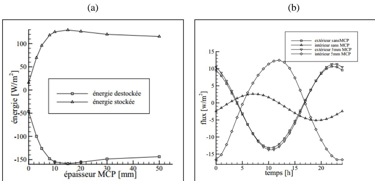
**Figure 1. 24 :** (a) *Energie stockée/déstockée en fonction de l'épaisseur des MCP* (b) *Energie stockée par une plaque avec MCP et par une plaque sans MCP* (Kuznik et al, [61]).
