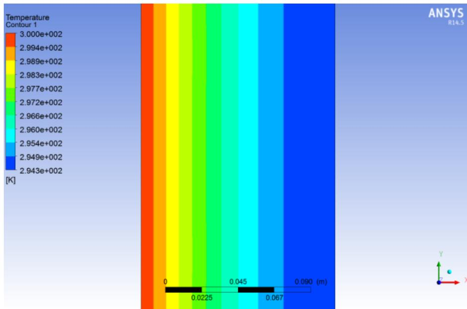
**Figure 5. 13 :** Evolution de la température dans la paroi Mix3 ( $T_{ext} = 27^{\circ}C$ ).
