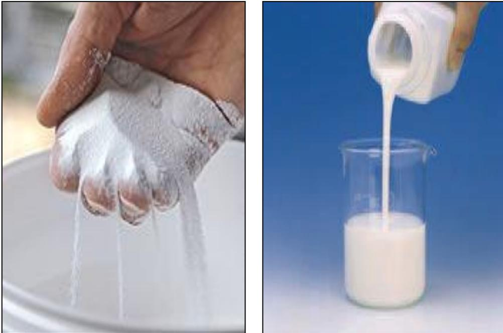
**Figure 1. 9 :** Exemple des MCP micro-encapsulés : à l'état poudre et à l'état liquide (BASF [41]).
