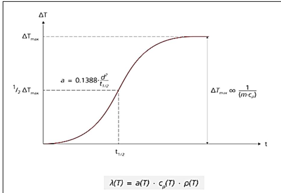
**Figure 2. 12 :** Exemple de signal enregistré par LFA (NETZSCH, [85]).
