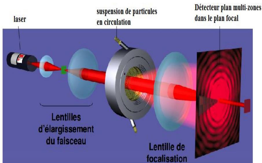
**Figure 2. 2 :** Principe de mesure (Anglaret, [106]).
