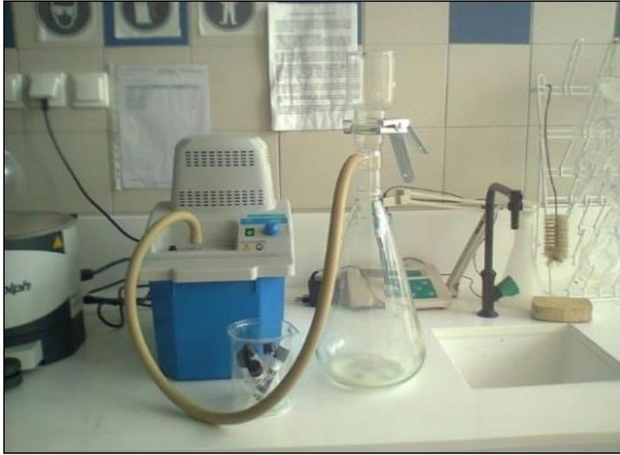
**Figure 2. 5 :** *Dispositif expérimental utilisé pour filtrer les MCP.*
