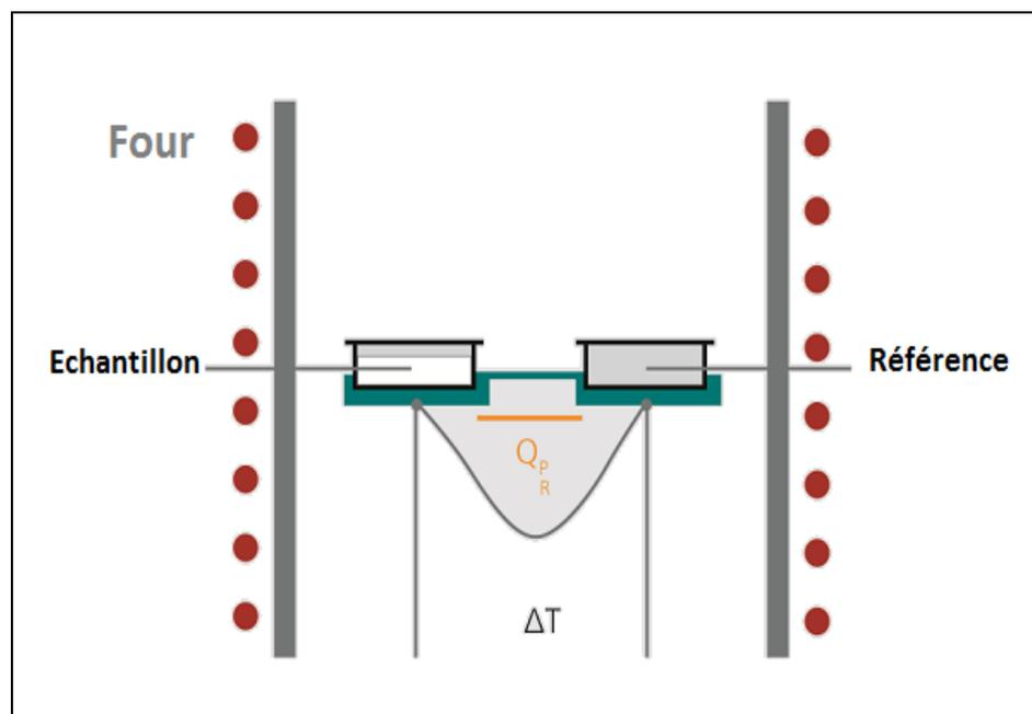
Figure 2. 7 : Schéma descriptif de la DSC [26].
