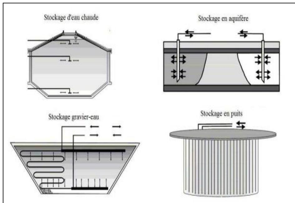
**Figure 1. 4 :** Différents types de stockage souterrain par chaleur sensible (Hongois, S, 2011 [14]).
