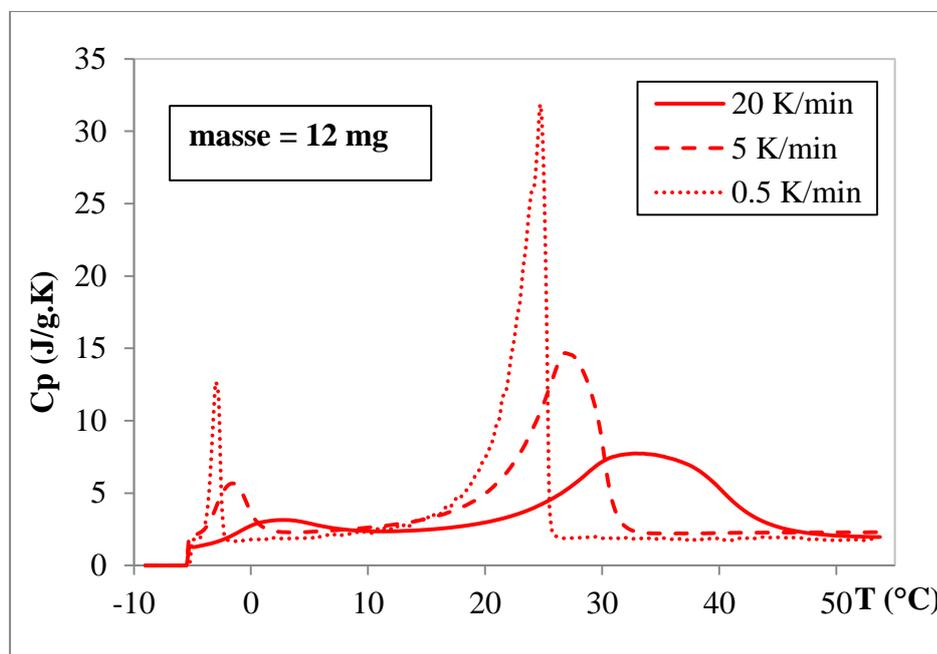
**Figure 2. 23 :** Evolution de la chaleur spécifique en mode endothermique des MCP-Nat en fonction de la température mesurée par la DSC,  $m = 12 \text{ mg}$ .
