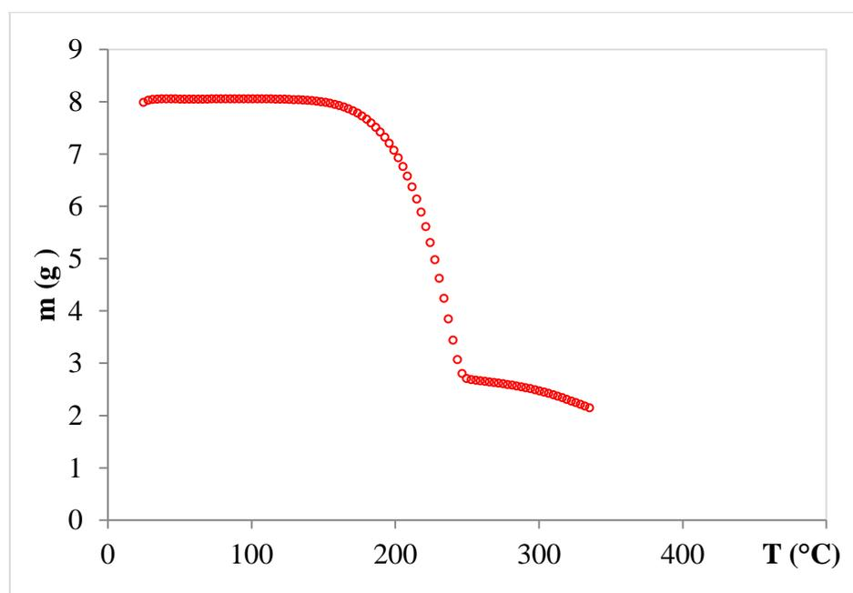
**Figure 2. 18 :** *Thermographe des MCP.*
