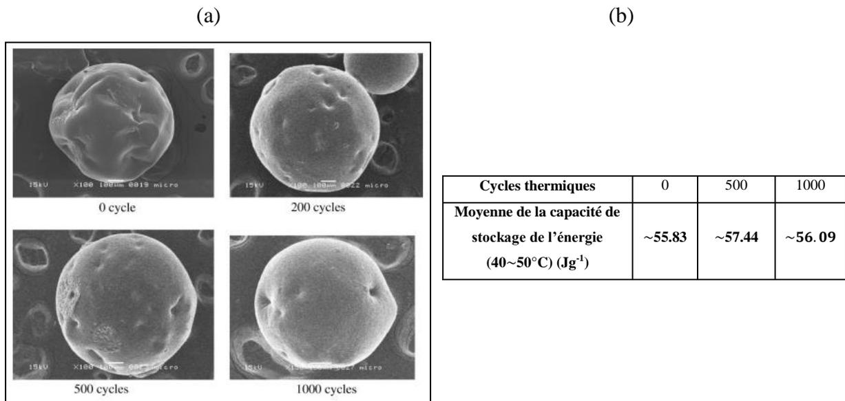
**Figure 1. 16 :** *Propriétés thermophysiques des MCP après applications des cycles thermiques déterminées expérimentalement en utilisant le microscope électronique à balayage (a) et la DSC (b) (Hawalder, 2002 [48]).*
