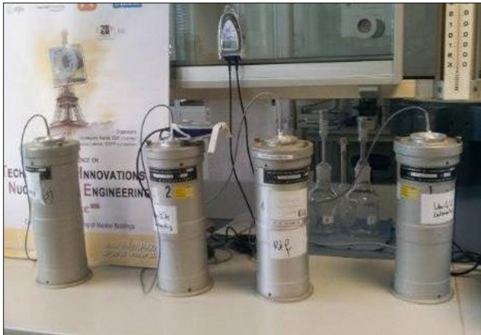
**Figure 3. 1 :** Boîtes à mortiers de Langavant.
