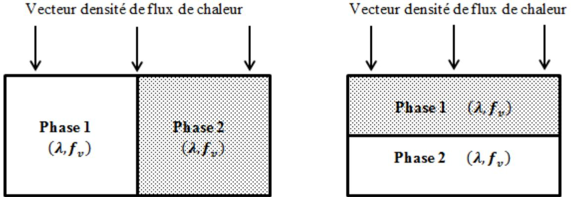
**Figure 4. 1 :** Modèles série (Droite) et parallèle (Gauche).
