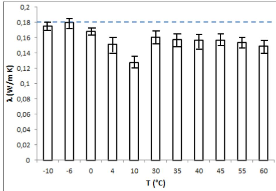
**Figure 2. 26 :** *Conductivité thermique des MCP-NAT.*
