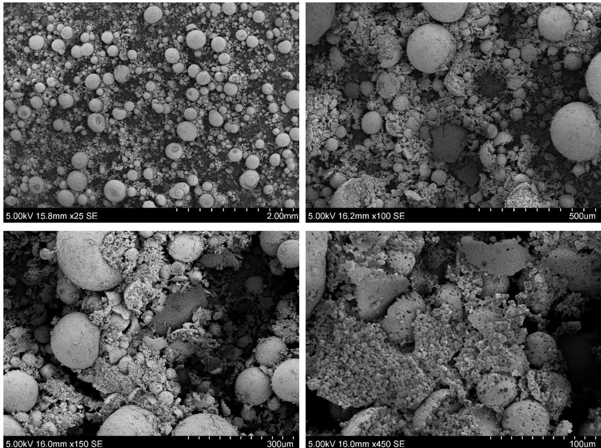
**Figure 2. 14 :** *Observation microscopique des MCP-DAM à différents grossissements.*
