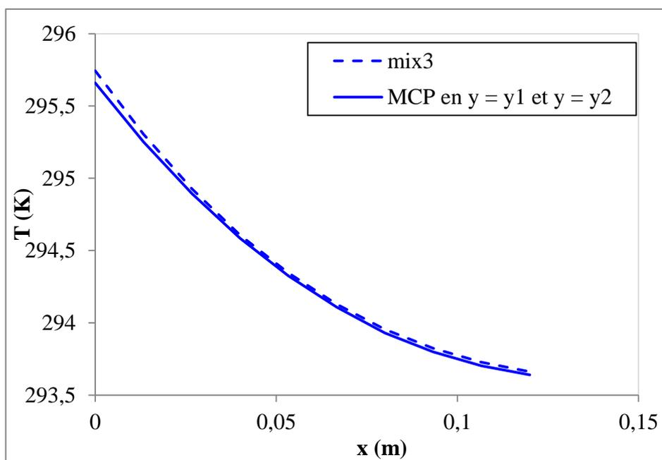
**Figure 5. 24 :** Evolution de la température dans la paroi en fonction de la position de la paroi bicouche : couche MCP en  $y = y1$  et  $y = y2$  (courbe continue bleue) en comparaison avec la paroi de référence (courbe noire) et la paroi mix 3 (courbe en pointillé).
