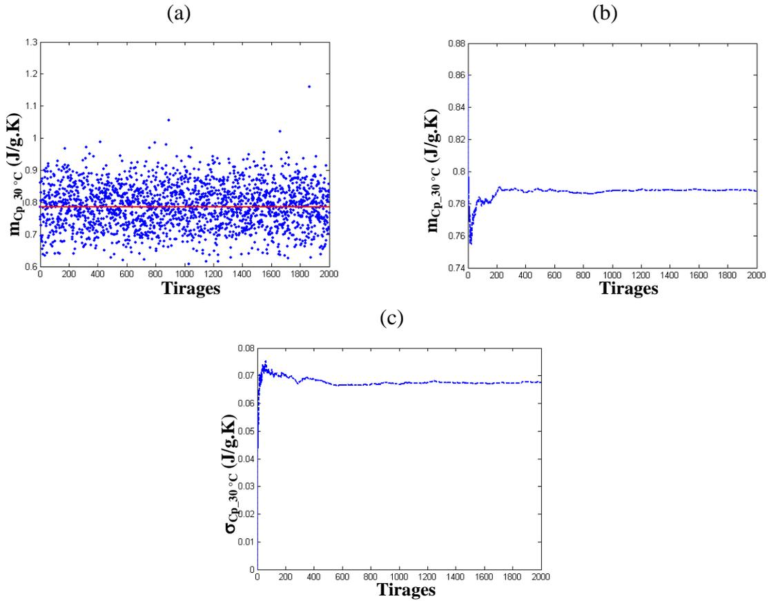
**Figure 4.5 :** *Différentes réalisations aléatoire selon la pdf ((a)) et simulation Monte Carlo ( (b) et (c)) de la chaleur spécifique des bétons de référence et des bétons mix 3 avant vieillissement à T = 10 °C et T = 30 °C.*
