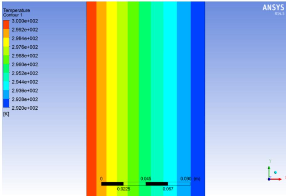
**Figure 5.5 :** Evolution de la température dans la paroi mix 3 ( $T_{ext}=300$  K).
