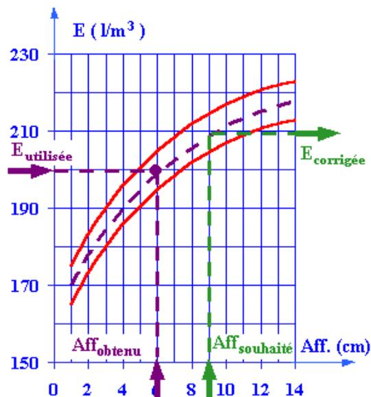
Figure 3. Correction de la quantité d'eau en fonction de l'affaissement de béton
