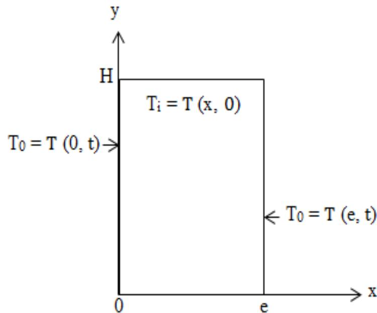
**Figure 5. 3 :** *Transfert de chaleur par conduction à travers un mur simple [118].*
