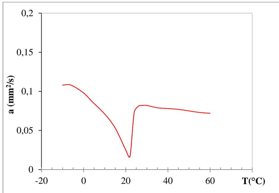
**Figure 2. 25 :** *Diffusivité thermique des MCP-NAT.*
