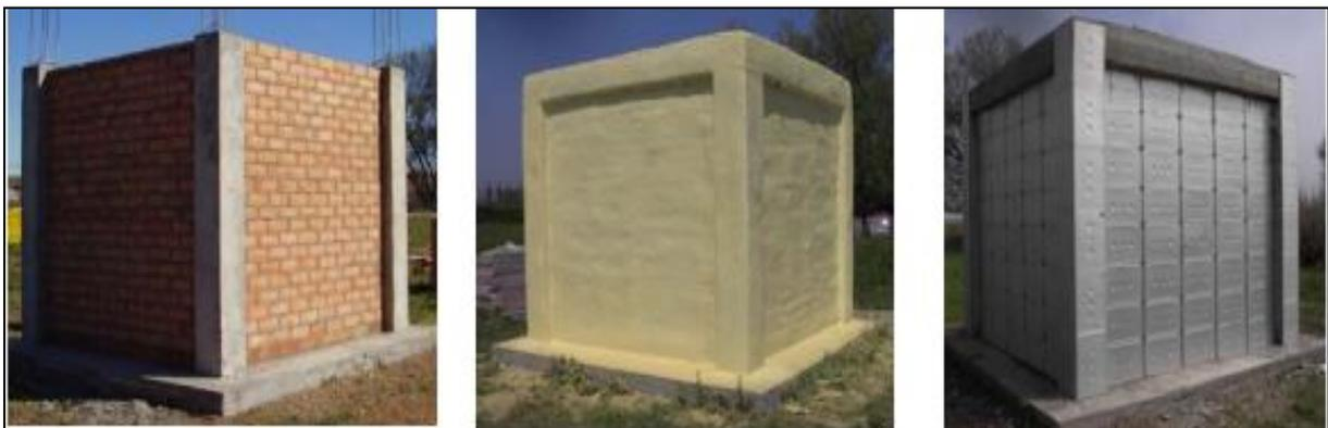
**Figure 1. 30 :** Cellules tests en brique ordinaire. (a) : cellule témoin. (b) : cellule test (PU) en utilisant un isolant. (c) : cellule test (PU-RT27) modifié avec des MCP (*Castell et al, [49]*).
