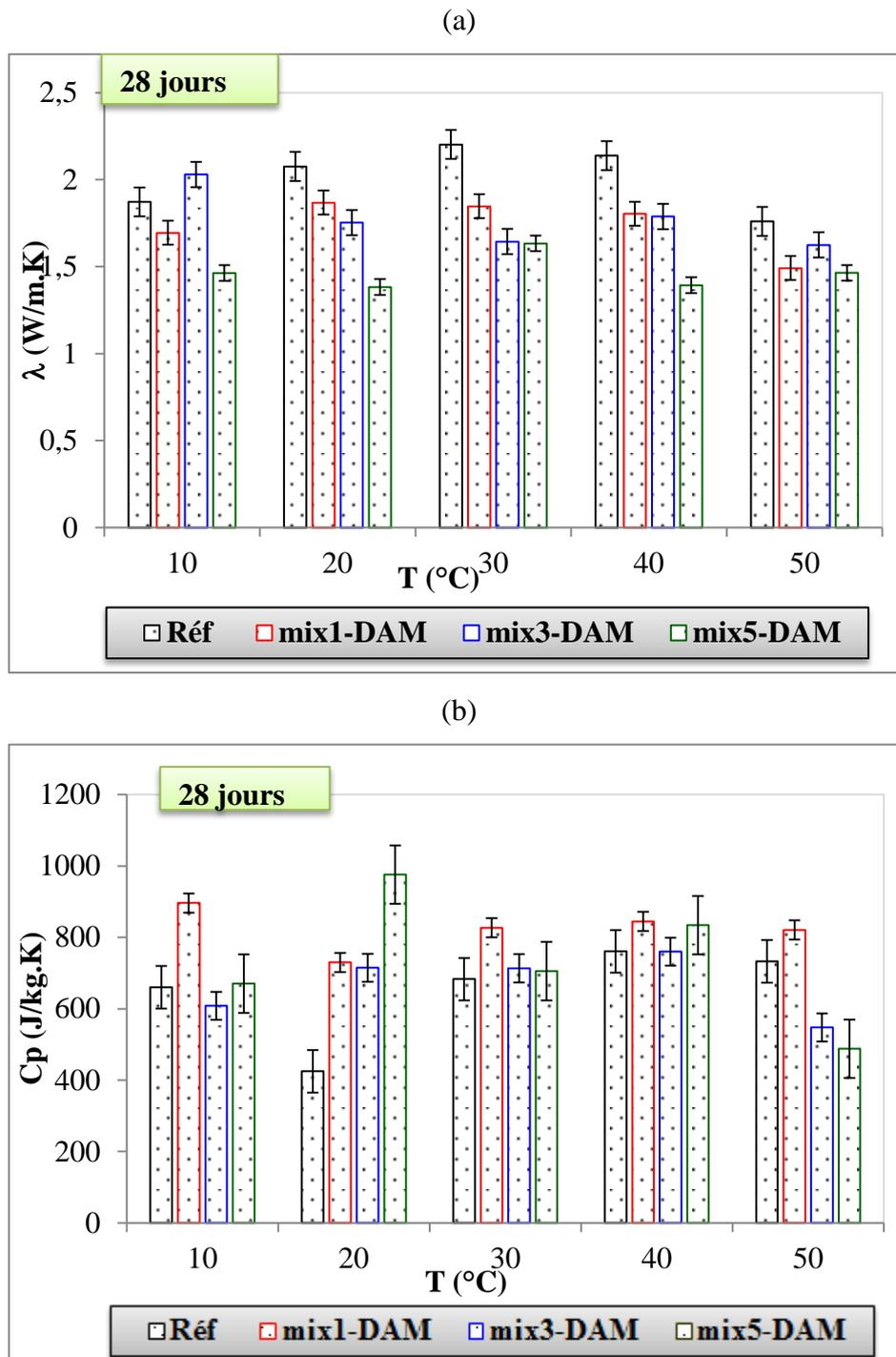
**Figure 3.17 :** Propriétés thermiques des bétons-DAM mesurée avant vieillissement : (a) conductivité thermique, (b) chaleur spécifique.
