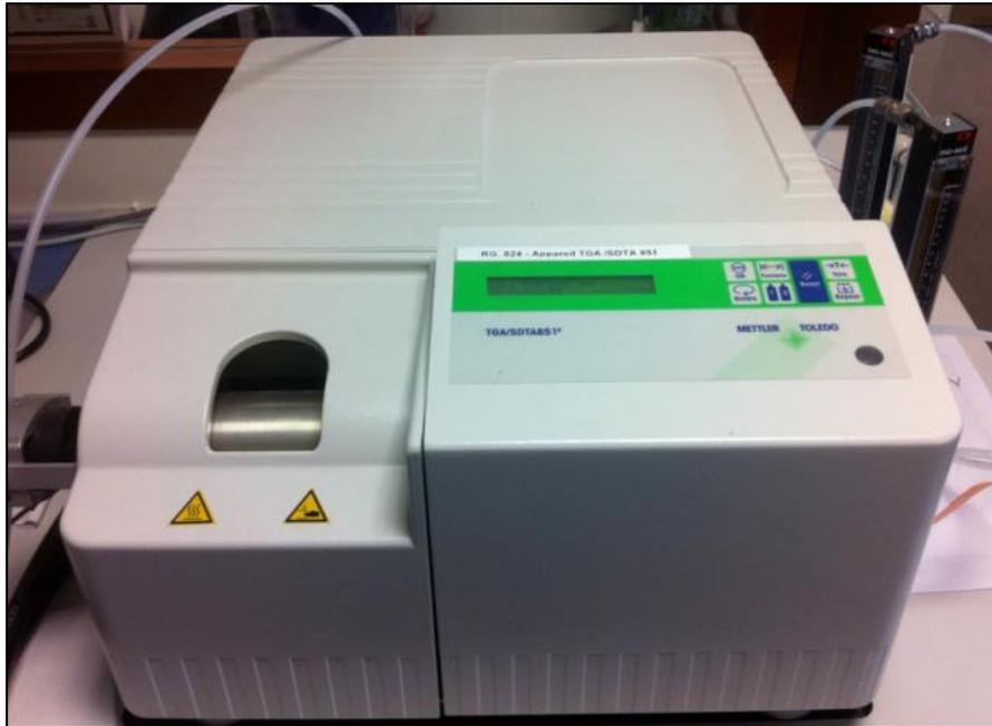
**Figure 2. 6 :** *Dispositif expérimental l'ATG (METTLER, TGA/SDTA 851®).*
