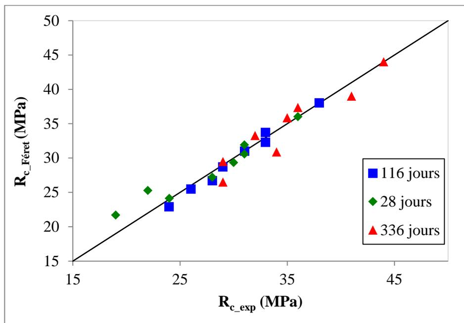
**Figure 3.14 :** Résistance à la compression des bétons étudiés déterminées en utilisant la loi de Féret en fonction des résistances à la compression mesurées expérimentalement à différentes échéances.
