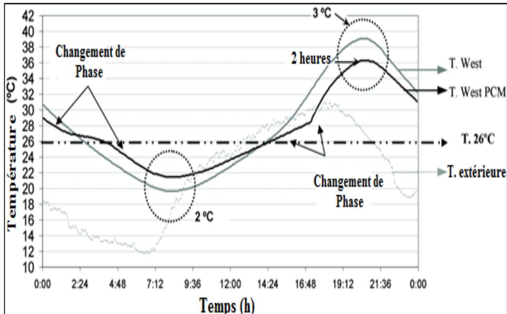
**Figure 1. 28 :** Comparaison entre la température extérieure et la température du mur West de la cellule-MCP (*castellon et al, [63]*).
