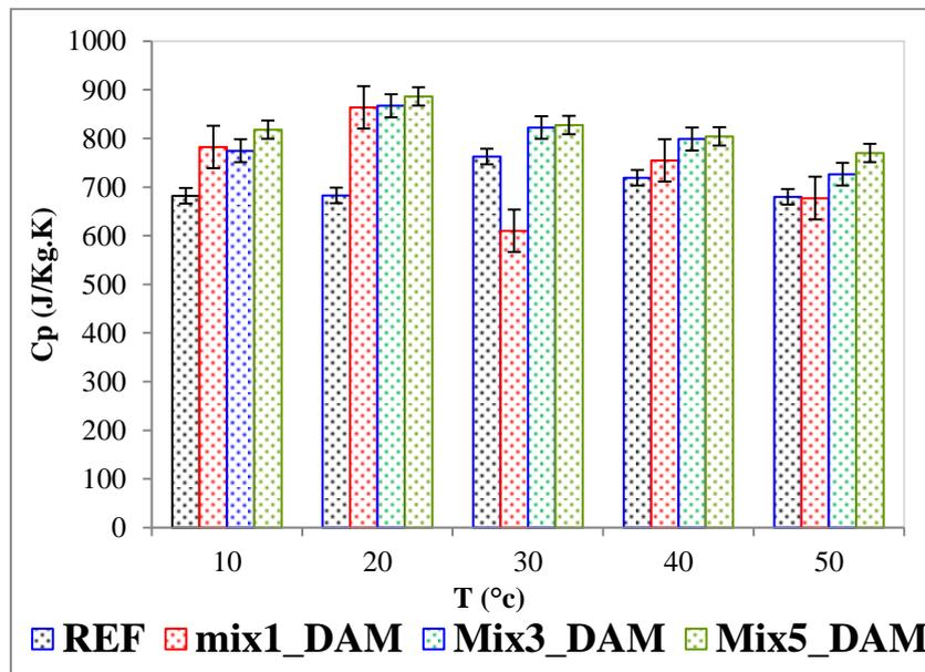
**Figure 2.** Chaleur spécifique des bétons-DAM mesurées après vieillissement.
