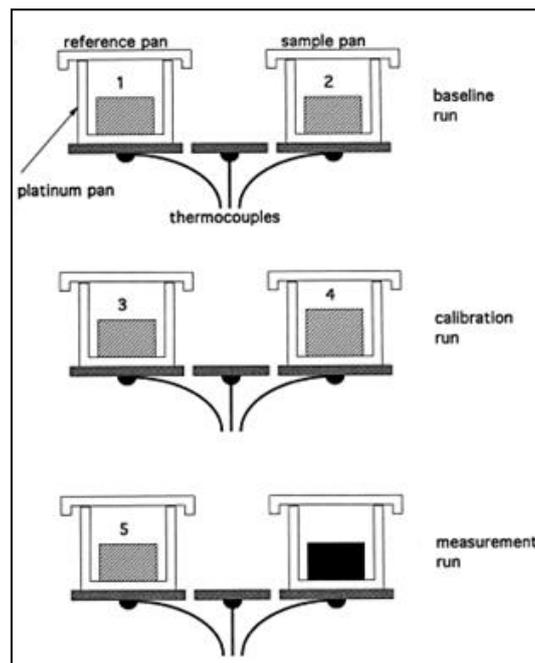
**Figure 2. 10 :** Principe de mesure de la chaleur spécifique [26].
