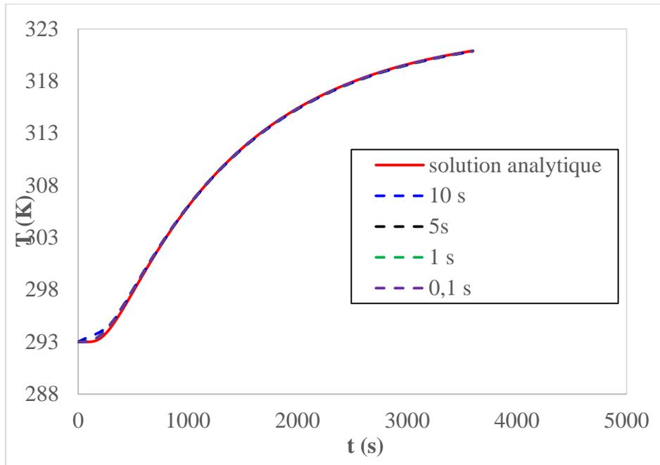
**Figure 5. 4 :** Comparaison du modèle numérique et la solution analytique (a : Différents maillages 100, 625, 2500, 10000, 22500 et 250000 éléments,  $\Delta t = 1$  s, b : Différents pas de temps : 10s, 5s, 1s et 0.1 s,  $\Delta x = e/10$  ).
