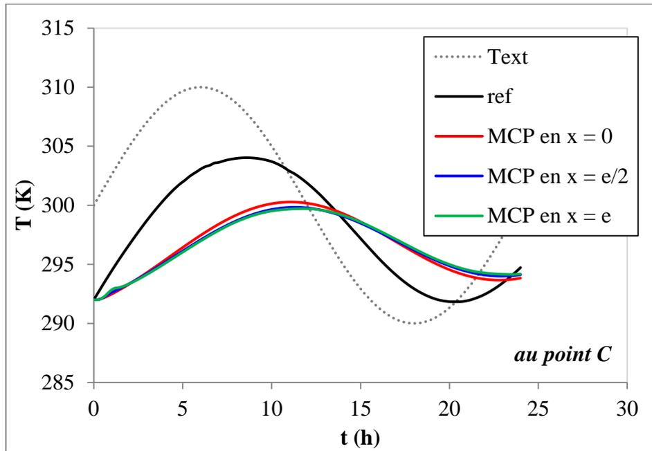
**Figure 5. 21 :** Evolution de la température dans la paroi en fonction du temps de la paroi bicouche : couche MCP en  $x = 0$  (courbe rouge) couche MCP en  $x = e/2$  (courbe bleue) et couche MCP en  $x = e$  (courbe verte) en comparaison avec la paroi de référence (courbe noire) et la paroi mix 3 (courbe en pointillé) au point : (a) A, (b) B et (c) C.
