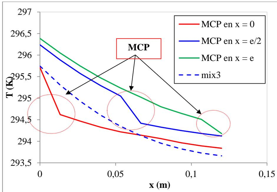
**Figure 5. 20 :** Evolution de la température dans la paroi en fonction de la position de la couche MCP en  $x = 0$  (courbe rouge); en  $x = e/2$  (courbe continue bleue); en  $x = e$  (courbe verte) en comparaison avec la paroi de référence (courbe noire) et la paroi mix 3 (courbe en pointillé).
