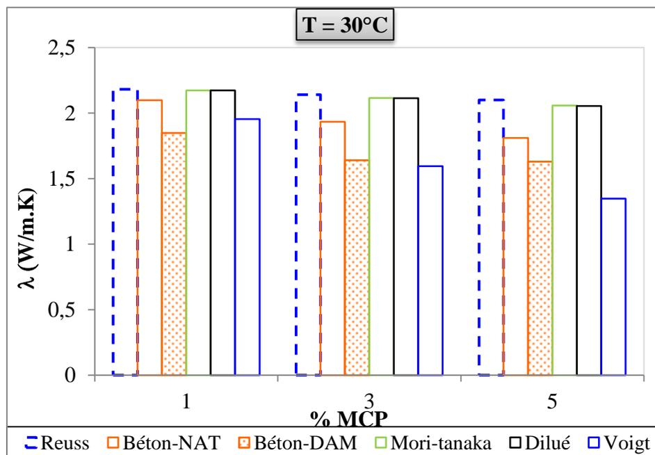
**Figure 4. 2 :** Evolution de la conductivité thermique et calculée par les modèles de Voigt et Reuss, Mori et Tanaka et le schéma dilué en fonction de la teneur en MCP du béton-NAT et DAM (Haut : T= 10 °C, Bas : T = 30 °C).
