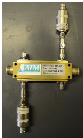
FIGURE 4.2.8 – Coupleur ATM avec atténuateur et diode de détection
