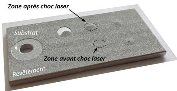
Figure E-2 : Echantillon d'aluminium 2024-T3 revêtu par de l'aluminium pur 1050 et identification des zones irradiées suite aux chocs lasers et celles saines, c'est-à-dire n'ayant subies aucune sollicitation.
