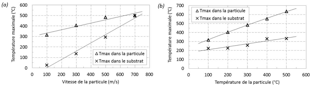
Figure 5-16 : Evolution de la température maximale  $T_{max}$  atteinte dans la particule d'aluminium pur 1050 et dans le substrat d'aluminium 2024-T3 en fonction (a) de la vitesse de la particule et (b) de la température de la particule juste avant l'impact obtenue par la simulation 2D.
