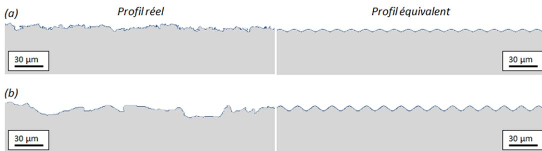
Figure 5-21 : Topographies des substrats rugueux avec les profils réels (à gauche) et équivalents (à droite) et sablés (a) finement et (b) grossièrement.
