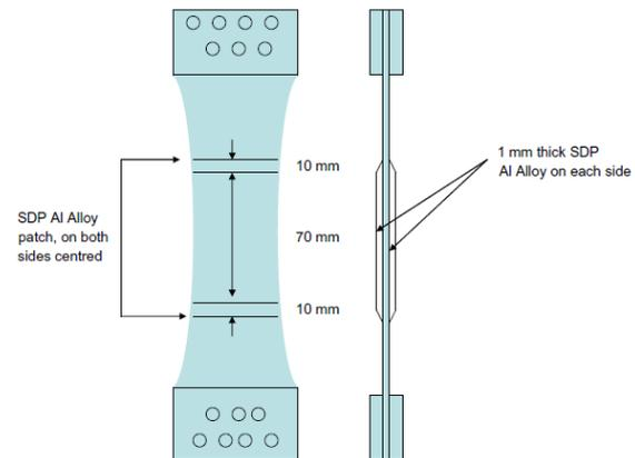
Figure 7-32 : Eprouvettes en aluminium 2024-T3 sollicitées en traction avec l'ajout d'un revêtement d'aluminium élaboré par cold spray [JON11].
