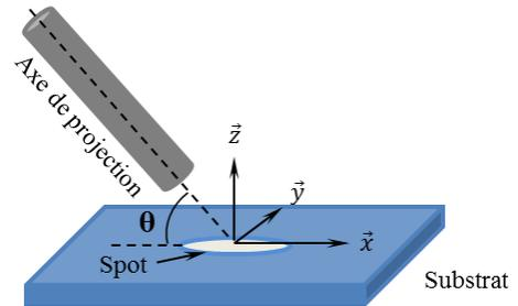
Figure C-1 : Schéma de principe d'une projection inclinée sous un angle  $\theta$  suivant les trois directions de l'espace.
