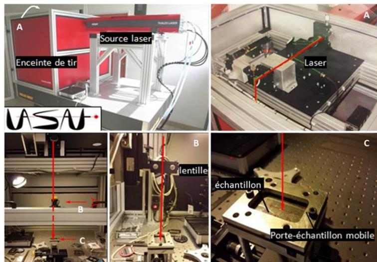
Figure 6-3 : Dispositif expérimental du Centre des Matériaux pour l'essai d'adhérence par choc laser LASAT®.
