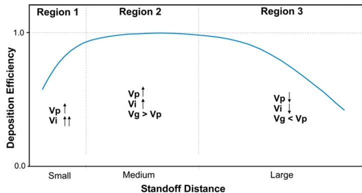
Figure 1-8 : Influence de la distance de projection  $d_p$  sur le rendement de projection, où  $V_i$  est la vitesse d'impact,  $V_p$  la vitesse de la particule et  $V_g$  la vitesse du gaz [PAT08].
