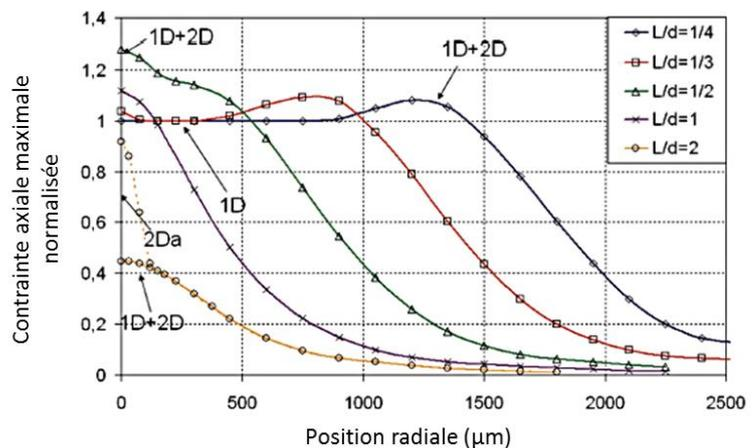
Figure 6-7 : Evolution spatiale de la contrainte maximale appliquée de l'axe vers le bord du choc pour différents rapports  $L/d$  (Matériau : aluminium ;  $L = 1$  mm ; Laser : LULI2000 ;  $\tau = 3$  ns et  $P_{max} = 50$  GPa) [LEL10].
