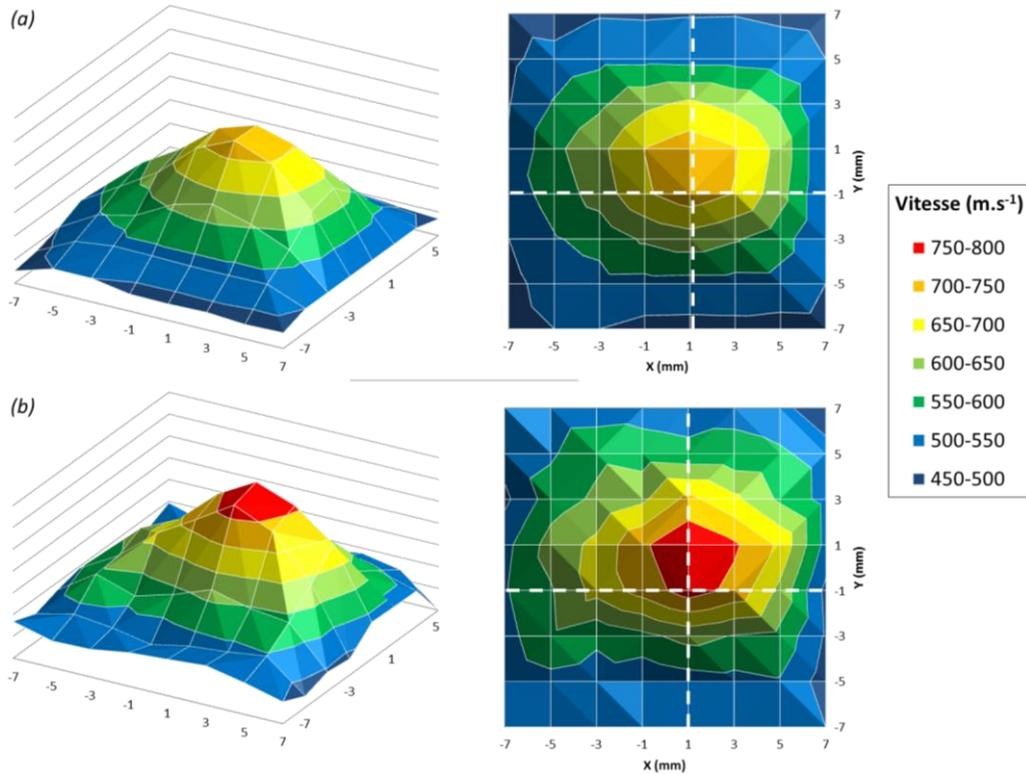
Figure 3-34 : Vue 3D et vue de dessus de la cartographie des vitesses des particules d'aluminium pur (a) 1050 grossières et sphériques (30 μm) et (b) 1070 fines (10 μm) dans un jet cold spray.
