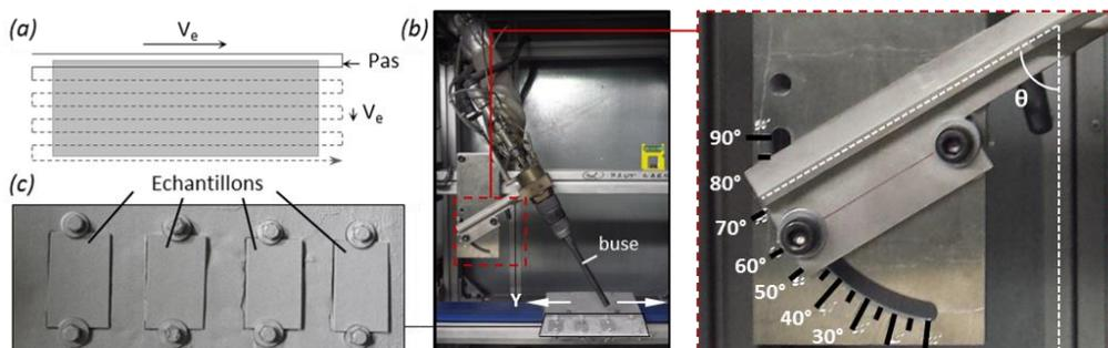
Figure 2-11 : Dispositif expérimental pour une projection inclinée, cas d'un surfaçage : (a) mouvement programmé du porte-échantillons, (b) montage avec variation de l'angle  $\vartheta$  et (c) substrats revêtus.
