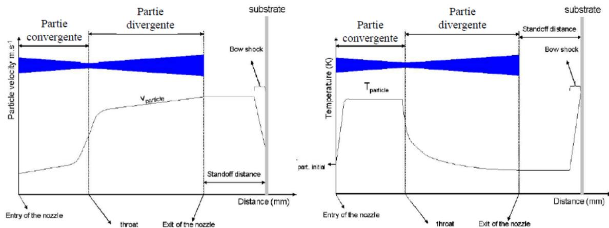
Figure 2-14 : Evolution de la vitesse (à gauche) et de la température (à droite) d'une particule et du gaz depuis son entrée dans la buse de projection jusqu'à son impact à la surface du substrat [KAI07].
