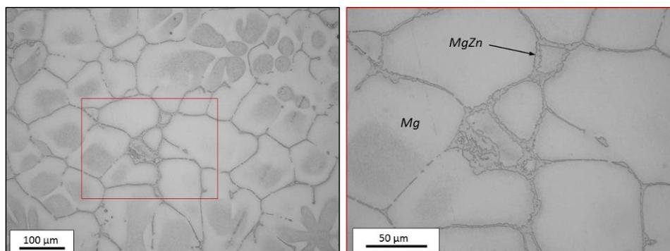
Figure A-12 : Images optiques en coupe de la microstructure du magnésium G-Z4TR, observée après attaque chimique « Keller ».
