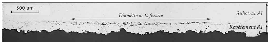
Figure 6-12 : Image en coupe obtenue par microscopie optique de l'interface revêtement d'aluminium pur 1050 – substrat d'aluminium 2024-T3 après un choc laser de  $2 \text{ GW}\cdot\text{cm}^{-2}$  en face arrière.
