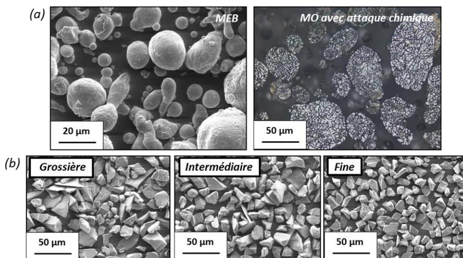
Figure A-6 : (a) Images MEB en électrons secondaires (à gauche) et MO avec attaque chimique « Keller » (à droite) de la poudre d'aluminium 2009 et (b) images MEB en électrons secondaires des poudres de SiC de différents grades : grossière, intermédiaire et fine.
