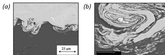
Figure 1-12 : Images EDS en coupe représentant les accrochages mécaniques sous forme de vortex (a) interface Cu/Al [CHA05] et (b) interface Ni/Al [ADJ05], le revêtement respectivement Cu et Ni sur Al apparaissent en clair.
