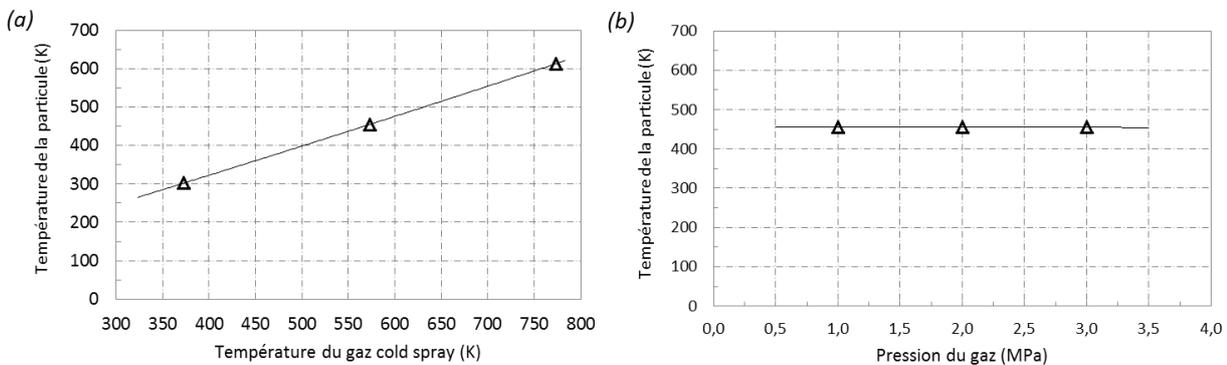
Figure 3-38 : Evolution de la température de la particule (de 20  $\mu\text{m}$  de diamètre) à l'impact en fonction (a) de la température et (b) de la pression du gaz cold spray pour une distance de projection de 30 mm.
