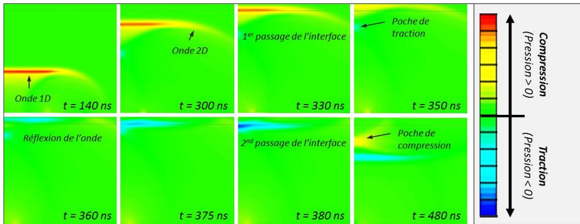
Figure 6-20 : Cartographies temporelles des contraintes des ondes de choc ( $L/d = 0,86$ ) pour un système revêtement d'aluminium pur 1050 d'épaisseur  $150 \mu\text{m}$  sur substrat d'aluminium 2024-T3 d'épaisseur  $2 \text{ mm}$ , pour des temps allant de  $t = 150$  ns à  $t = 450$  ns et un diamètre de choc de  $2,5 \text{ mm}$ .
