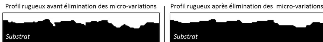
Figure 5-19 : Profil réel du substrat rugueux avant (à gauche) et après (à droite) l'opération morphologique destinée à supprimer les protubérances de la surface.
