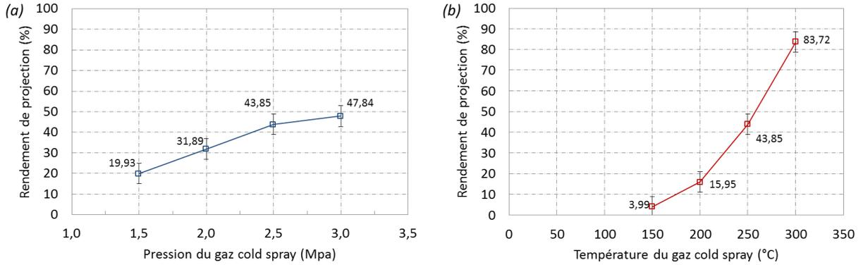
Figure 3-11 : Influence des paramètres de projection (a) pression et (b) température de gaz sur le rendement de d'aluminium pur 1050 déposé par cold spray sur substrat d'aluminium 2024-T3.
