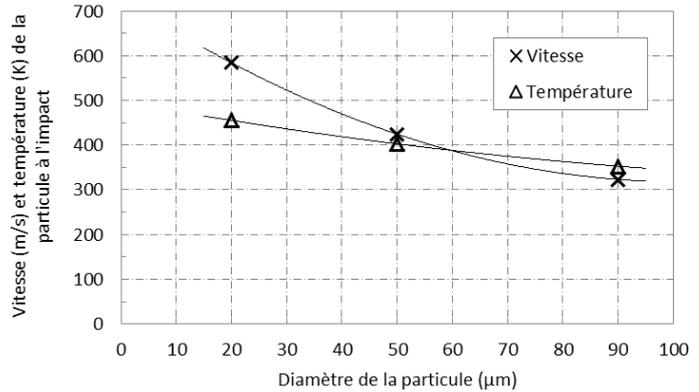
Figure 3-40 : Evolution de la température de la particule à l'impact en fonction de son diamètre pour une pression de gaz de 3 MPa, une température de gaz de 573 K et une distance de projection de 30 mm.
