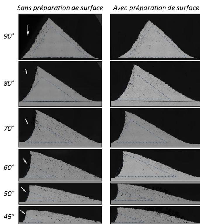
Figure B-7: Images optiques en coupe des cordons de projection élaborés sous différents angles d'incidence sur un substrat sans préparation de surface (à gauche) et pré-sablé (à droite), les flèches blanches indiquent la direction de projection des particules par cold spray, la zone du revêtement la plus dense est délimitée par les lignes en pointillés bleus.
