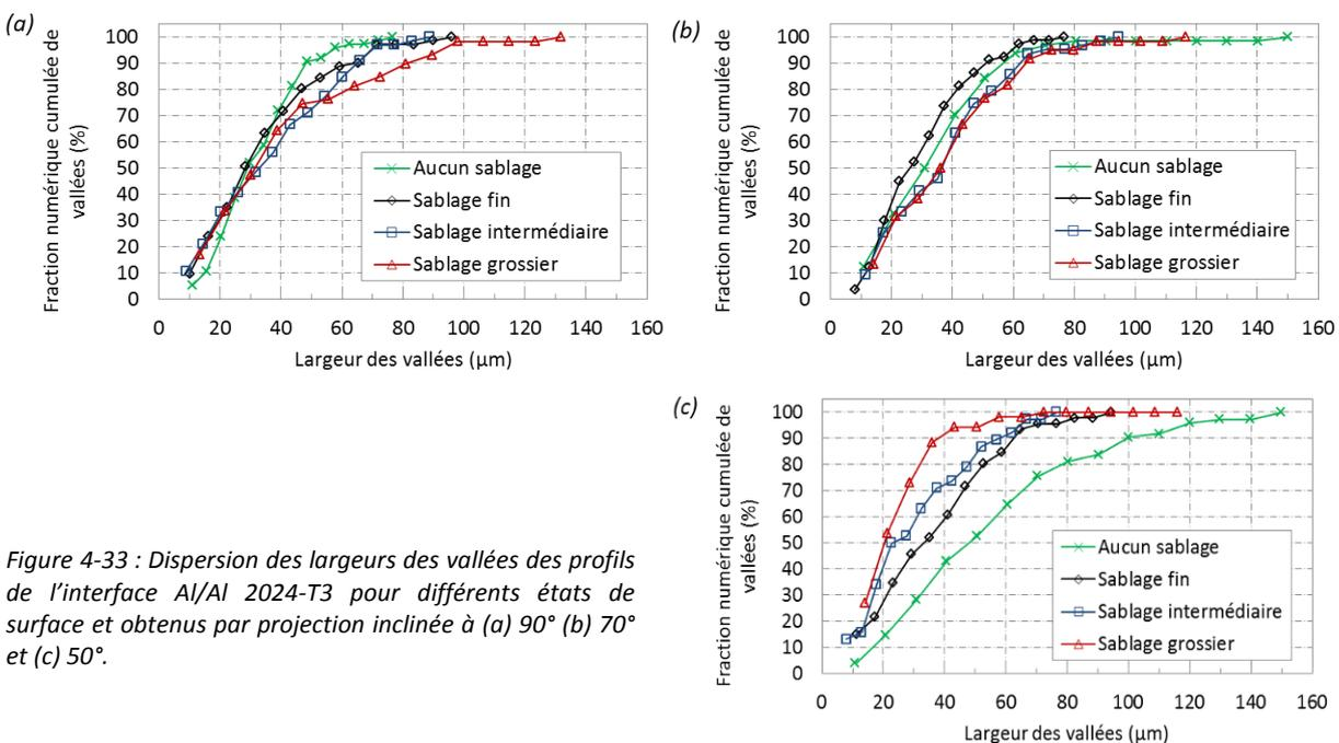
Figure 4-33 : Dispersion des largeurs des vallées des profils de l'interface Al/Al 2024-T3 pour différents états de surface et obtenus par projection inclinée à (a) 90° (b) 70° et (c) 50°.
