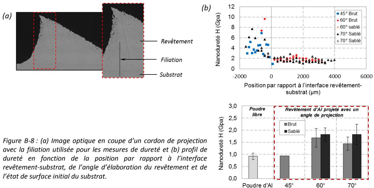
Figure B-8 : (a) Image optique en coupe d'un cordon de projection avec la filiation utilisée pour les mesures de dureté et (b) profil de dureté en fonction de la position par rapport à l'interface revêtement-substrat, de l'angle d'élaboration du revêtement et de l'état de surface initial du substrat.
