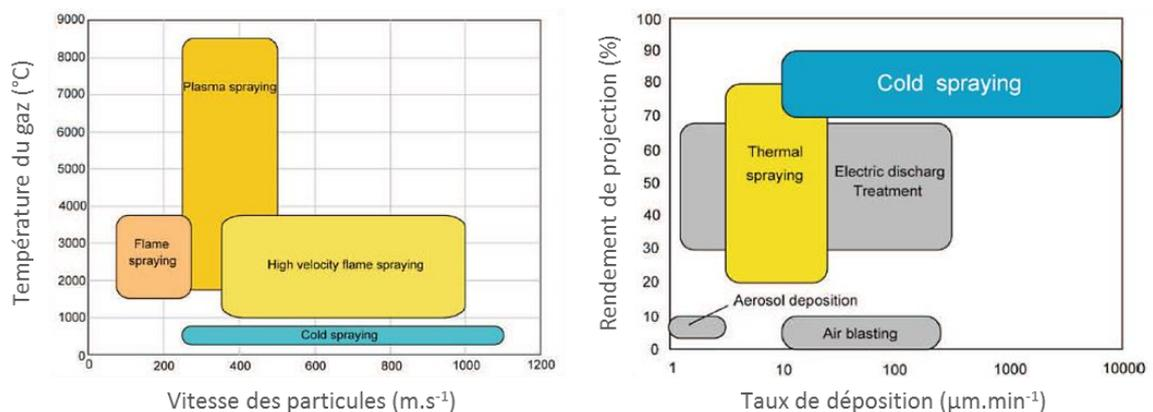
Figure 1-3 : Situation du procédé cold spray dans la famille des procédés de projection thermique [ICH07].
