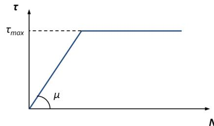
Figure 5-3 : Evolution de la force de frottement  $\tau$  en fonction de la pression de contact  $N$ , loi de Coulomb modifiée avec une contrainte limite  $\tau_{max}$ .
