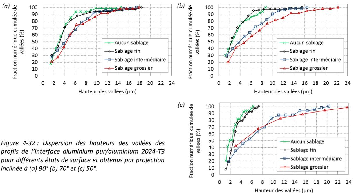
Figure 4-32 : Dispersion des hauteurs des vallées des profils de l'interface aluminium pur/aluminium 2024-T3 pour différents états de surface et obtenus par projection inclinée à (a) 90° (b) 70° et (c) 50°.
