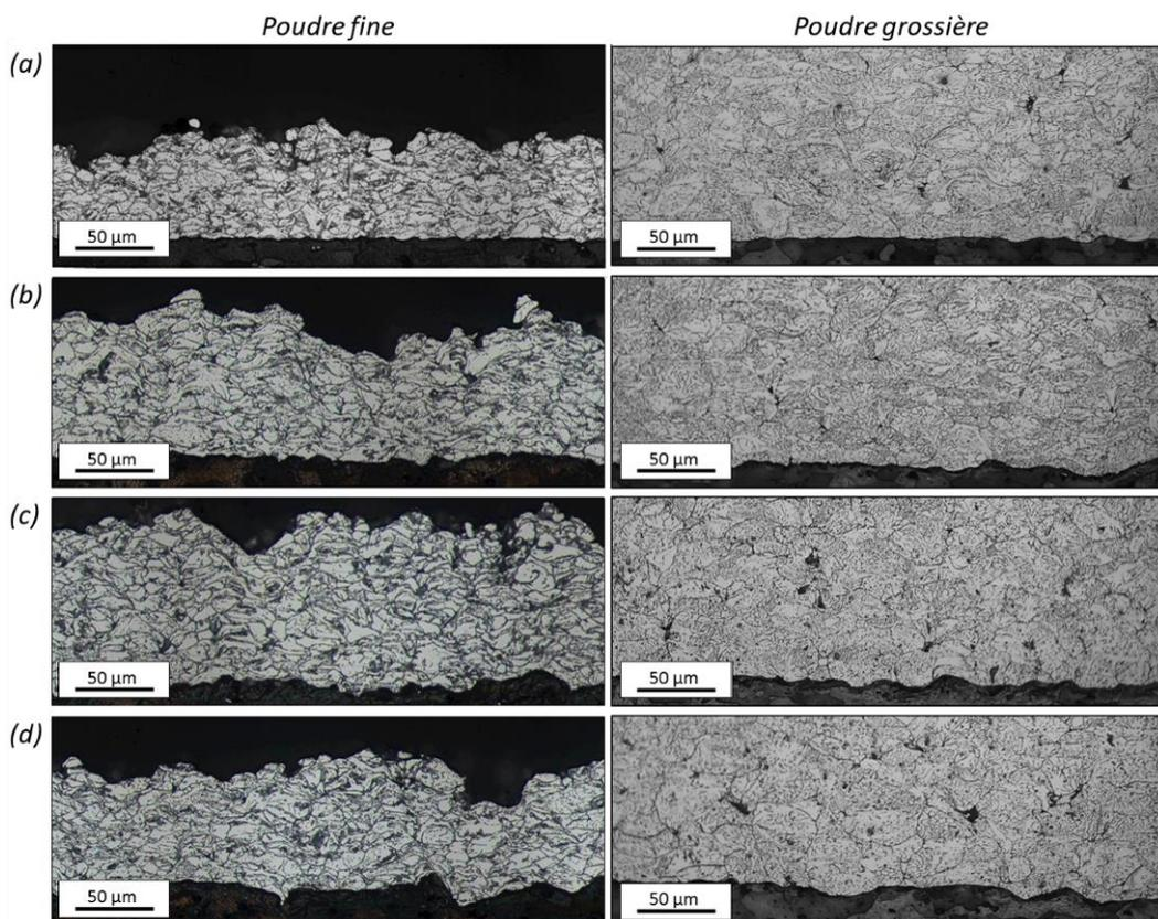
Figure 3-3 : Images optiques en coupe des revêtements d'aluminium pur élaborés à partir de particules, fines à gauche (10  $\mu\text{m}$ ) et grossières à droite (30  $\mu\text{m}$ ), sur substrats d'aluminium 2024-T3 : (a) à l'état brut, (b) sablé finement, (c) sablé moyennement et (d) sablé grossièrement, obtenues après une attaque chimique « Keller ».
