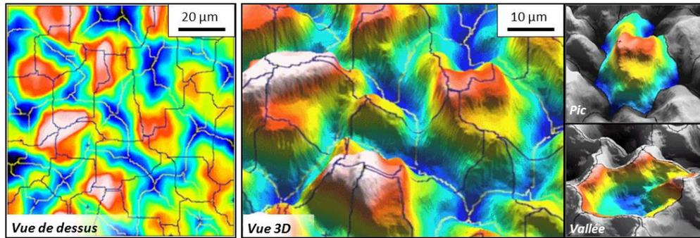
Figure 4-3 : Cartographies des cratères présents sur la surface rugueuse d'un substrat d'aluminium 2024-T3 sablé, obtenue suite à l'analyse profilométrique de surface.
