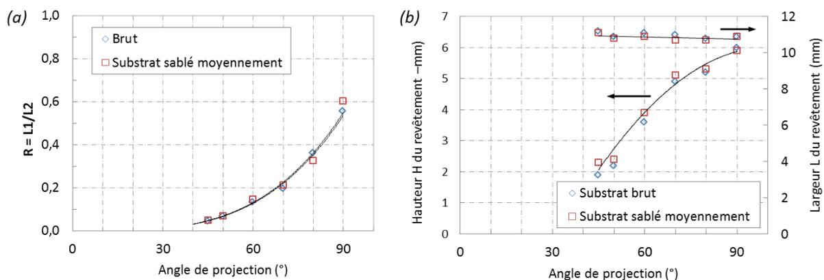
Figure B-3 : Evolution des dimensions géométriques du cordon de projection (a) du rapport  $R = L1/L2$  et (b) de la hauteur L et de la hauteur H du cordon, en fonction de l'angle de projection.
