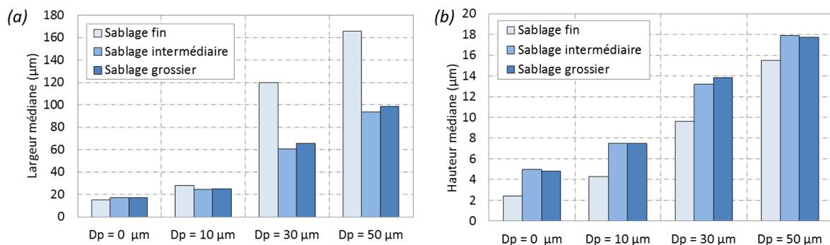
Figure 4-20 : Valeurs médianes (a) des largeurs  $L_v$  et (b) des hauteurs  $H_v$  des vallées des profils de substrats d'aluminium 2024-T3 sablés en fonction du niveau de filtre  $F$ , c'est-à-dire du diamètre de la particule,  $D_p = 4 \cdot F$ .
