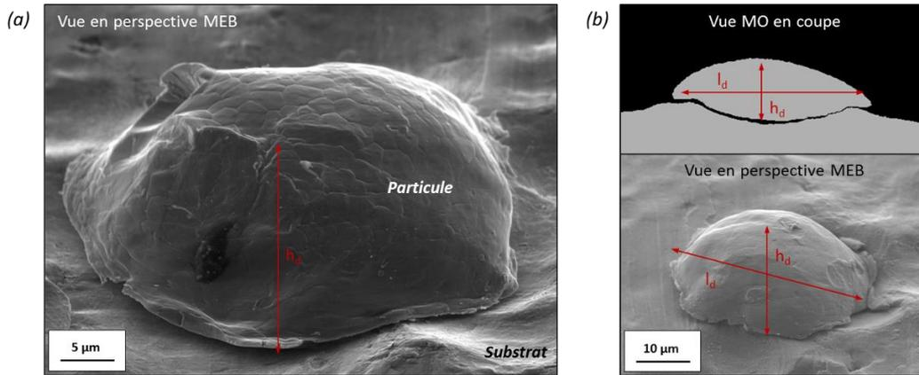
Figure 4-24 : Formulation du taux d'écrasement d'une particule déformée par cold spray (a) paramètre de hauteur déformée  $h_d$  et  $D_{p0}$  [ALK00] [WU06] et (b) paramètre de hauteur  $h_d$  et de largeur  $l_d$  [GIR14].
