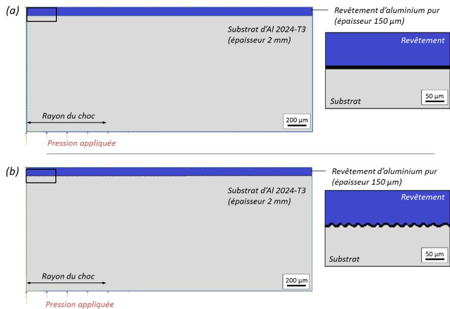
Figure 6-19: Modèles numériques 2D maillés du système revêtement d'aluminium pur 1050 sur substrat d'aluminium 2024-T3, cas d'une interface (a) plane et (b) rugueuse, utilisés pour la simulation de la propagation d'onde par choc laser.
