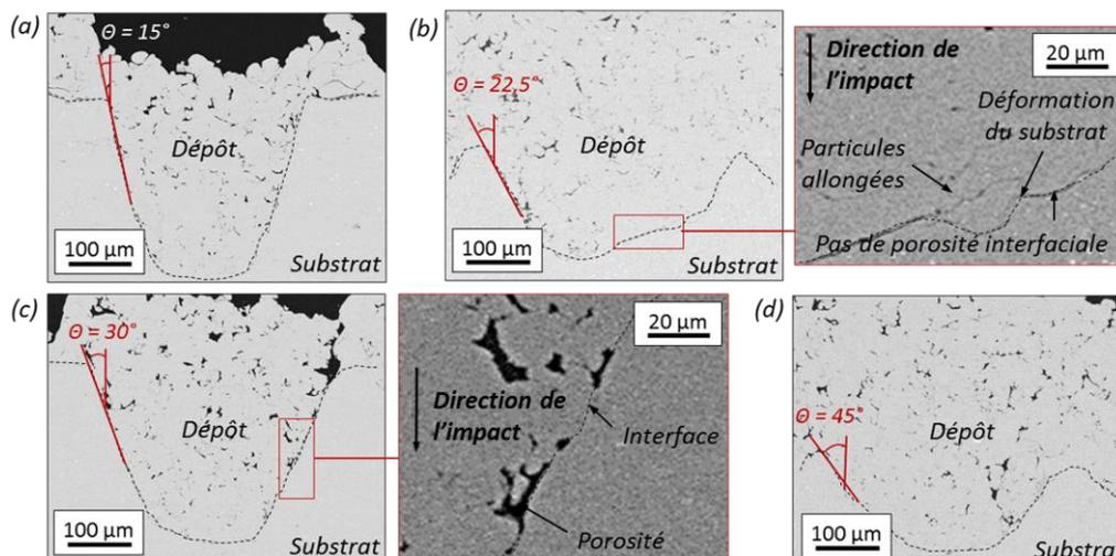
Figure 3-10 : Images optiques en coupe des revêtements d'aluminium pur 1050 sur substrats d'aluminium 2024-T3 usinés avec un angle de coupe de (a)  $30^\circ$ , (b)  $45^\circ$ , (c)  $60^\circ$  et (d)  $90^\circ$ .
