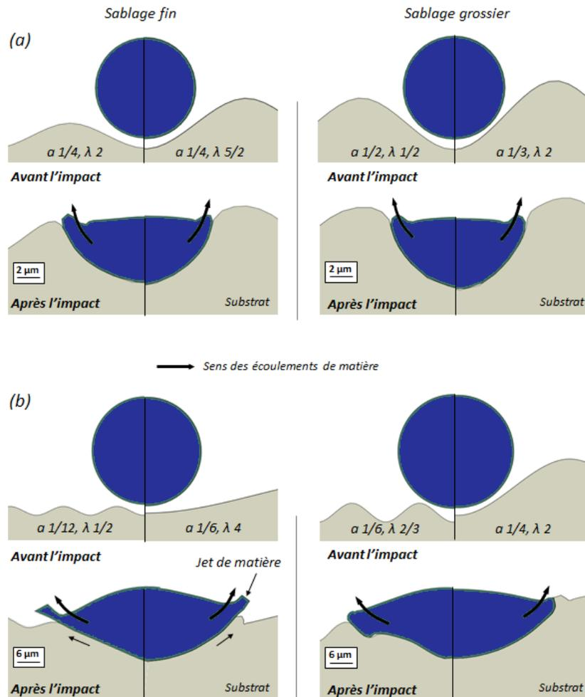
Figure 5-25 : Morphologie du système particule-substrat pour un profil rugueux, équivalent (à gauche des sous-figures) et équivalent vu par la particule (à droite des sous-figures), après impact d'une particule de diamètre (a) de 10 µm et (b) de 30 µm sur un substrat sablé finement et grossièrement.
