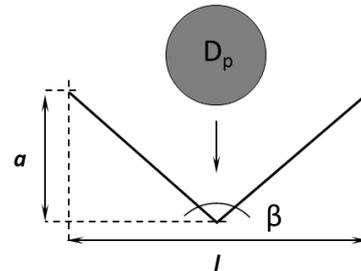
Figure 4-14 : Caractéristiques géométriques 1D d'une vallée issue d'une surface rugueuse vis-à-vis d'une particule de diamètre  $D_p$ .
