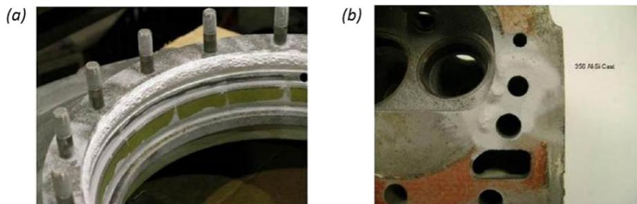
Figure 7-31 : Exemples de pièces réparées par cold spray : (a) revêtement de magnésium sur substrat de magnésium pour une pièce d'hélicoptère et (b) revêtement d'Al-Al<sub>2</sub>O<sub>3</sub> sur substrat d'Al-Si 356 constituant le bloc moteur [JON11].
