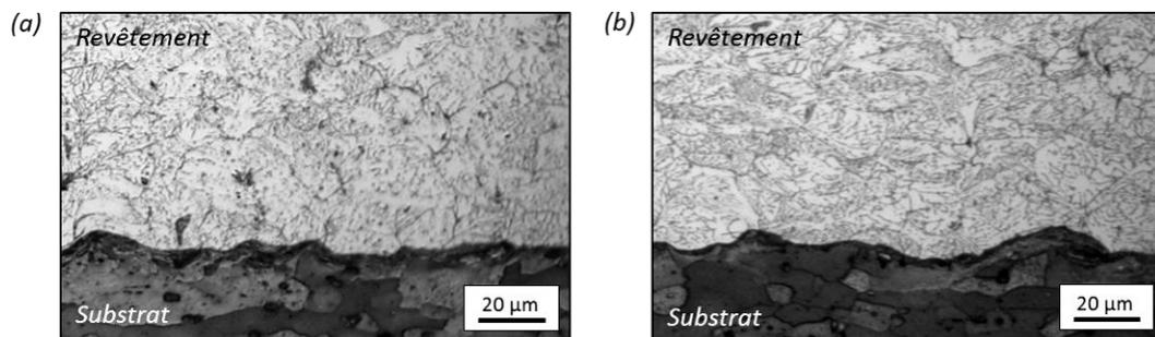
Figure 4-27 : Images optiques en coupe, obtenues après une attaque chimique « Keller », des interfaces revêtement-substrat : remplissage des vallées du substrat d'aluminium 2024-T3 (a) sablé finement et (b) sablé grossièrement avant la projection d'aluminium pur 1050 par cold spray.
