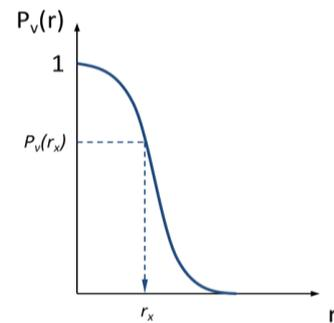
Figure 4-12 : Evolution de la proportion de vallées remplies d'un profil rugueux en fonction du rayon  $r$  de la particule.
