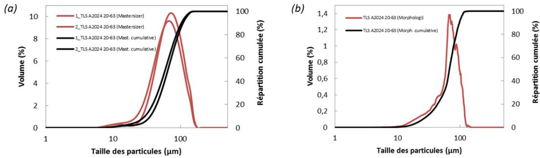
Figure A-5 : Répartition (a) granulométrique et (b) morphologique de la poudre d'aluminium 2024.
