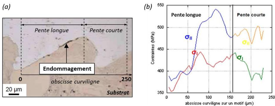
Figure 6-21 : (a) Image optique en coupe d'un substrat de cuivre revêtu par de l'aluminium après un choc laser de  $2,38 \text{ GW}\cdot\text{cm}^{-2}$  avec un amorçage de la fissuration à l'interface rugueuse et (b) évolution spatiales des contraintes maximales de traction et de traction-cisaillement le long des pentes du profil rugueux de l'interface, choc de  $1,35 \text{ GPa}$  [ARR04].
