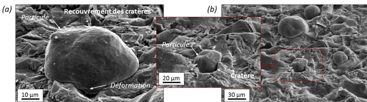
Figure 3-26 : Images MEB en électrons secondaires de particules d'aluminium pur 1050 (30  $\mu\text{m}$  de diamètre moyen) déposées sur substrat d'aluminium 2024-T3 sablé : (a) finement et (b) grossièrement.
