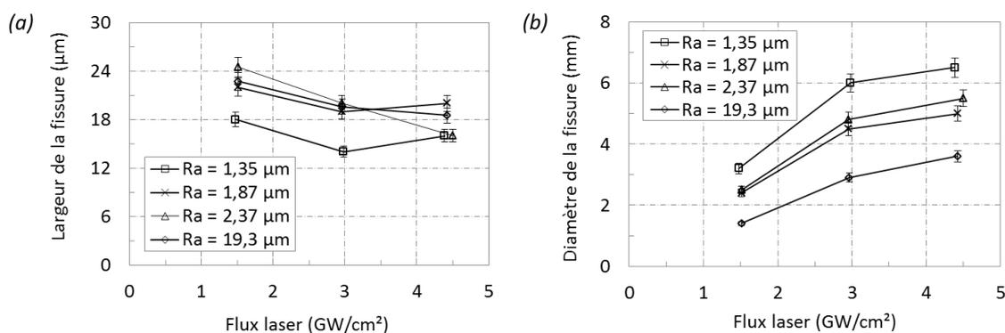
Figure 6-11 : Evolution des dimensions caractéristiques de la fissure interfaciale : (a) largeur et (b) diamètre, pour différentes rugosités de surface des revêtements d'aluminium pur 1050, de 100  $\mu\text{m}$  d'épaisseur, déposés sur un substrat d'aluminium 2024-T3.
