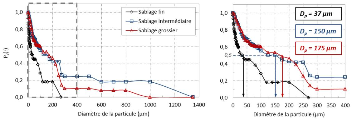
Figure 4-13 : Evolution de la proportion de vallées remplies en fonction du diamètre  $D_p$  de la particule pour différents états de surface du substrat d'aluminium 2024-T3 : sablage fin, intermédiaire et grossier.
