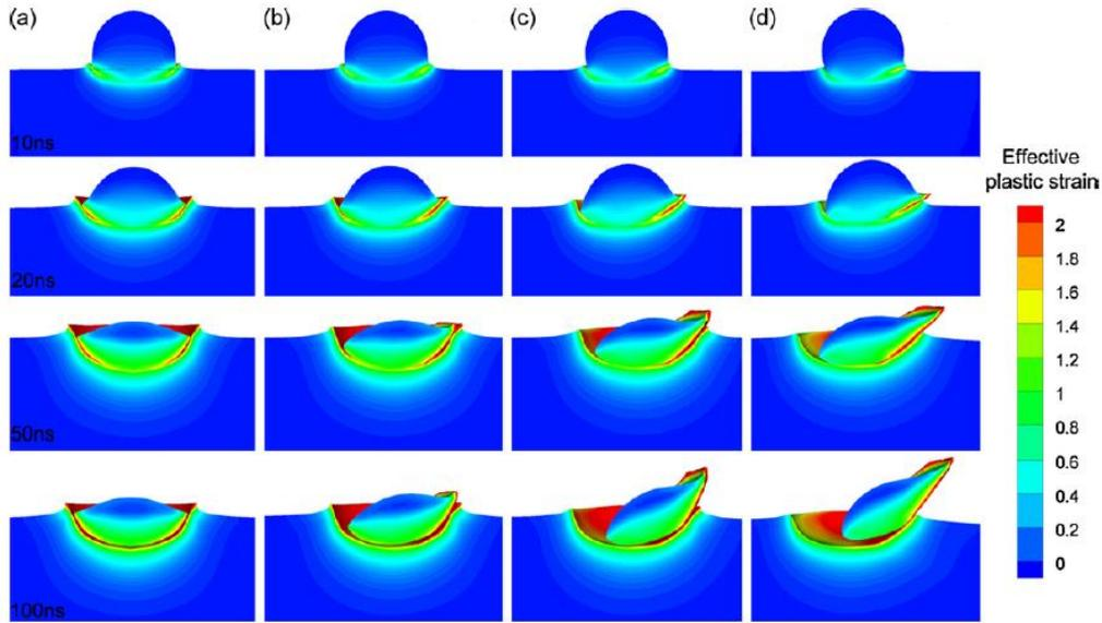
Figure 1-19 : Simulation par la méthode lagrangienne de la déformation plastique d'une particule de cuivre heurtant un substrat de cuivre à  $500 \text{ m.s}^{-1}$  avec un angle d'incidence de (a)  $90^\circ$ , (b)  $80^\circ$ , (c)  $70^\circ$ , et (d)  $60^\circ$  [LI10].
