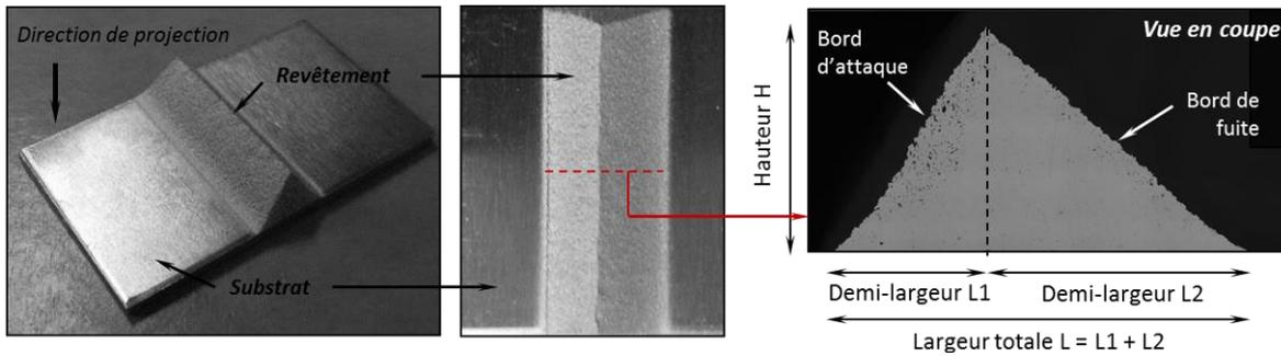
Figure B-2 : Photographies d'un cordon de projection de forte épaisseur observé respectivement en perspective (à gauche), en vue de dessus (au milieu) et en vue de profil au MEB (à droite) pour un angle de projection de 90°.
