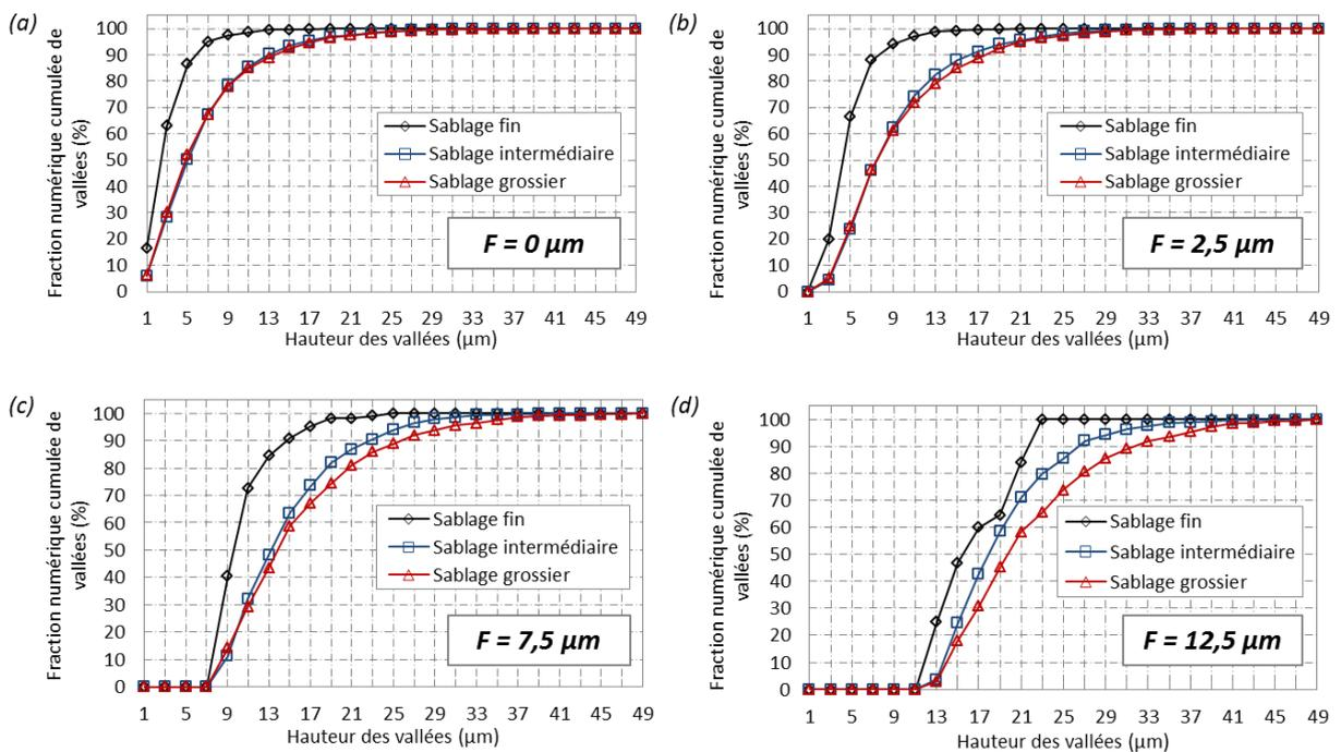
Figure 4-18 : Dispersion des hauteurs des vallées des profils de substrats d'aluminium 2024-T3 sablés (a) sans filtrage,  $F = 0$  et avec filtrage, (b)  $F = 2,5 \mu\text{m}$  ( $D_p = 10 \mu\text{m}$ ), (c)  $F = 7,5 \mu\text{m}$  ( $D_p = 30 \mu\text{m}$ ) et (d)  $F = 12,5 \mu\text{m}$  ( $D_p = 50 \mu\text{m}$ ),  $D_p = 4 * F$ .
