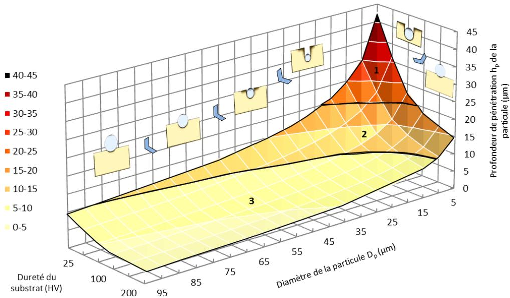
Figure 7-13 : Evolution de la profondeur de pénétration  $h_p$  de la particule en fonction de son diamètre  $D_p$  (sphérique et indéformable) et de la dureté HV du substrat pour une vitesse de particule de  $650 \text{ m.s}^{-1}$ .
