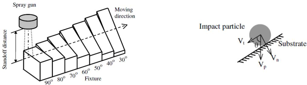
Figure 1-15 : Schéma de l'installation de projection pour différents angles d'incidence de la particule avec le substrat [LI03].
