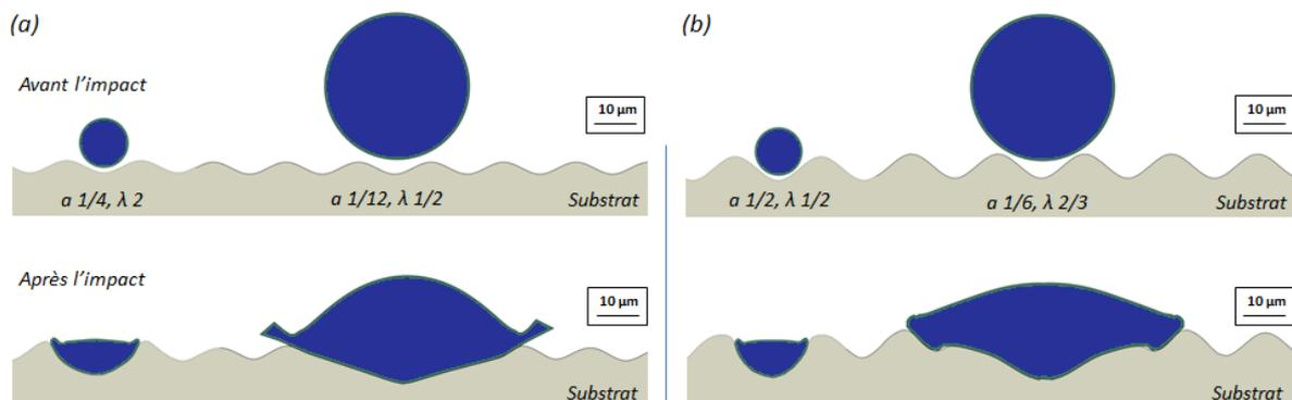
Figure 5-24 : Morphologie du système particule-substrat avant (en haut) et après (en bas) l'impact, pour une particule de  $10\ \mu\text{m}$  (à gauche des sous-figures) et  $30\ \mu\text{m}$  (à droite des sous-figures) percutant un substrat rugueux sablé (a) finement et (b) grossièrement.
