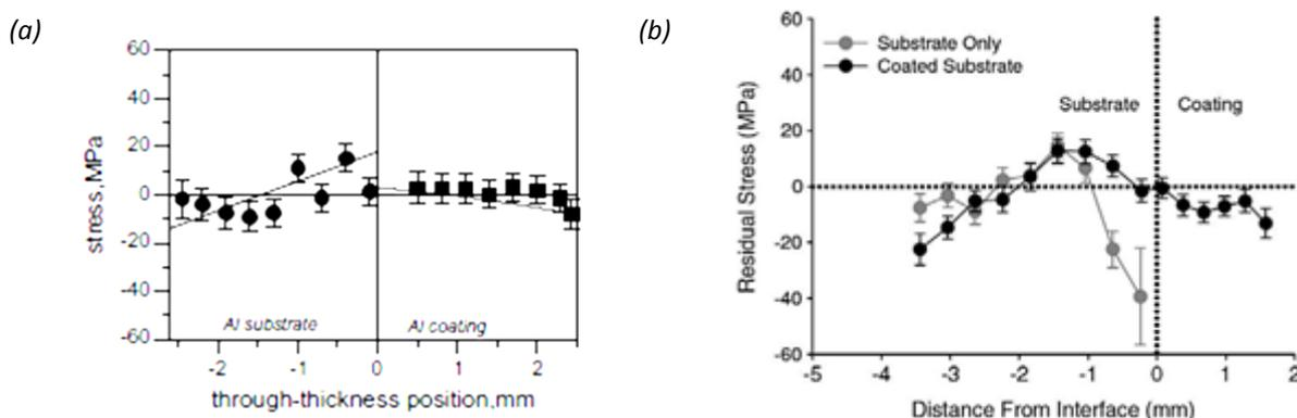
Figure E-1 : Distribution des contraintes résiduelles dans un revêtement d'aluminium déposé sur substrat d'aluminium, (a) sans préparation de surface [LUZ11] et (b) sablé [CHO07].
