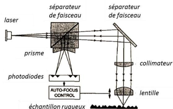
Figure 2-30 : Equipement de profilométrie du Centre des Matériaux (à gauche) et principe de la profilométrie laser en microscopie confocale avec codage chromatique [MAT93] (à droite).
