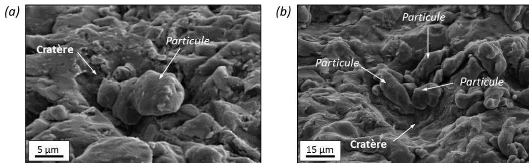
Figure 3-27 : Images MEB en électrons secondaires de particules d'aluminium pur 1070 (10 µm de diamètre moyen) déposées sur substrat d'aluminium 2024-T3 sablé : (a) finement et (b) grossièrement.
