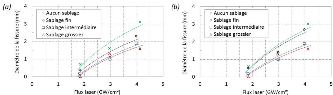
Figure 6-18 : Courbes LASAT-2D, pour différents états de sablage de la surface du substrat d'aluminium 2024-T3 et différentes granulométries de poudre : (a) 10  $\mu\text{m}$  de diamètre moyen et (b) 30  $\mu\text{m}$  de diamètre moyen.
