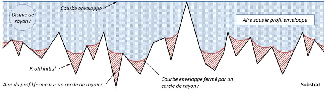
Figure 4-11 : Représentation schématique de remplissage morphologique des vallées du profil d'une surface rugueuse.
