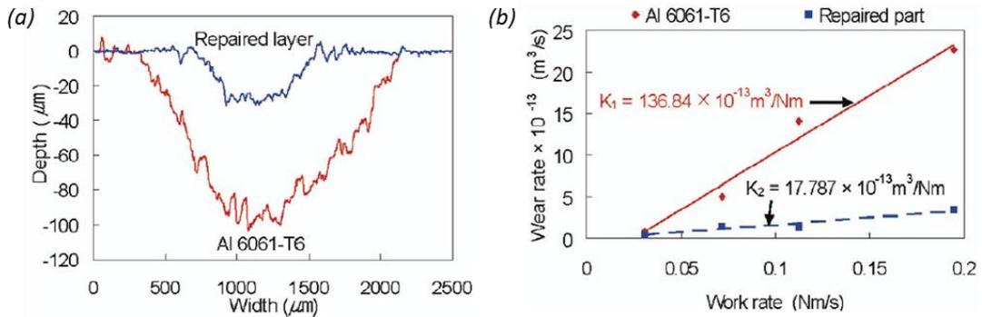
Figure 7-30 : Profils (a) d'usure et (b) de perte volumique subie suite à un essai d'usure réalisé sur le matériau brut et sur le matériau réparé par cold spray [LEE07].
