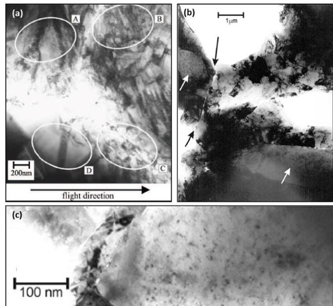
Figure 1-10 : Images MET (a) d'une interface Cu/Cu [BOR03], (b) d'un revêtement Cu (la flèche noire indiquant l'interface particule/particule et les flèches blanches indiquant des grains mouchetés) et (c) grossissement des grains mouchetés [BOR05].
