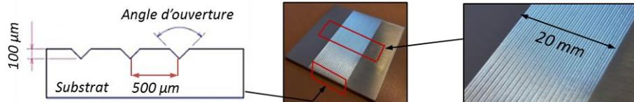
Figure 2-27 : Caractéristiques morphologiques des saignées réalisées par fraisage sur une plaque d'aluminium 2024-T3 brut de laminage de dimensions 50 x 50 x 2 mm<sup>3</sup>.
