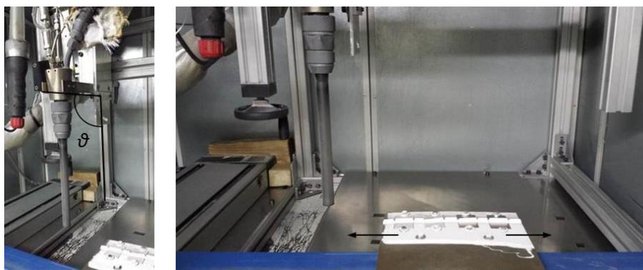
Figure B-1 : Dispositif expérimental pour la réalisation de cordon de projection de forte épaisseur avec pour objectif, l'effet de l'angle de projection sur la microstructure du revêtement, les flèches noires illustrent le mouvement du porte-échantillon par rapport à la buse de projection.
