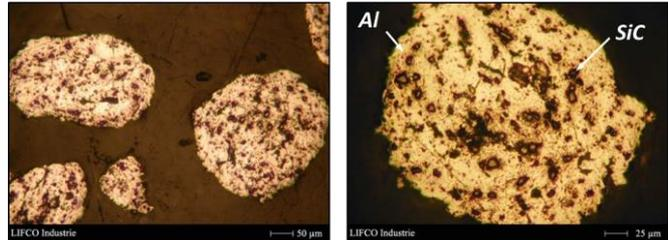
Figure 2-2: Microscopie optique en coupe des poudres composites Al-SiC élaborées par mécano-synthèse chez LIFCO Industries<sup>5</sup>.
