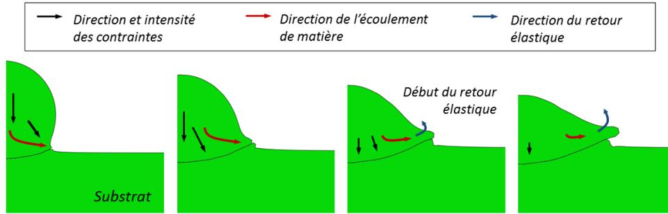
Figure 5-6 : Evolution temporelle de l'impact d'une particule avec déformation plastique du substrat et retour élastique.
