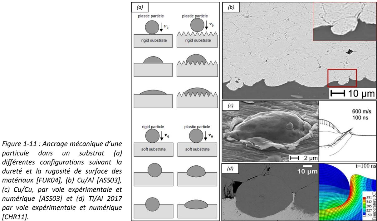
Figure 1-11 : Ancrage mécanique d'une particule dans un substrat (a) différentes configurations suivant la dureté et la rugosité de surface des matériaux [FUK04], (b) Cu/Al [ASS03], (c) Cu/Cu, par voie expérimentale et numérique [ASS03] et (d) Ti/Al 2017 par voie expérimentale et numérique [CHR11].
