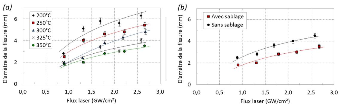
Figure 7-11 : Résultats d'adhérence déterminés par choc laser sur des revêtements d'aluminium 2024 déposés sur substrats d'aluminium 2024-T4 en fonction (a) de la température de gaz, pression fixée à 3 MPa avec un sablage du substrat et (b) du sablage du substrat, température de gaz fixée à 350°C et pression de gaz de 3,75 MPa.
