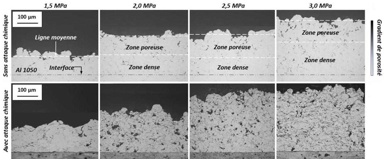
Figure 3-14 : Images optiques en coupe des revêtements élaborés par cold spray d'aluminium pur 1050 sur substrat d'aluminium 2024-T3 avec une variation de la pression du gaz cold spray et une température de gaz fixée à 250°C, obtenues avec et sans attaque chimique « Keller ».
