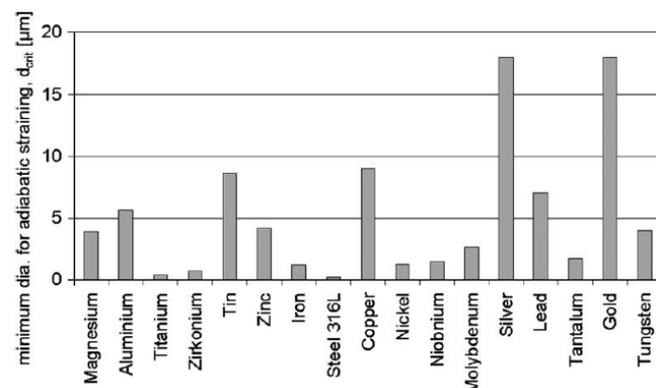
Figure 1-9 : Diamètre minimal de particules pour un cisaillement adiabatique en fonction du matériau projeté [SCH06].
