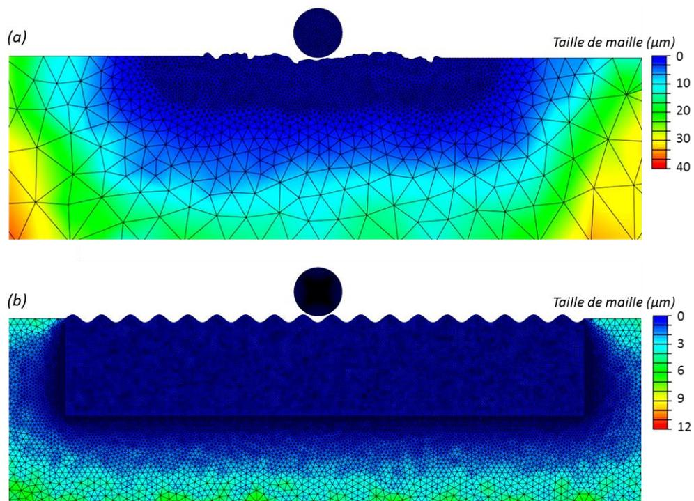
Figure 5-20 : Zone d'impact des simulations 2D d'impact d'une particule sur substrat rugueux après une opération de maillage optimisée (a) de la rugosité issue de l'observation en coupe et (b) de la rugosité équivalente issue de l'analyse topographique des surfaces rugueuses.
