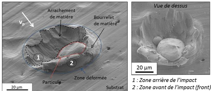
Figure 3-30 : Images MEB en électrons secondaires d'une particule d'aluminium pur 1050 déposée avec un angle de projection de  $60^\circ$  sur substrat d'aluminium 2024-T3 : vue en perspective (à gauche) et vue de dessus (à droite), la flèche blanche représente la direction de la particule avant l'impact.
