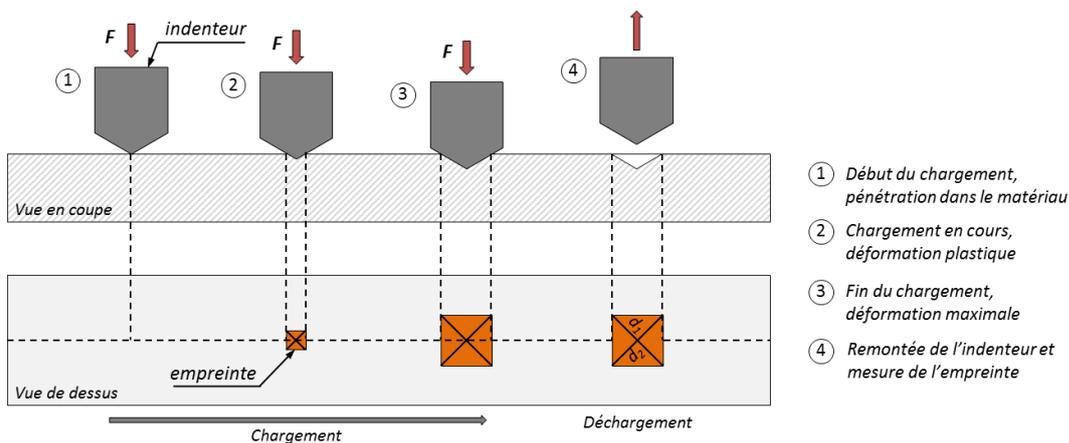
Figure 2-31 : Schéma de principe de la mesure de microdureté Vickers sur un matériau ductile.
