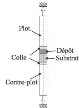
Figure 1-2 : Principe de l'essai d'adhérence par plot-collé [BAR04].
