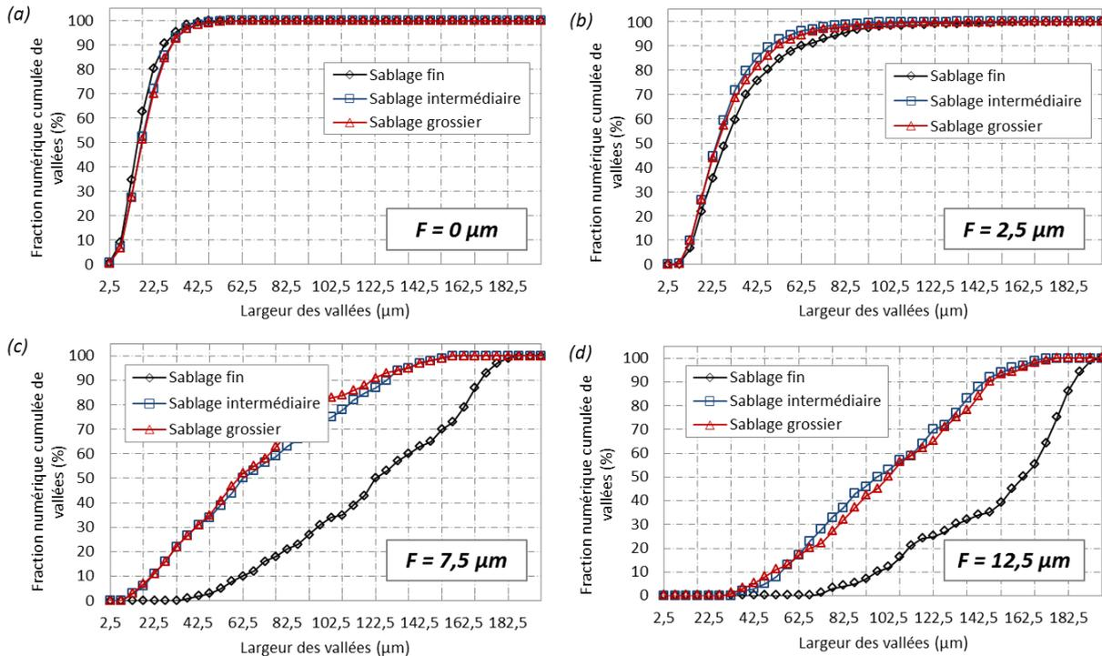
Figure 4-19 : Dispersion des largeurs des vallées des profils de substrat d'aluminium 2024-T3 sablés (a) sans filtrage,  $F = 0$  et avec filtrage, (b)  $F = 2,5 \mu\text{m}$  ( $D_p = 10 \mu\text{m}$ ), (c)  $F = 7,5 \mu\text{m}$  ( $D_p = 30 \mu\text{m}$ ) et (d)  $F = 12,5 \mu\text{m}$  ( $D_p = 50 \mu\text{m}$ ),  $D_p = 4 \cdot F$ .
