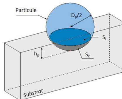
Figure 7-14 : Schématisation d'une particule de SiC ancrée dans un substrat d'aluminium, notion de surface de contact,  $S_c$  et de surface du substrat déformée par la particule,  $S_i$ .
