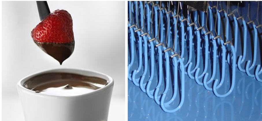
FIGURE 1 – Exemples d’enduction par trempage : fondue au chocolat sur une fraise (à gauche), peinture de crochets en acier (à droite)
