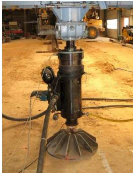
Figure 2-6 : Vérin de 100 kN appliquant une charge dynamique
