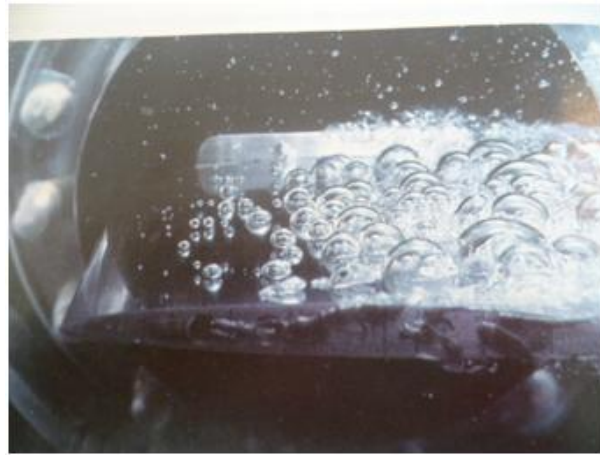
FIGURE 2.3 – cavitation à bulles séparées [15]
