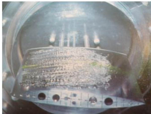
FIGURE 2.4 – poche de cavitation sur un profil d'aile [15]
