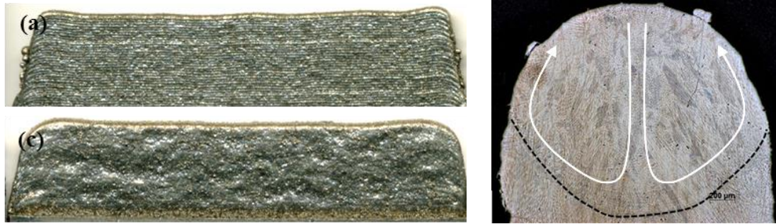
Figure C- 5 : Etats de surface optimal de murs en 316L (faible puissance en haut, puissance élevée en bas) et coupe transversale d'une zone fondue avec courbure centrale opposée à celle du Ti-6Al-4V en raison de \gamma T = d\sigma/dT de signes différents
