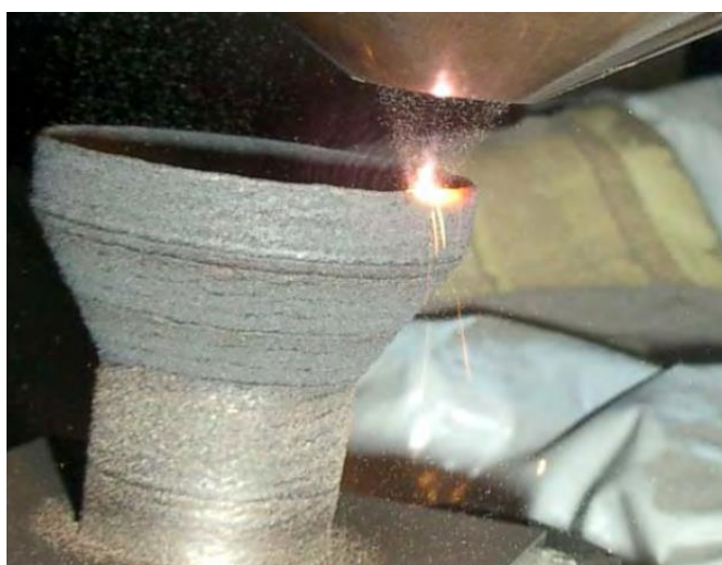
Figure Intr- 1: Élaboration d'une pièce de révolution par la technique de Fabrication Directe par Projection Laser 1
