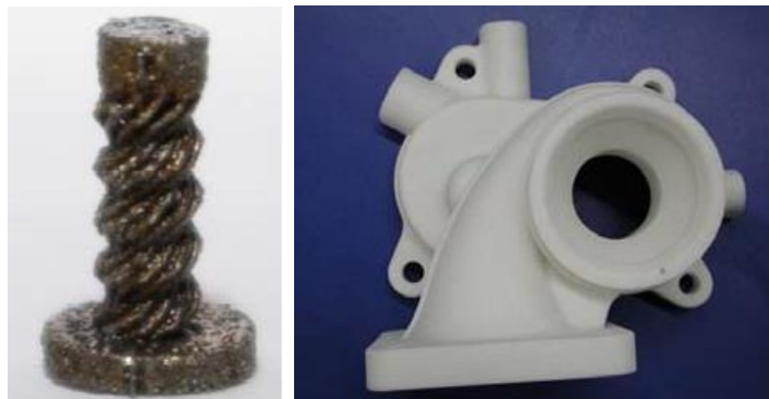
Figure I-10 : Exemples de pièces élaborées par FSL : implant dentaire en titane [EMMELMANN 2009], pièce aéronautique en polymère PA12 [KRUTH 2008]
