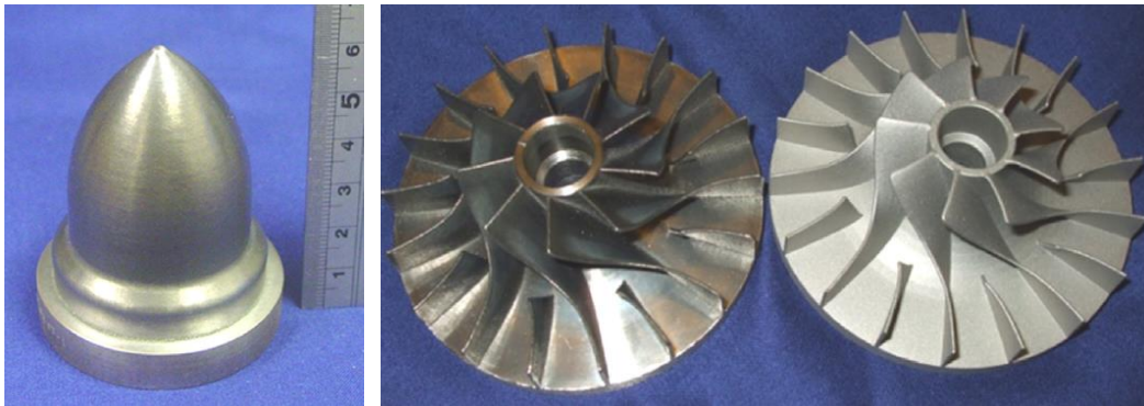
Figure I-23 : Exemples de pièces élaborées par FDPL en régime pulsé : (a) insert conique en In625, (b) rechargement d'aubes de turbine en In718 avant et après sablage ( R_a=2.7 \mu\text{m} ) [XUE 2011]
