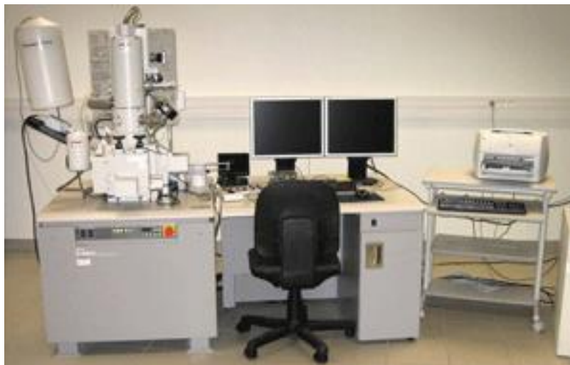
Figure II-30 : MEB Hitachi 4800 du PIMM et spectromètre EDS
