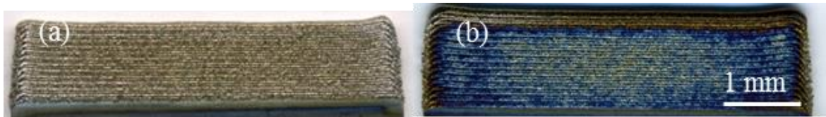
Figure III-54 : image de deux murs faits dans les mêmes conditions opératoires (P=400 W - D m =2 g/min - V=0.4 m/min) et différents gaz de protection (a) Hélium (b) Argon
