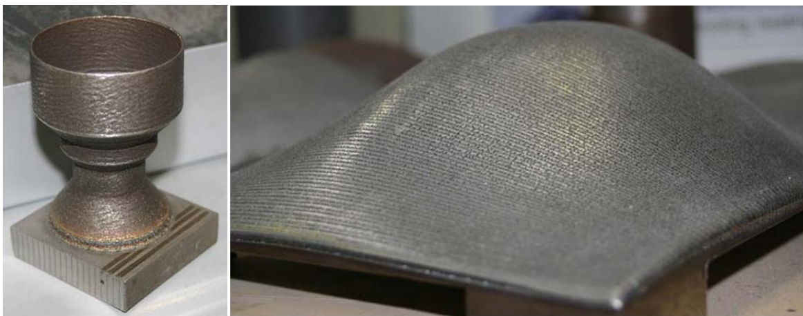
Figure I-12 : Exemples de pièces fabriquées par FDPL ou rechargement laser chez DMA Laser
