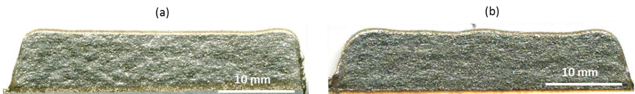
Figure V-17 : Images des murs élaborés avec une protection d'Argon globale (60 ppm d' O_2 ) (a) ou locale 5000 ppm d' O_2 (b) ( P = 400 W - V = 0.6 m/min et D_m = 4 g/min)
