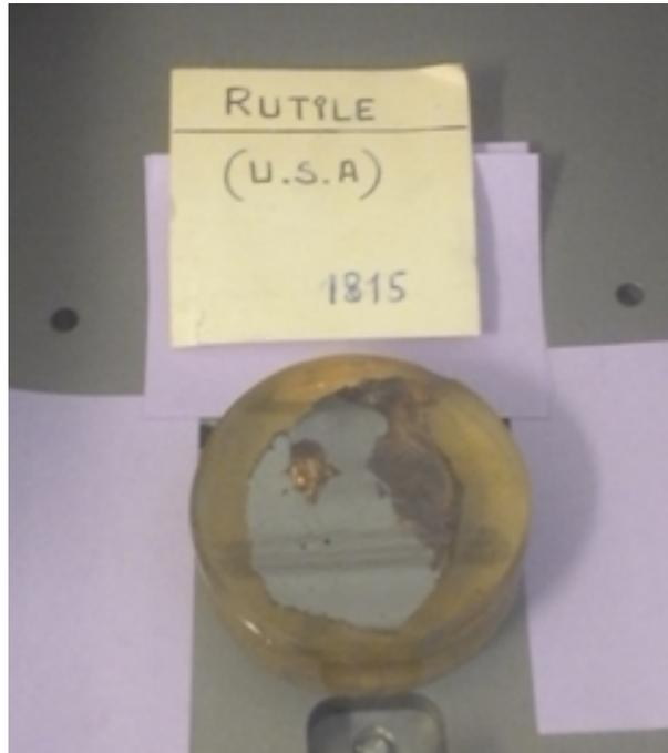
FIGURE 9.16 – Échantillon macroscopique d'un cristal de rutile conservé dans de la résine. La surface a été polie.
