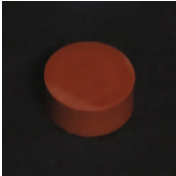
FIGURE 9.7 – Cylindre de peinture étalon hématisite/époxy, de plusieurs centimètres de hauteur et de diamètre.
