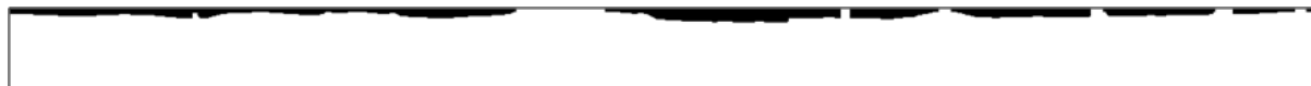
FIGURE 3.5 – Couche de peinture segmentée, la partie blanche correspond à l'épaisseur dans laquelle peut se situer des paillettes.
