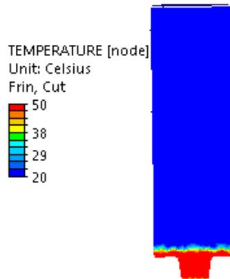
Figure VI-3 : Champs initial de température dans l’outil.
