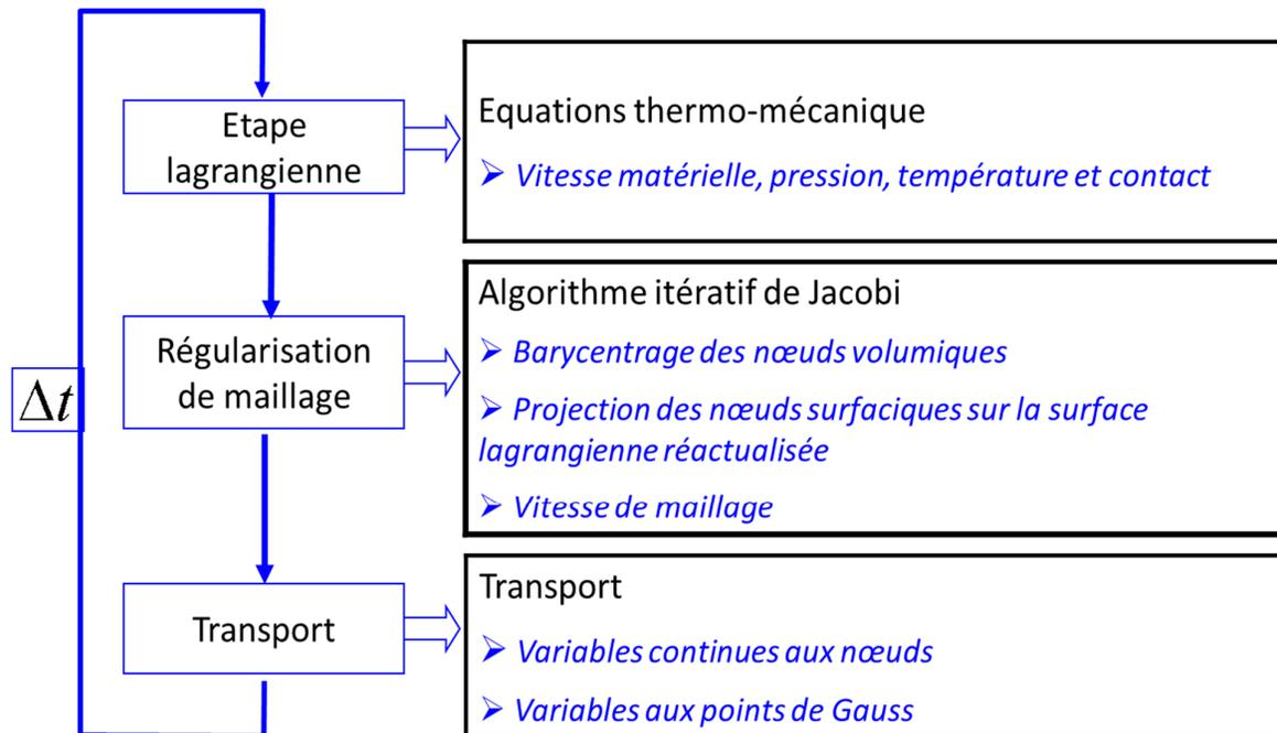
Figure III-6 : Schéma de la formulation ALE considérée.
