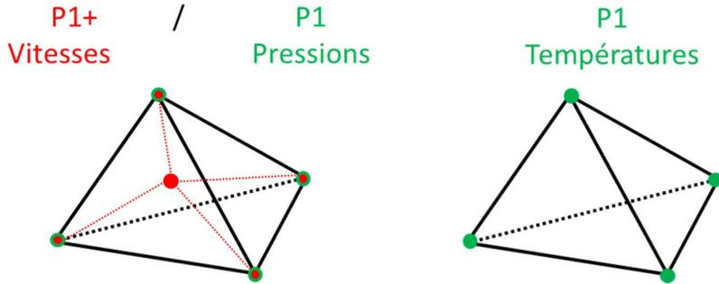
Figure III-5 : Eléments pour l'interpolation des vitesses, pressions et températures
