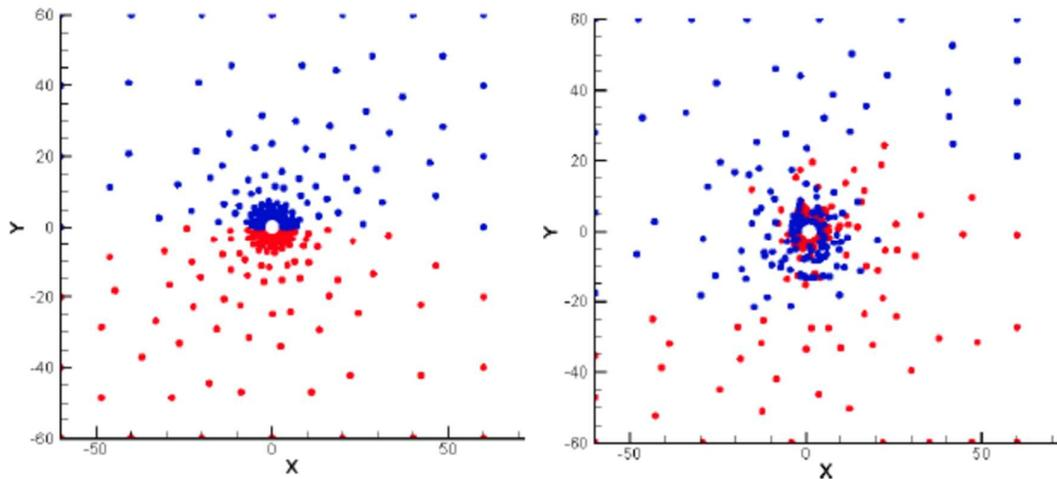
**Figure II-5 : Suivi 2D du malaxage en FSW par la méthode NEM, la zone d'avance est colorée en rouge et la zone de retrait est colorée en bleu (Alfaro et al. 2007). A gauche à l'instant initial et à droite au bout de 4000 pas de temps.**
