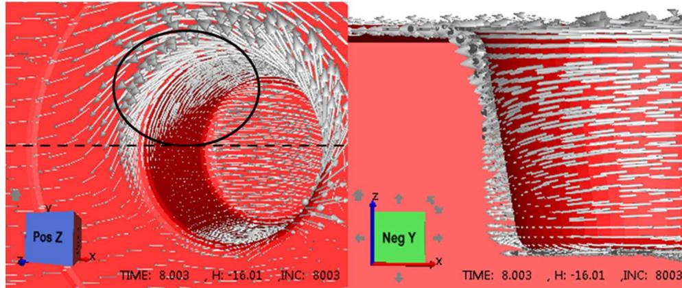
**Figure VI-8 : Exemple d'écoulement considéré comme mauvais. Champs des vitesses sous l'épaulement et autour du pion (gauche) et dans le plan de coupe de la ligne de soudure à l'arrière du pion (droite).**
