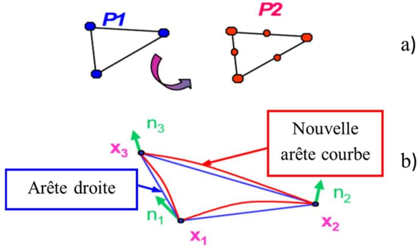
Figure III-9 : Patch de Nagata : augmentation de l'ordre d'interpolation
