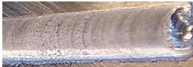
Figure V-18 : Essai 28, porosité en surface.
