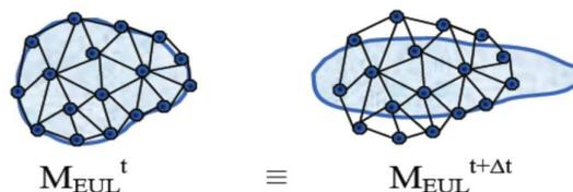
**Figure II-11 : Schématisation de l'évolution du maillage avec une approche eulérienne.**
