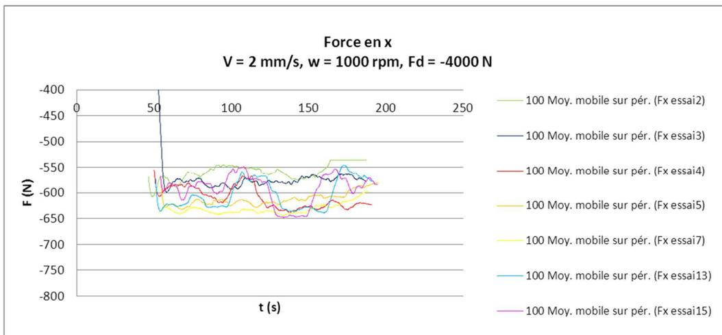
**Figure V-16 : Répétabilité de la force longitudinale en x.**
