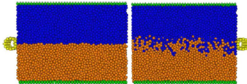
**Figure II-9 : Malaxage de 2 matériaux par l'outil FSW (Terrerros et al. 2009).**
