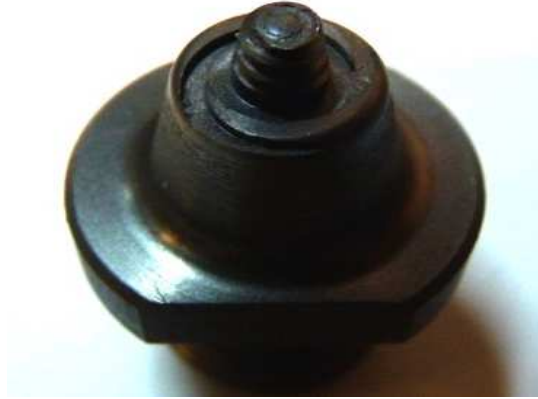
Figure V-4 : Outil FSW conique fileté (pion) et scrollé (épaulement).
