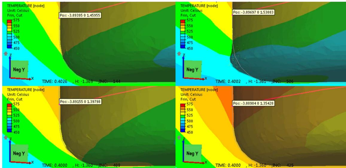
**Figure IV-12 : Influence du rapport de soudage et du filetage sur l'écoulement. Plan de coupe dans la ligne de soudure ; température et suivi d'une particule en trait rose. Haut : pas de filetage, vitesse d'avance de 3.4 mm/s à gauche et de 10.2 mm/s à droite. Bas : vitesse d'avance de 10.2 mm/s, pas de 3 mm à gauche et de 10 mm à droite.**
