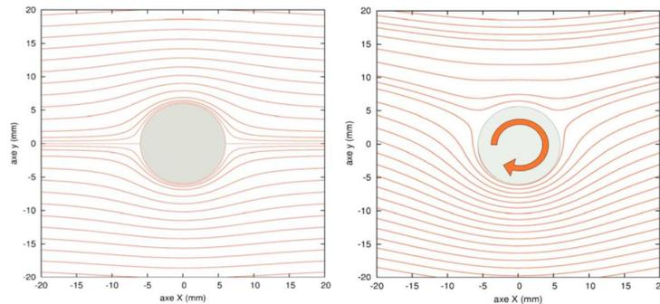
**Figure II-12 : Influence de l'action de l'outil FSW sur l'écoulement de matière au travers de la visualisation des lignes de courant : l'outil est fixe en rotation à gauche, il est en rotation à droite (Jacquin et al. 2011).**
