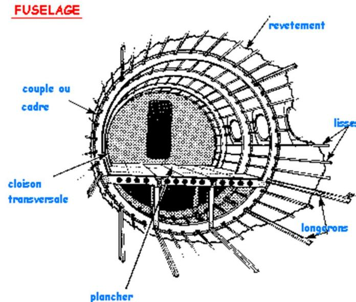
Figure I-1 : Schéma du fuselage d'un avion (<http://mecanique.du.vol.free.fr/fragmente.html>).
