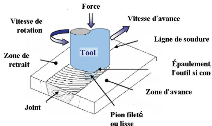
Figure I-2 : Géométrie et paramètres du procédé.
