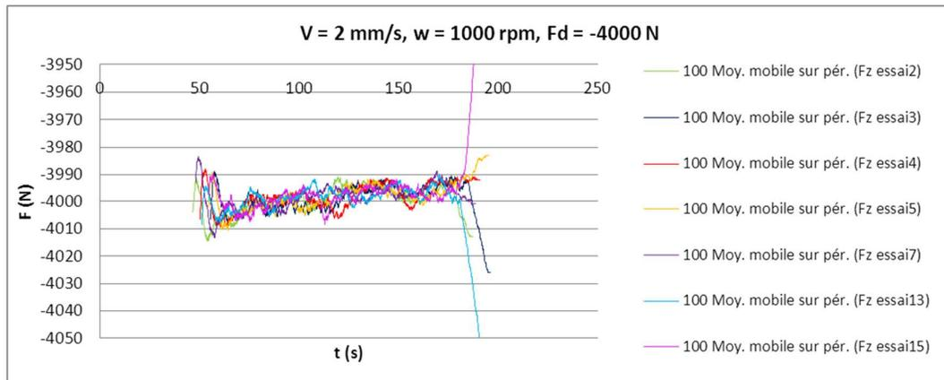
**Figure V-15 : Répétabilité de la force imposée sur l'outil.**
