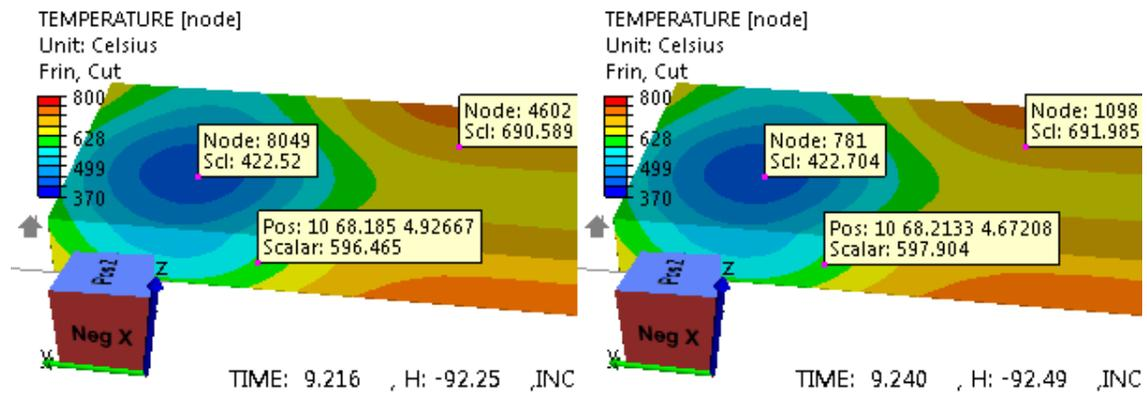
Figure III-16 : Validation de la méthode de transport amont de la température :
