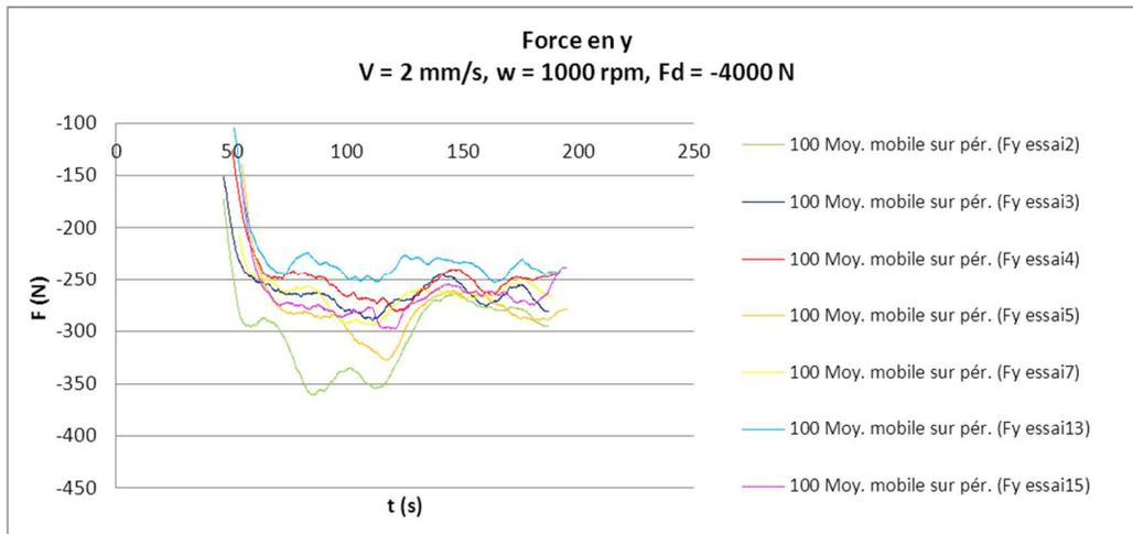
**Figure V-17 : Répétabilité de la force transverse en y.**
