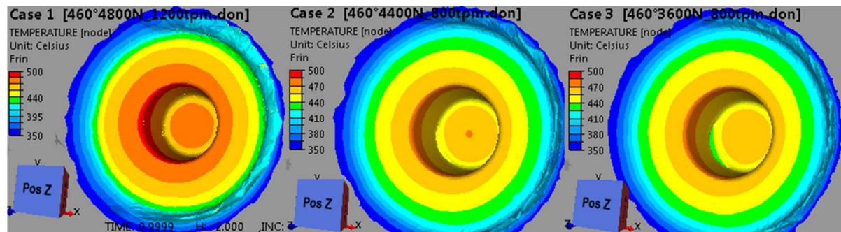
**Figure VI-43 : Champs de température pour le calcul 1 ( $\omega = 1200$  tpm et  $F = 4800$  N) (à gauche) ; pour le calcul 2 ( $\omega = 800$  tpm et  $F = 4400$  N) (au centre) ; pour le calcul 3 ( $\omega = 800$  tpm et  $F = 3600$  N) (à droite).**
