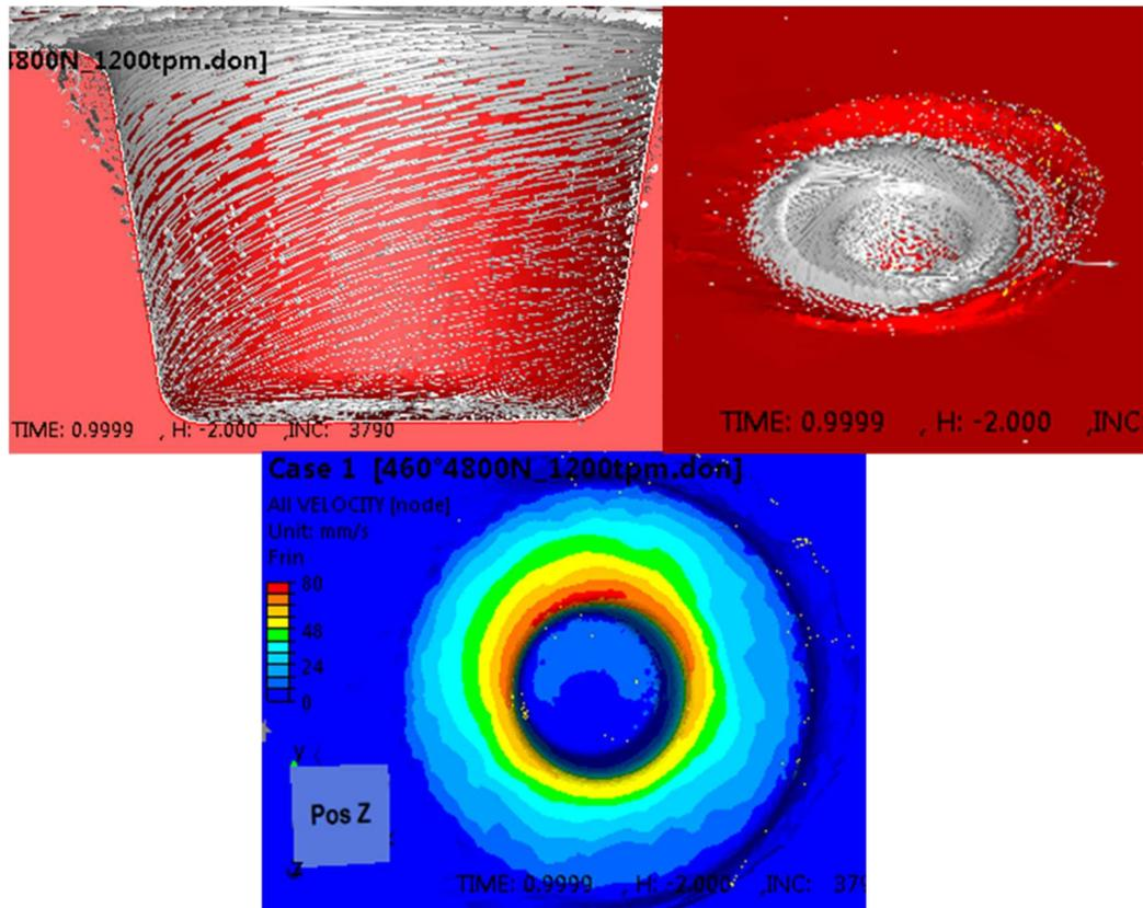
**Figure VI-41 : Coefficient de frottement  $p = 0,15$  et filetage de pas de vis de 3 mm sur le pion. Champ des vecteurs vitesses, dans le plan de coupe dans la ligne de soudure (à gauche) et vue de dessus (à droite) ; norme du champ des vitesses (en bas).**
