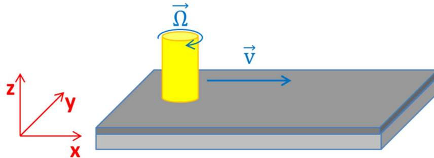
Figure V-2 : Configuration de soudage à l'échelle du laboratoire.
