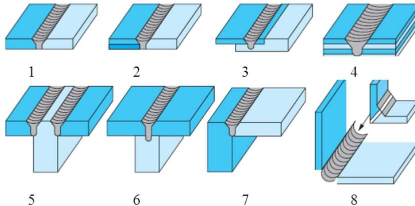
Figure I-5 : Configurations de soudage (Cazes 2003).
