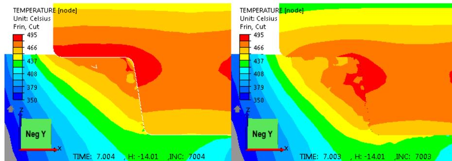
**Figure VI-27 : Champs de température dans le plan de coupe de la tôle et de l'outil. Gauche : frottement de Norton avec  $\alpha = 0,6$  et  $p = 0,125$  ; Droite : frottement de Coulomb avec  $\mu = 0,8$  et  $\bar{m} = 1$ .**
