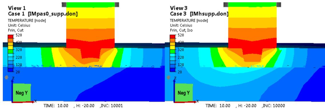
**Figure VI-14 : Champ de température dans la tôle et la plaque support :
