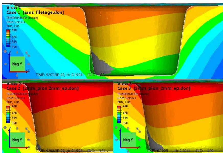
**Figure VI-39 : Plan de coupe dans la ligne de soudure. Champs de température dans la tôle : haut = sans filetage ; bas gauche = filetage de 2 mm sur le pion et l'épaulement ; bas droit = filetage de 3 mm sur le pion et de 2 mm sur l'épaulement.**
