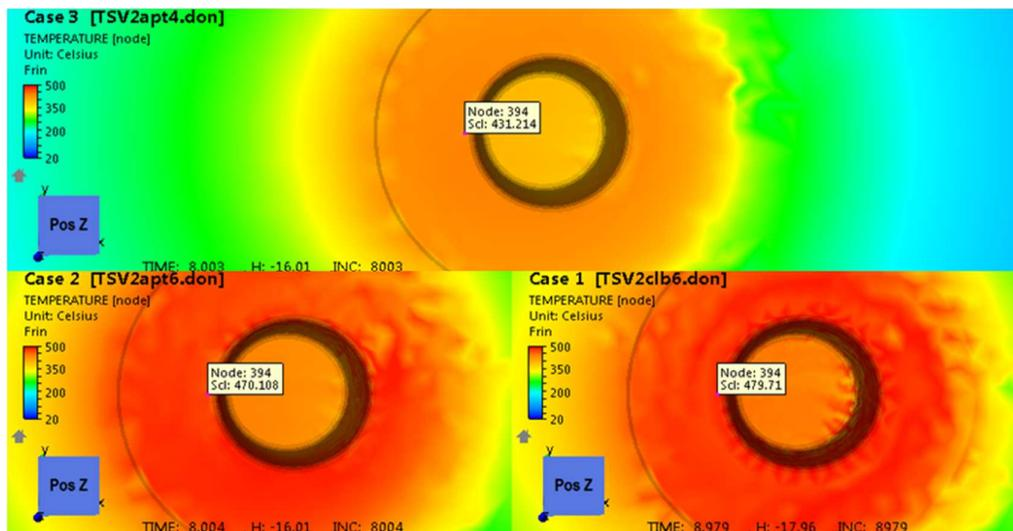
Figure VI-25 : Champs de température. Haut : frottement de Norton avec  $\alpha = 0,4$  et  $p = 0,125$  ; bas à gauche : frottement de Norton avec  $\alpha = 0,6$  et  $p = 0,125$  ; bas à droite : frottement de Coulomb avec  $\mu = 0,8$  et  $\bar{m} = 1$ .
