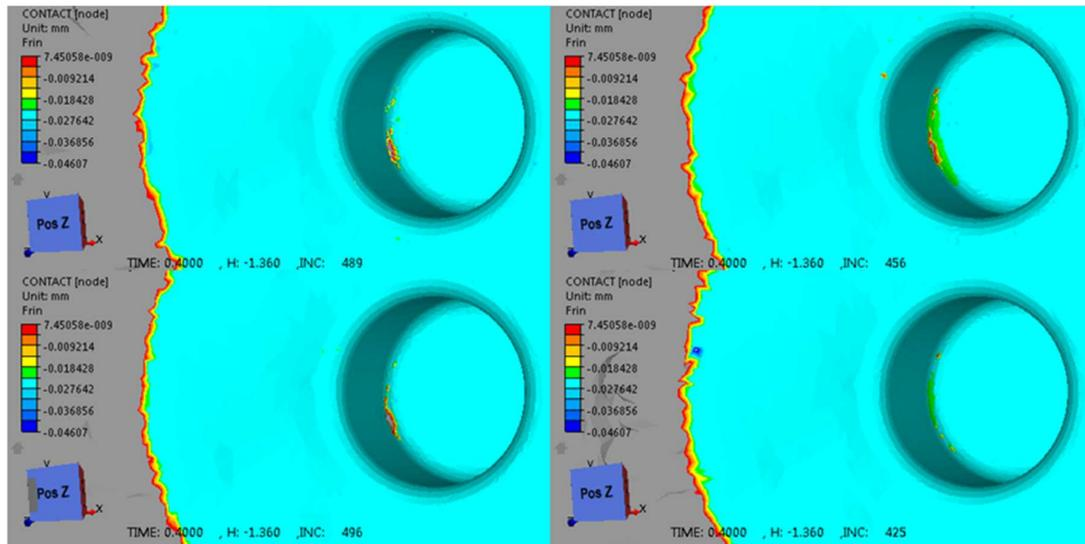
**Figure IV-13 : Influence du pas de filetage sur la formation de défauts. Les iso valeurs représentent la distance entre les nœuds et l'outil. Haut à gauche = pas de 3 mm ; haut à droite = pas de 4 mm ; bas à gauche = pas de 5 mm ; bas à droite = pas de 10 mm.**
