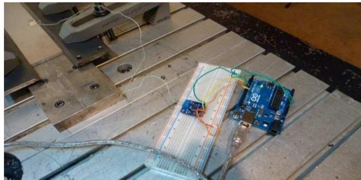
Figure V-10 : Système d'acquisition de température dans la plaque.
