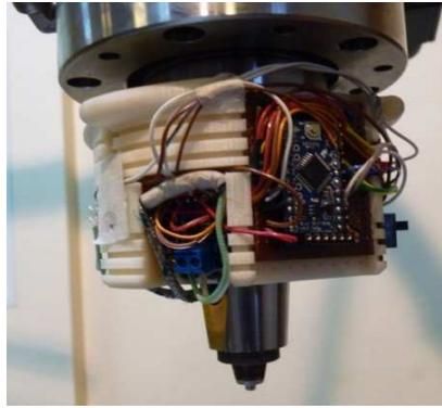
**Figure V-6 : Système d'acquisition de température dans l'outil.**
