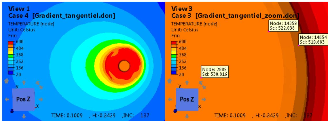
**Figure III-19 : Champ de température corrigé obtenu après 0.1 s de soudage en ne considérant que le gradient tangentiel, vue de dessus à gauche et zoom en fond de pion en amont de l'écoulement à droite.**
