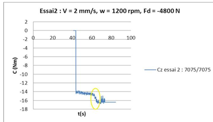
Figure V-43 : Couple axiale mesuré lors de l'essai 2 en 7075.
