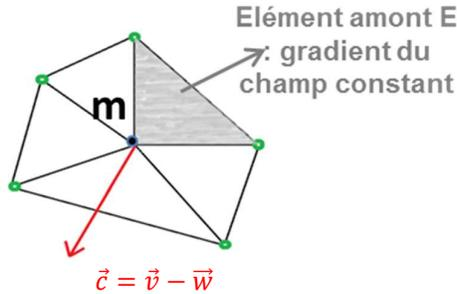
Figure III-11 : Vitesse convective et élément amont
