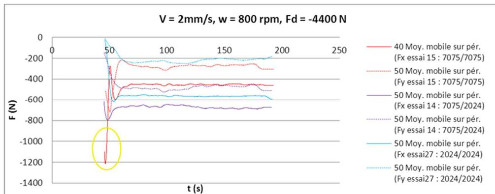
**Figure V-33 : Forces transversales en x et en y pour les 3 configurations.**
