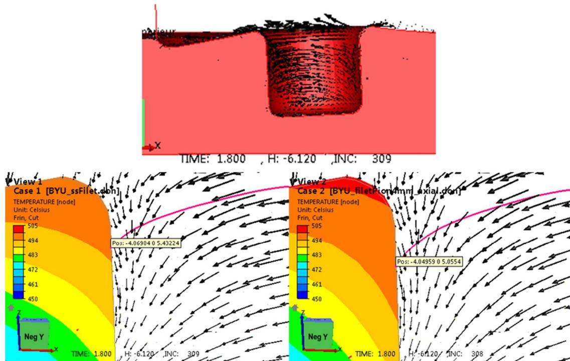
**Figure IV-10 : Haut : plan de coupe suivant la ligne de soudure sans filetage. Bas : zoom sur la zone intérieure de l'épaulement, sur le haut et à l'arrière du pion en bas : sans filet à gauche et avec un filet de pas 4 mm à droite. Champ de température dans le plan de coupe ; champs de vitesses dans la matière ; ligne de courant d'une particule en trait rose.**
