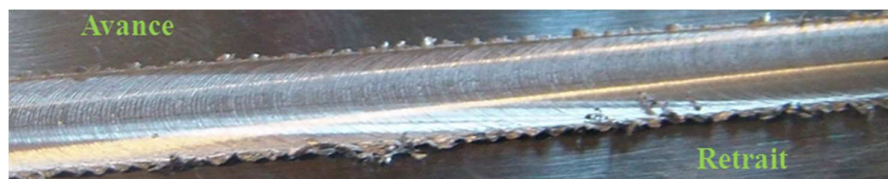
Figure VI-7 : Soudure avec bavure pour l'essai n°29.
