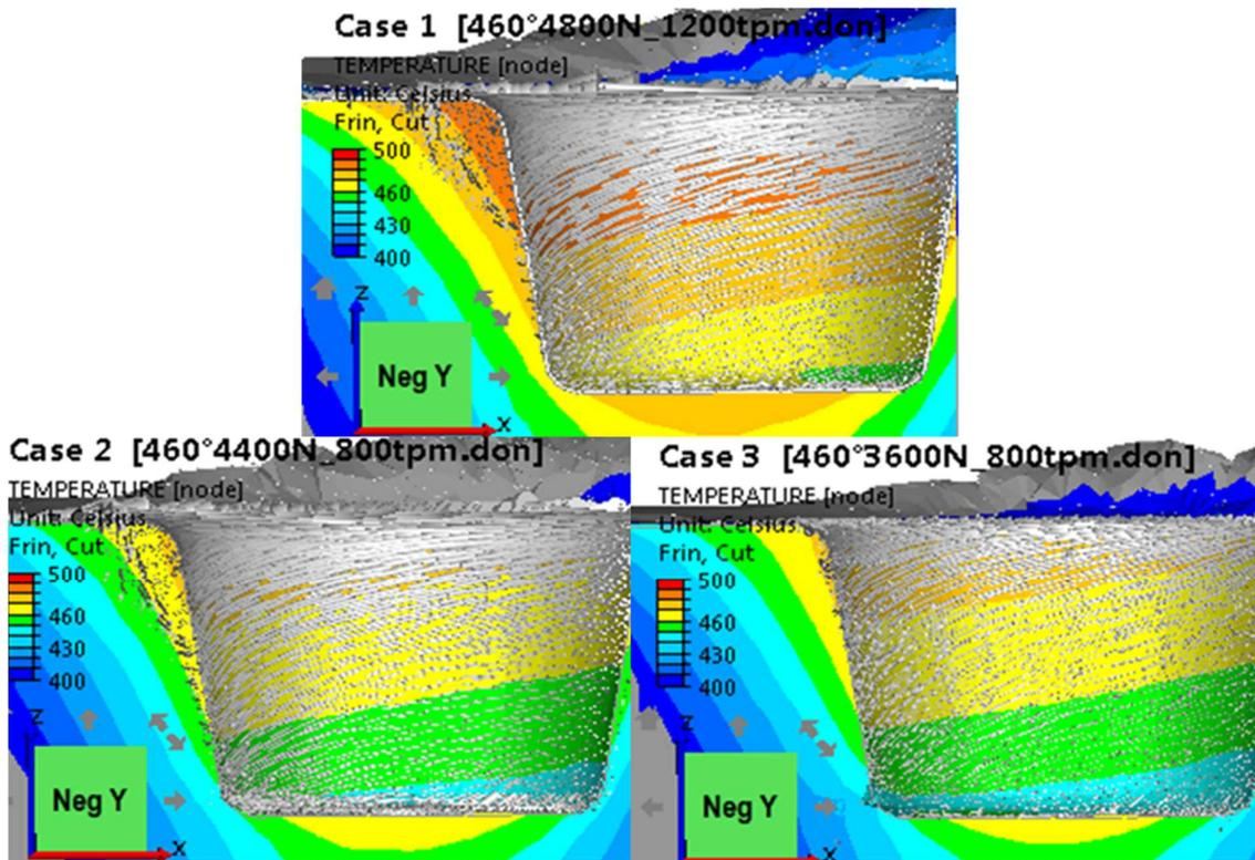
Figure VI-45 : Plan de coupe dans la ligne de soudure. Vecteurs vitesses et champ de température pour *le calcul 1* (en haut) ; pour *le calcul 2* (en bas à gauche) ; pour *le calcul 3* (en bas à droite).
