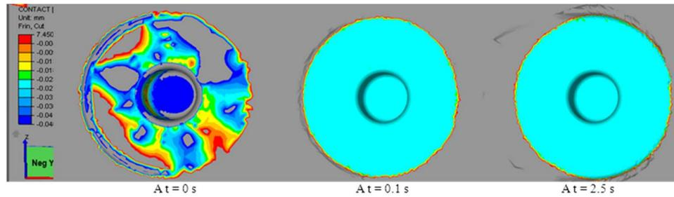
**Figure IV-14 : Etat de contact au cours de la simulation sous l'épaulement et autour du pion.**
