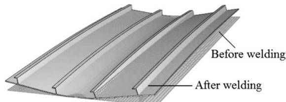
**Figure II-20 : Contraintes résiduelles calculées sur une tôle contenant des raidisseurs (Yan et al. 2011).**
