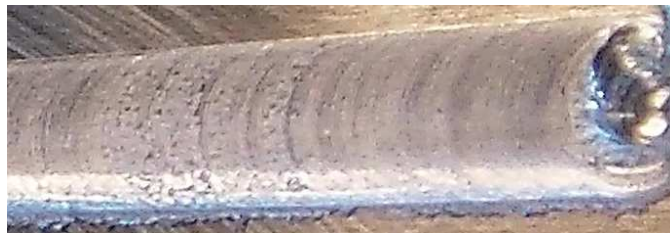
Figure V-18 : Essai 28, porosité en surface.
