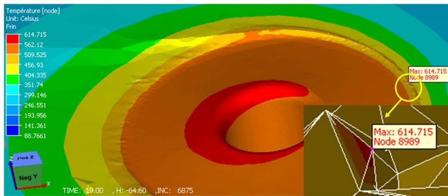
Figure III-14 : Température aberrante en un nœud de la surface libre lorsqu'on prend en compte la composante du gradient dans la direction de l'écoulement – cette valeur devient acceptable en utilisant seulement la composante tangentielle.
