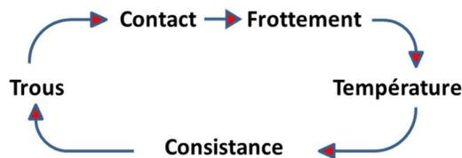
**Figure II-1 : Couplage thermomécanique.**
