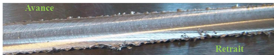
Figure VI-7 : Soudure avec bavure pour l'essai n°29.
