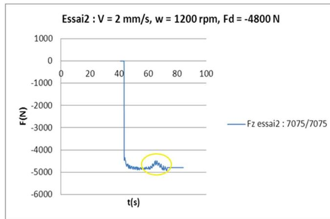
Figure V-45 : Force axiale (imposée) lors de l'essai 2 en 7075.
