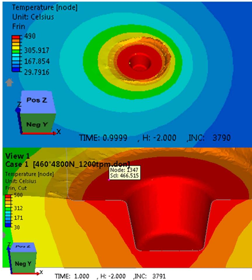
Figure VI-40 : Champ de température pour une valeur du coefficient de frottement  $p = 0,15$  et un filetage de pas de vis de 3 mm sur le pion. Vue de dessus (en haut) et zoom dans le plan de coupe dans la ligne de soudure (en bas).
