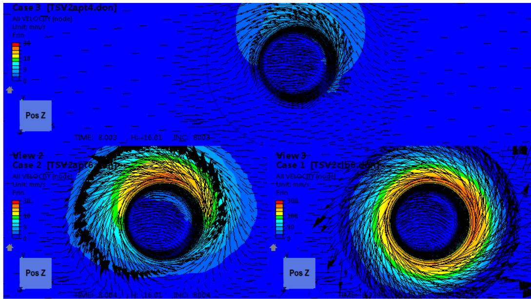
Figure VI-24 : Isovaleurs et vecteurs des vitesses. Haut : frottement de Norton avec  $\alpha = 0,4$  et  $p = 0,125$  ; bas à gauche : frottement de Norton avec  $\alpha = 0,6$  et  $p = 0,125$  ; bas à droite : frottement de Coulomb avec  $\mu = 0,8$  et  $\bar{m} = 1$ .
