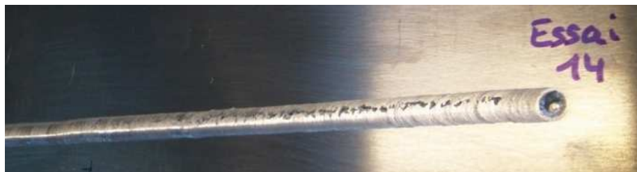
Figure V-46 : Trou en surface en milieu de soudure pour l'essai 14 en 2024/2024.
