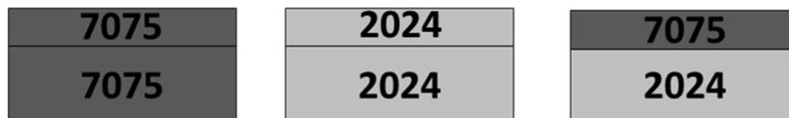
**Figure V-11 : Les 3 configurations de soudage par recouvrement testées.**
