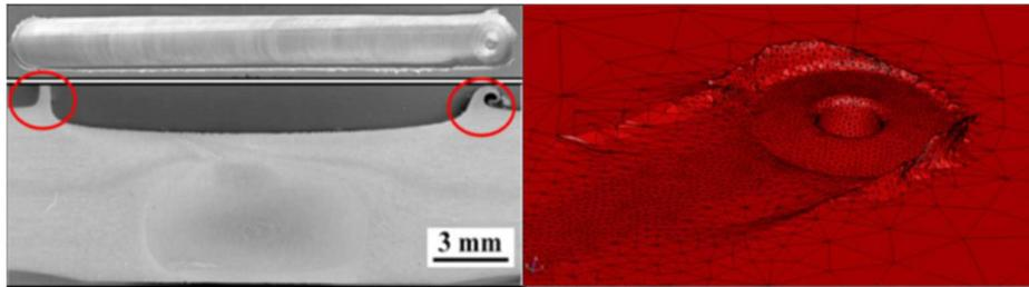
**Figure II-25 : Comparaison expérimentale/numérique d'une bavure (Fourment & Guerdoux 2008).**
