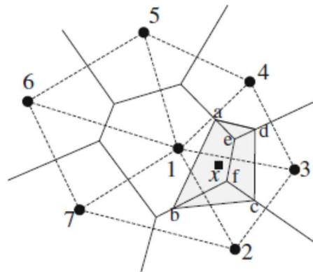
**Figure II-4 : Pavage de Voronoï (traits pleins) et triangulation de Delaunay (traits en pointillés).
