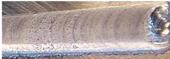
**Figure V-18 : Essai 28, porosité en surface.**
