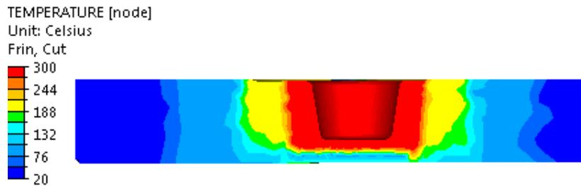
Figure VI-4 : Champs initial de température dans la tôle.
