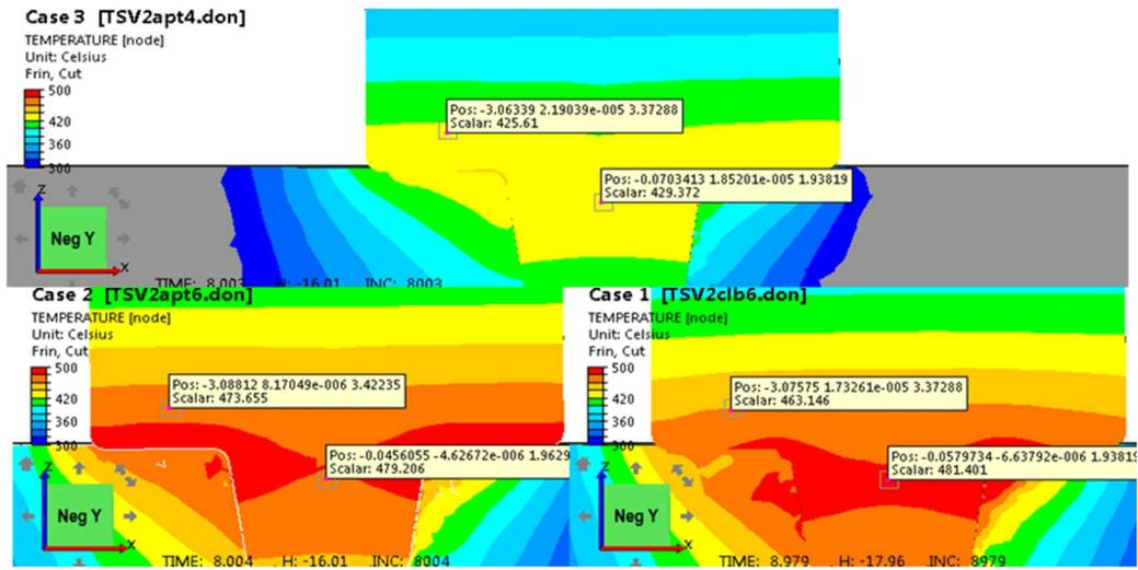
**Figure VI-26 : Champs de température dans le plan de coupe suivant la ligne de soudure. Haut : frottement de Norton avec  $\alpha = 0,4$  et  $p = 0,125$  ; bas gauche : frottement de Norton,  $\alpha = 0,6$  et  $p = 0,125$  ; bas droite : frottement de Coulomb,  $\mu = 0,8$  et  $\bar{m} = 1$ .**
