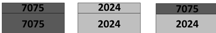
Figure V-11 : Les 3 configurations de soudage par recouvrement testées.
