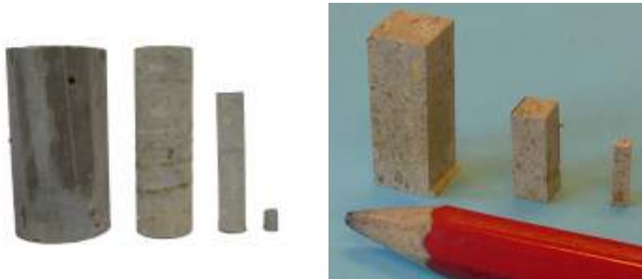
FIGURE 1.16 – A gauche : les éprouvettes entre 16cm et 20mm. A droite : les éprouvettes de 8mm, 4mm et 2.5mm.
