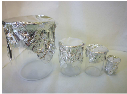
Figure 8 : Nettoyage et protection de la verrerie
