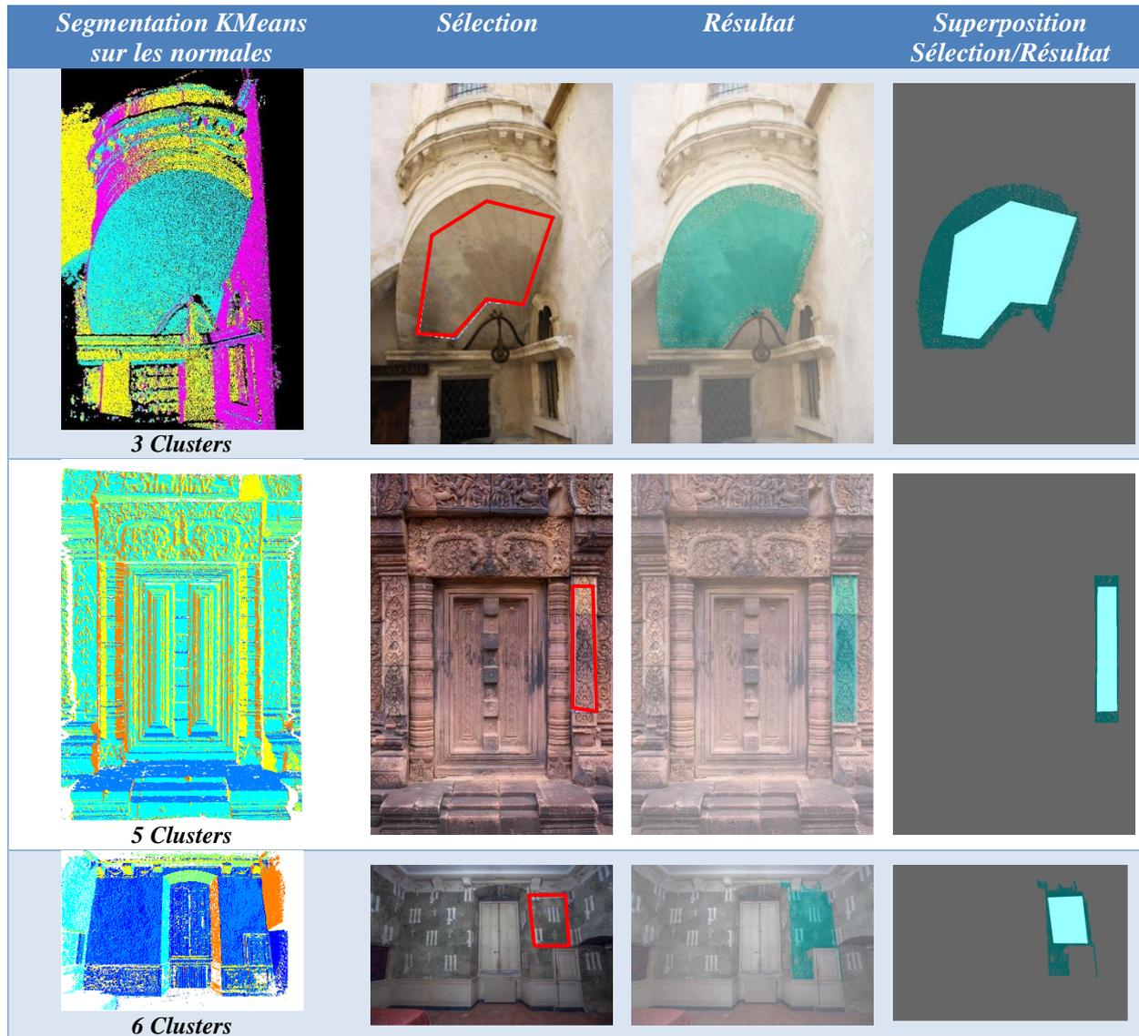
Figure 137 : Extension de sélection à l'aide d'une segmentation
