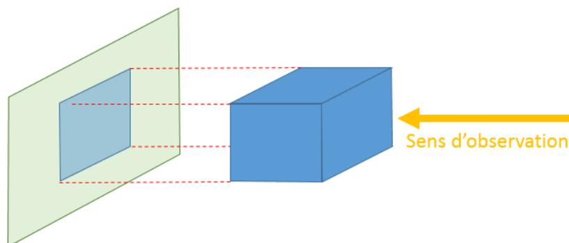
Figure 15 : Principe de la projection orthogonale
