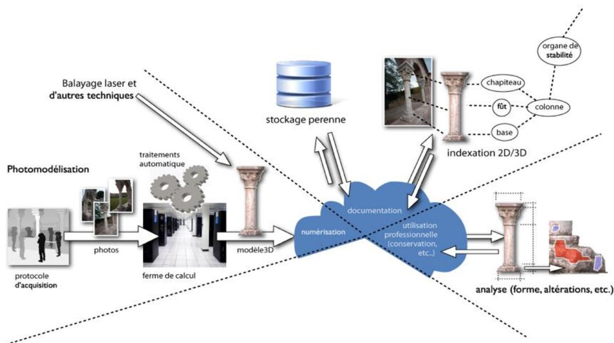
Figure 1 : Schéma de fonctionnement de la plateforme C3DC
