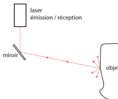
Figure 7 : Principe de fonctionnement des scanners longue portée [Marbs A. et al, 2001]
