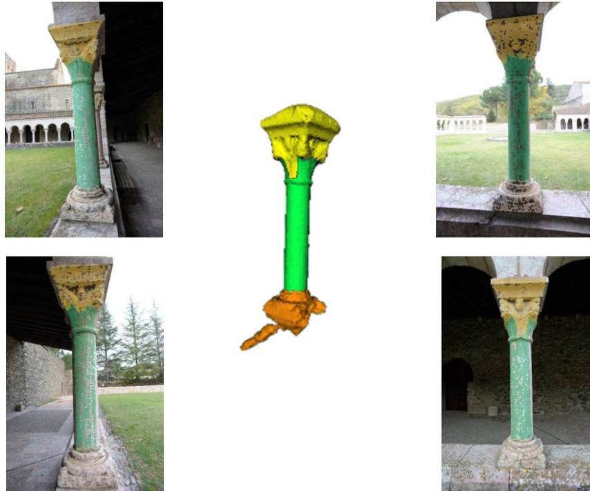
Figure 133 : Projection d'une segmentation 3D (obtenue avec ShapeAnnotator [Attene M. et al. 2007] sur les images
