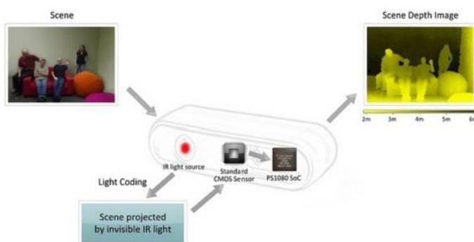
Figure 11 : Principe de la technologie Kinect
