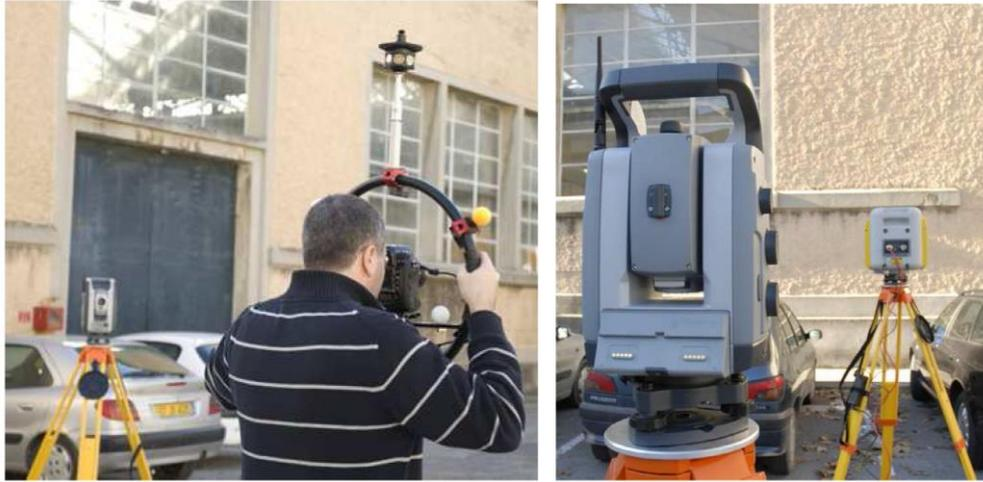
Figure 58 : Le système OMEGA [OMEGA] pour le référencement automatique d'images
