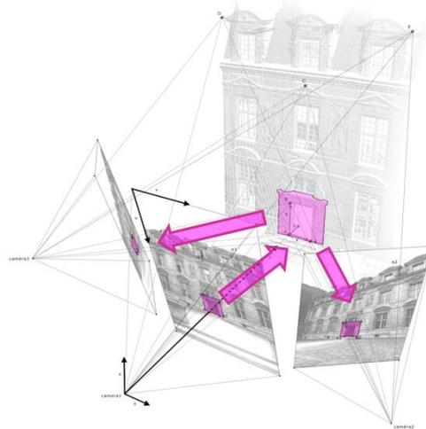
*Figure 56 : Les trois premières étapes de l'approche : un nuage point est réalisé à partir d'un ensemble de photographies ; les photographies sont spatialement référencées autour du nuage ; la relation projective entre 2D et 3D permet de transférer les annotations entre les images et le nuage de points*
