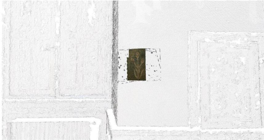
*Figure 98 : Génération d'une zone plus dense dans le nuage de points pour des images de détails*
