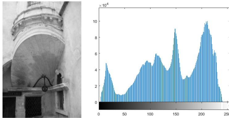
Figure 22 : Histogramme d'une image en niveaux de gris
