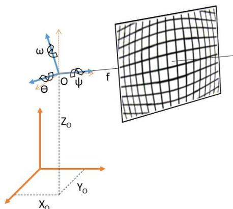
Figure 26 : Paramètres de calibration interne et externe
