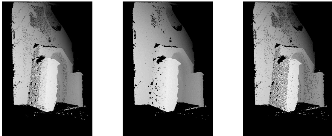
Carte de profondeur « brute » Carte de profondeur « lissée » Carte de profondeur corrigée Figure 76 : Correction des points par l'étude de la carte de profondeur
