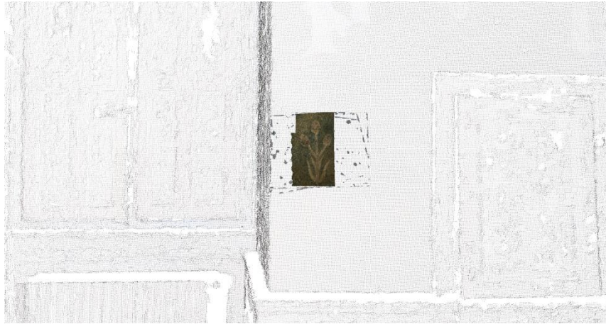
Figure 98 : Génération d'une zone plus dense dans le nuage de points pour des images de détails
