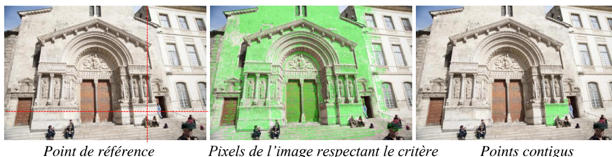
Figure 130 : Résultats de la "baguette magique" sur les normales d'une image pour une tolérance de 22 degrés avec ou sans contiguïté
