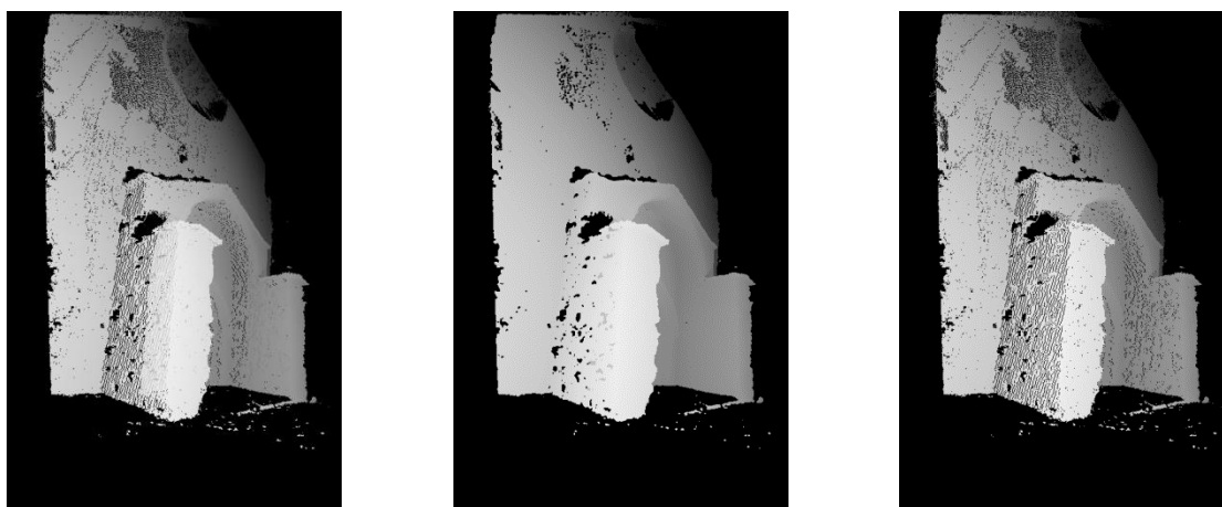
Carte de profondeur « brute » Carte de profondeur « lissée » Carte de profondeur corrigée
