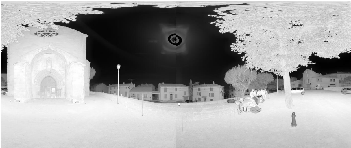
Figure 82 : Image (luminance) extraite d'un nuage de point relevé par scanner laser 3D Faro (projection sphérique)
