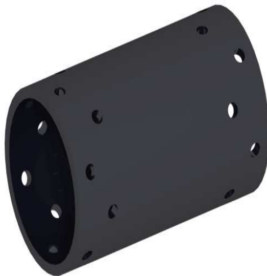
FIGURE 2.19: Éprouvette usinée, de 52,7 mm de diamètre.
