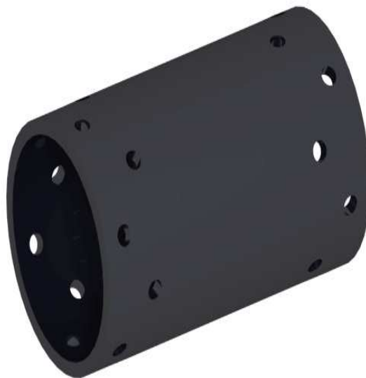
FIGURE 2.19: Éprouvette usinée, de 52,7 mm de diamètre.
