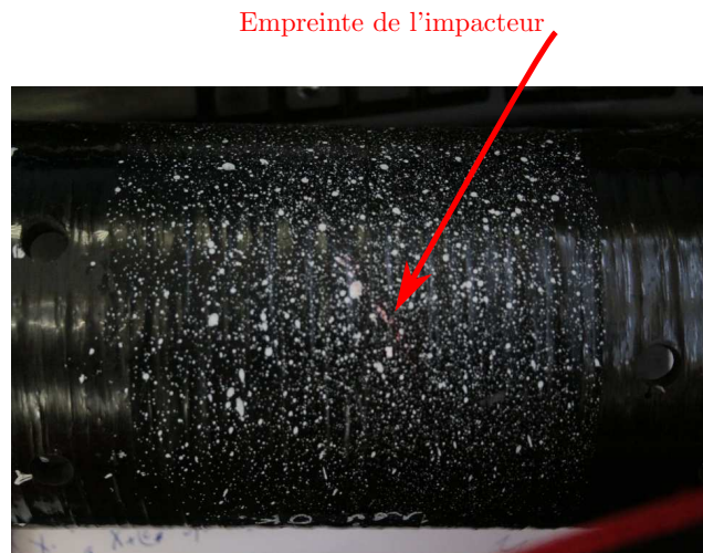
FIGURE 3.41: Photographie de la surface du tube (architecture 1) après impact à 300 J, sans pression
