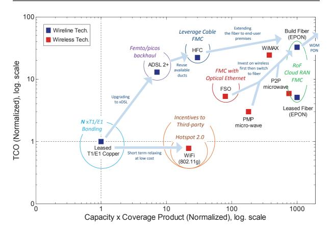
Figure 1.2: Benchmark des solutions technologiques de féderations des BSs et directions strategiques possibles d'évolution pour un opérateur Télécom.
