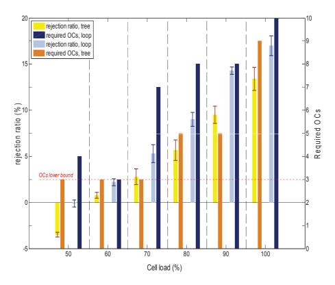
Figure 1.14: Comparaison entre l'architecture en boucle et celle en arbre pour GeRoFAN en terme de taux de rejet (axe à gauche) et de nombre de porteuses optiques requises (axe à droite). Les valeurs négative de taux de rejet indiquent un excès de capacité par rapport à la charge de trafic. Les valeurs de taux de rejet indiquées sont des des moyennes, les STD bars donnent la variance entre les différentes cellules.
