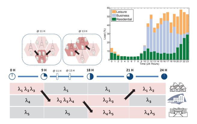
Figure 1.8: Gestion de la resource radio/optique à court et à moyen terme par le GeRoFAN-CP.
