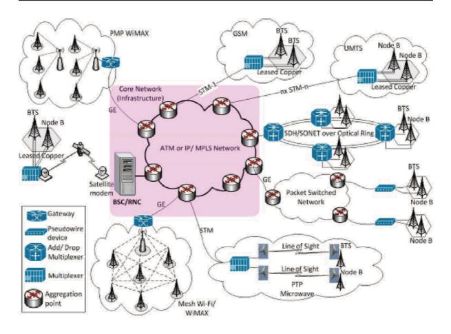
Figure 1.1: Technologies traditionnelles et émergentes de federations des BS [102].
