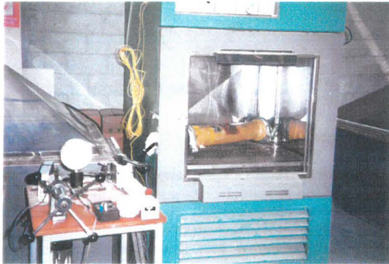
Figure IV.6 – Dispositif d'essai avec contrôle de la température et de la pression interne.
