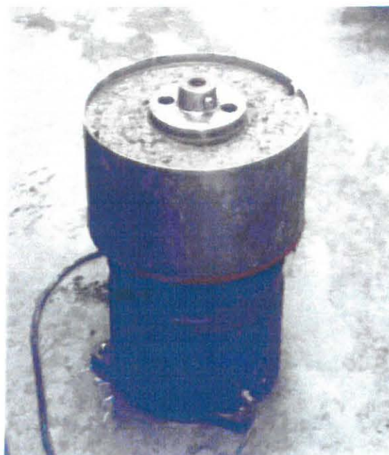
Figure III.11 – Tribomètre à cylindres coaxiaux rempli de béton.
