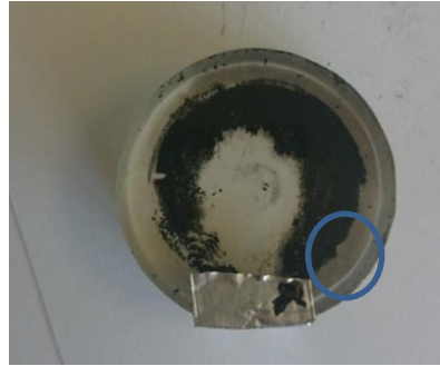
Photo de l'enrobé et repérage de la zone où le grain de S202 se situe
