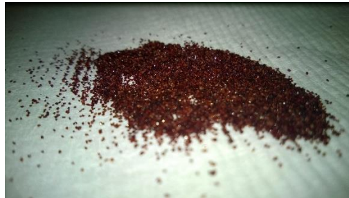
Figure 71 : Photo du S202 synthétisé après 3 cycles d'imprégnation
