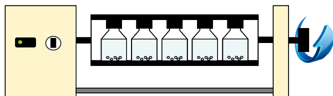
Figure 31 : Schéma des essais batch représentant les flacons Pyrex 100mL sur un agitateur rotatif
