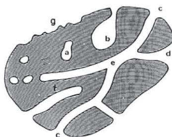
Figure A. 7. Schéma d'un solide poreux présentant différentes formes de porosité 41
