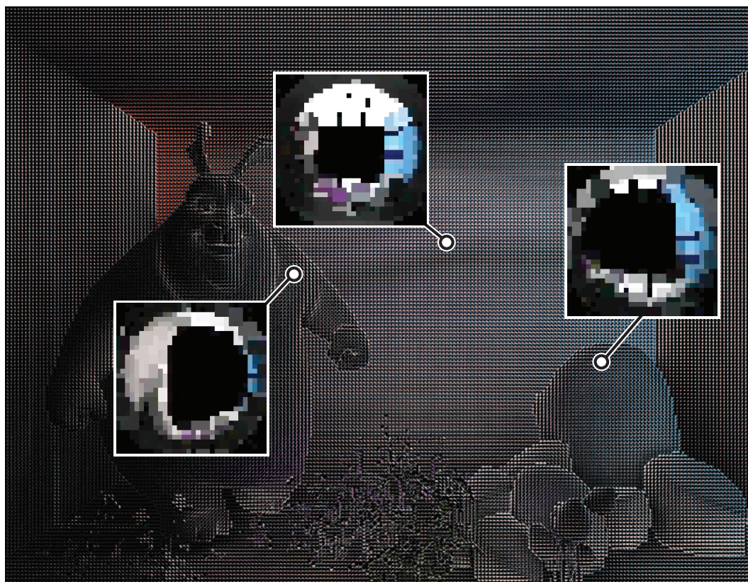
Figure 0.13: Rendu de 33280 vues ( 208 \times 160 ), où chaque vue a une résolution de 32 \times 32 pixels.
