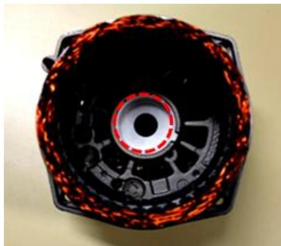
Figure 49 Le centre de la portée du stator
