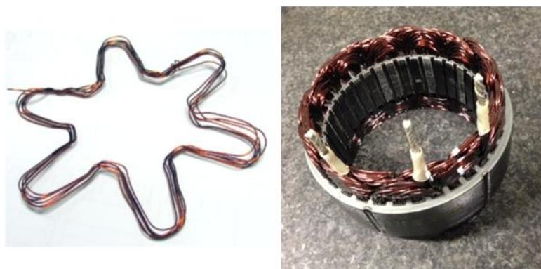
Figure 40 Bobine préformée avant insertion et stator bobiné
