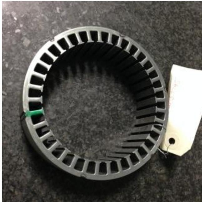
Figure 43 Le stator non bobiné
