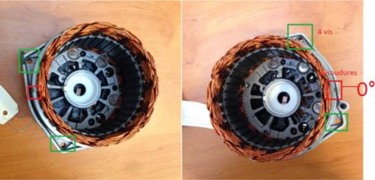
Figure 36 Les 6 soudures et les 4 vis
