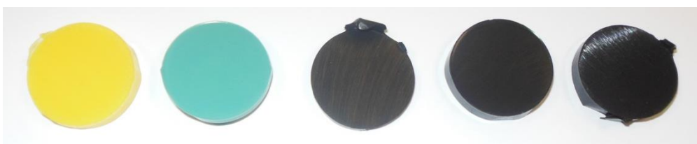
Figure 2.12. Exemple d'échantillons répliqués par chaque résine. De gauche à droite : Technovit, Provil Novo, Microset, ReplisetF1, ReplisetF5.
