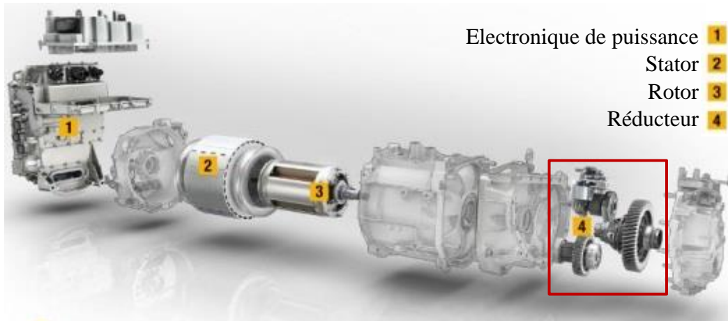
Figure 3.1. Groupe motopropulseur électrique (GMPé) développé par Renault. La partie étudiée est la partie gauche de l'encadré rouge.
