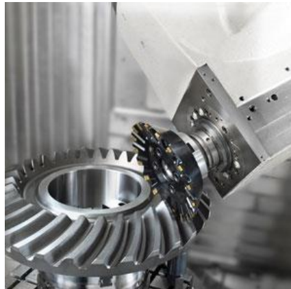
Figure 1.21. Exemple d'opération de fraisage à la fraise module d'un pignon à dentures spiro-conique (source Gearsolutions ).
