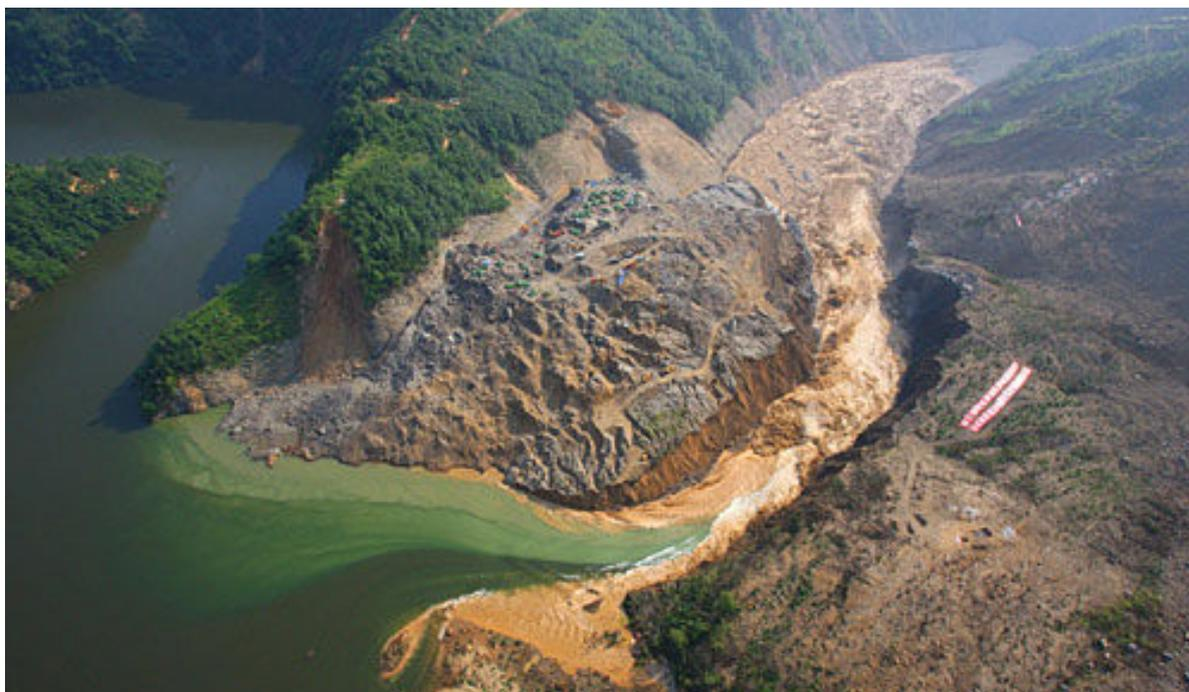
**Figure 10.** Le glissement de Tangjiashan sur la rivière de Jian, déclenché par le séisme de Sichuan (12-05-2008,  $M_w=7.9$ ) a formé un lac artificiel de 240 million  $m^3$  et a mis en danger 1.3 million d'habitants des villes de Beichuan et Mianyang en aval (Cojean et al., 2009<sup>[49]</sup>)
