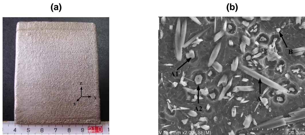
Figure 1-53 : (a) Représentation d'un mur CMTi fabriqué par FDPL, (b) Microstructure des renforts TiB et TiC dans une matrice Ti-6Al-4V (A : TiB, B : TiC) (Zhang & al., 2011)
