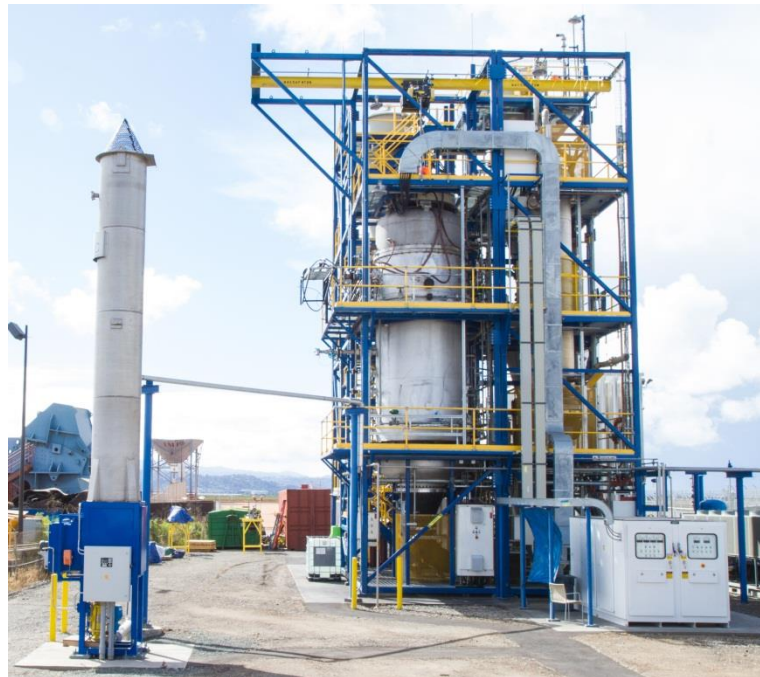
Figure 25 : Installation SEAPORT I de Monolith Materials aux Etats-Unis pour la production de noir de carbone et d'hydrogène, développée en partenariat avec Mines ParisTech
