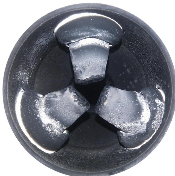
Figure 35: Vue de dessus de la zone de décharge électrique de la torche triphasée, après un fonctionnement d'une heure à l'air.
