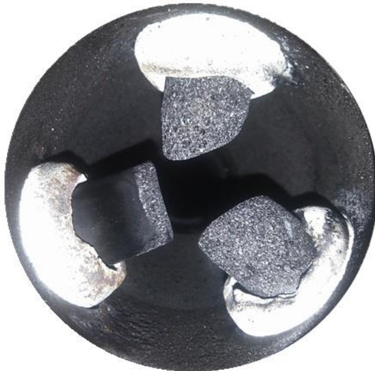
Figure 37 : Vue de dessus de la zone de décharge électrique de la torche triphasée, après un fonctionnement pendant 30 minutes au monoxyde de carbone.
