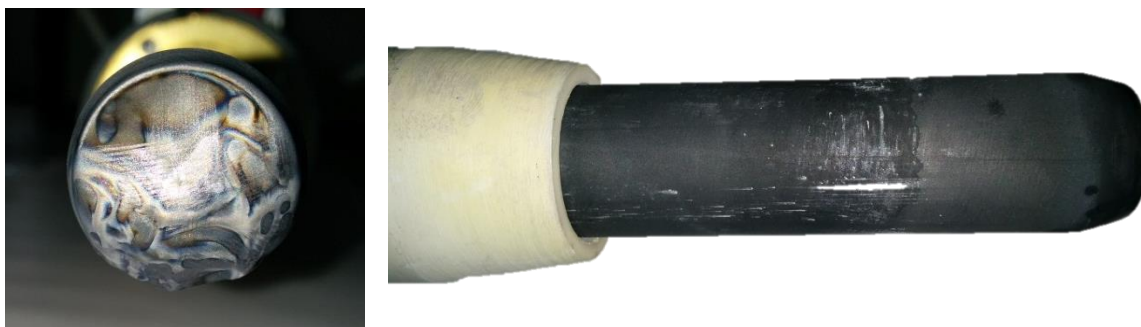
Figure 57 : Vue de face et vue de côté d'une électrode en graphite érodée après un fonctionnement à l'azote (nouvelle torche plasma)
