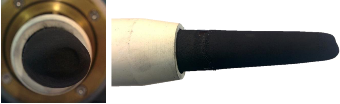
Figure 58 : Vue de face et vue de côté d'une électrode en graphite érodée après un fonctionnement à l'air avec un gainage d'azote (nouvelle torche plasma).
