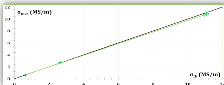
Figure 97 : Conductivités mesurées en fonction des conductivités de référence (capteur plateau)
