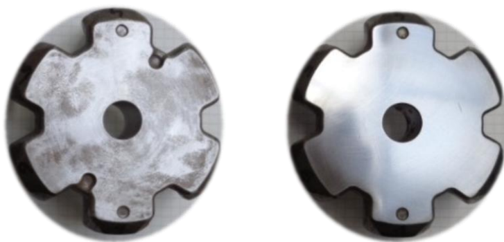
Figure 111 : Photographies d'une roue polaire avant et après polissage (roue arrière, fournisseur 1)
