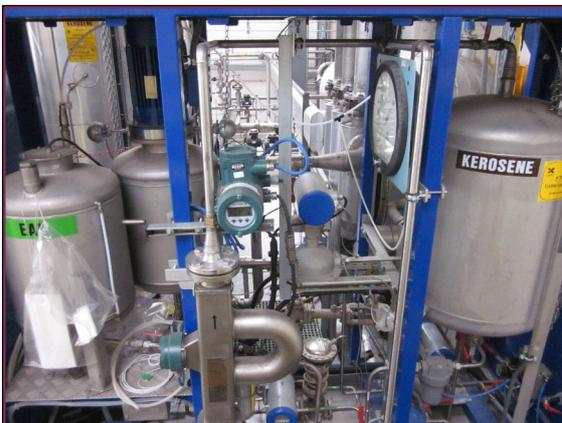
FIGURE 3.2 – Le *skid* givrage. Il comporte trois cuves, des pompes de transfert et divers capteurs dont un débitmètre.
