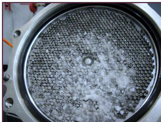
FIGURE 1.5 – Entrée de l'échangeur de chaleur du Trent 800 obstruée par de la glace lors de l'enquête [185].
