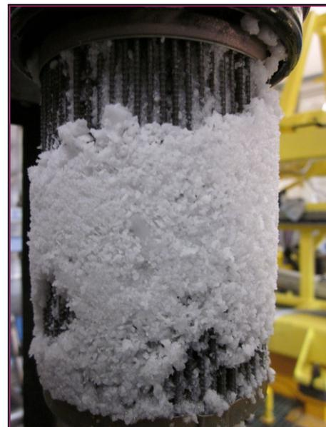
FIGURE 9.14 – Dépôt de glace sur un élément filtrant.
