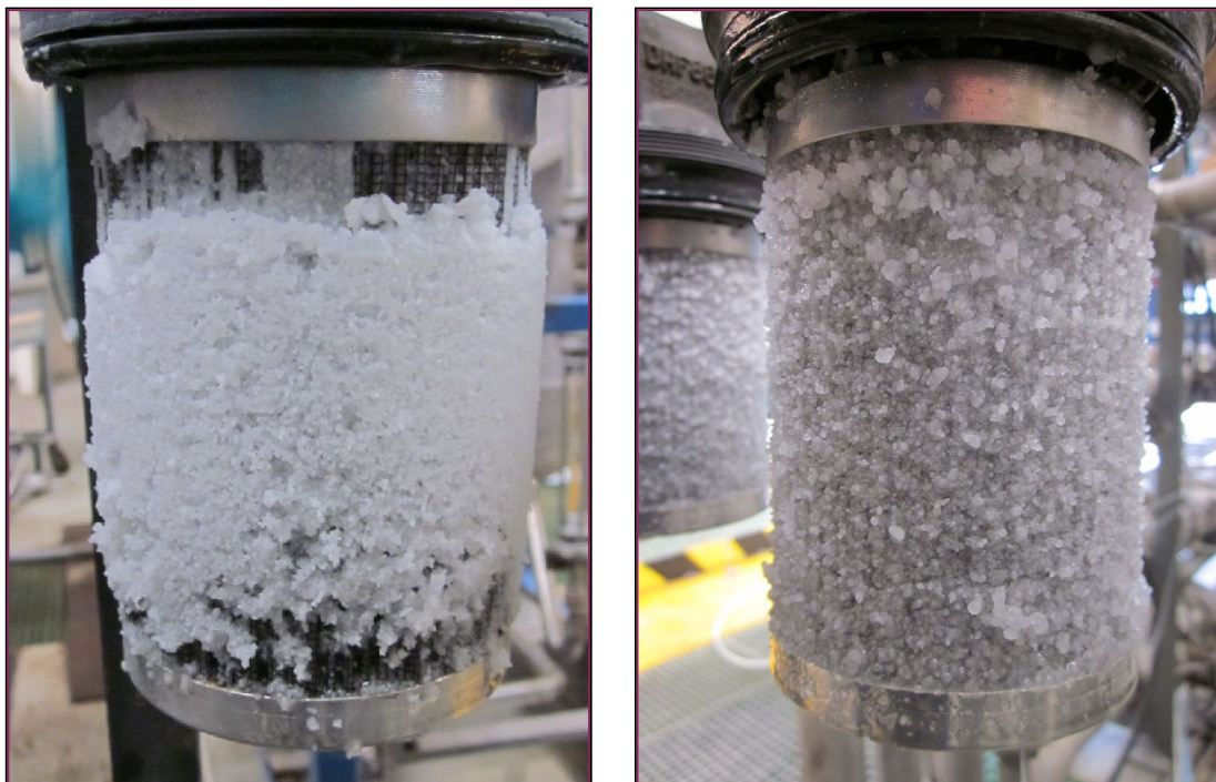
FIGURE 3.8 – Accrétion de glace sur le filtre : pour des températures de l'ordre de -40^{\circ}\text{C} (à gauche) et de l'ordre de -5^{\circ}\text{C} (à droite)
