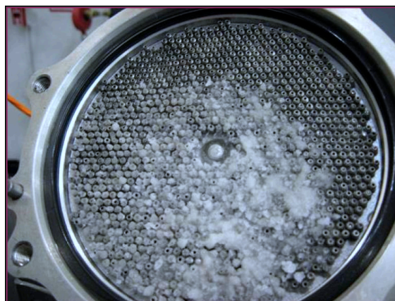
FIGURE 1.5 – Entrée de l'échangeur de chaleur du Trent 800 obstrué par de la glace lors de l'enquête [185].
