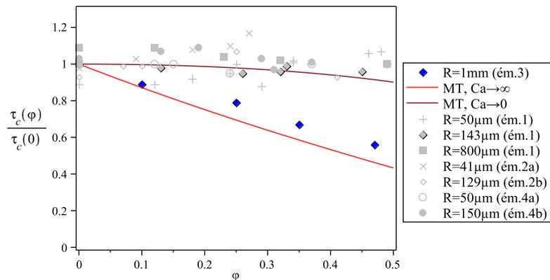
FIGURE 4.11 – Seuil de contrainte adimensionné en fonction de la fraction volumique en bulle. Courbe rouge : estimation de Mori-Tanaka pour  $Ca \rightarrow \infty$ . Losanges bleus : bulles de  $1000 \mu\text{m}$ . Les valeurs mesurées sur les autres systèmes d'émulsions sont rappelées pour comparaison. Données d'après Lucie Ducloué [29].
