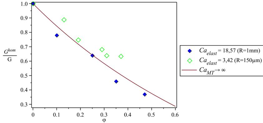
FIGURE 4.9 – Système à grands nombres capillaires : module de cisailment adimensionné en fonction de la fraction volumique en bulles. Courbe marron : estimation de Mori-Tanaka pour  $Ca \rightarrow \infty$ . Losanges bleus pleins : bulles de  $1000 \mu\text{m}$ . Losanges verts : bulles de  $150 \mu\text{m}$ . Données expérimentales d’après Lucie Ducloué [29].
