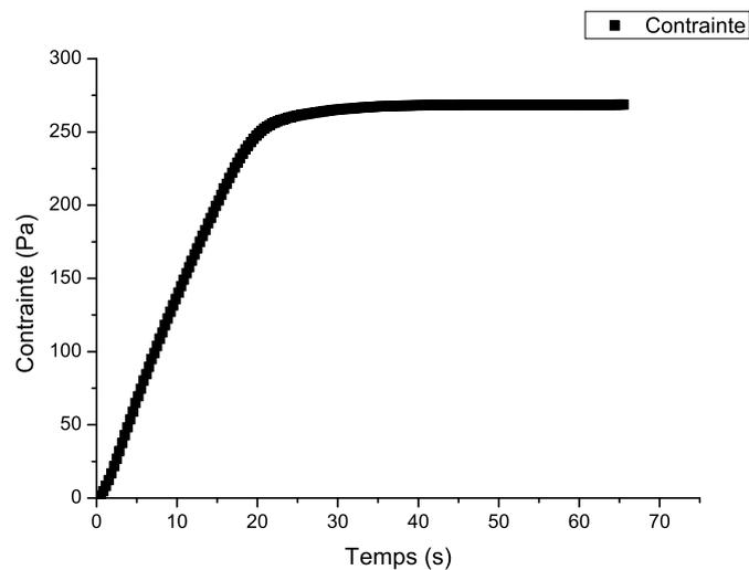
FIGURE 3.7 – Exemple de contrainte seuil mesurée sur une émulsion contenant 91 % d’huile.
