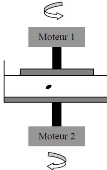
FIGURE 3.12 – Dispositif de cisaillement « plan-plan », d’après la référence [3].
