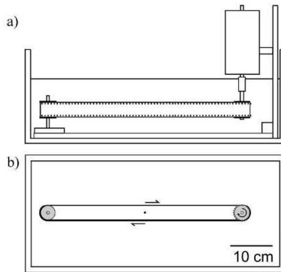
FIGURE 3.11 – Dispositif de cisaillement à « bandes parallèles », d'après la référence [54], a) Vue latérale, b) Vue de dessus.
