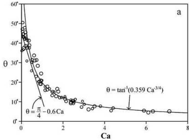
FIGURE 2.11 – Orientation stable des bulles soumises à un écoulement en cisaillement simple décrite par une relation entre  $Ca$  et  $\theta$ . Le trait plein et la courbe sont des relations théoriques (2.51) de Hinch et Acrivos pour  $\theta(Ca)$  à faibles et fortes déformations. D’après Rust et Manga [54].
