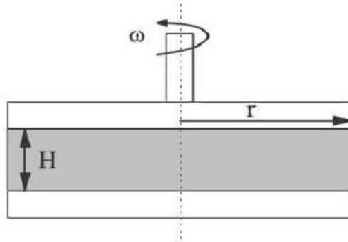
FIGURE 3.5 – Géométrie plan-plan.
