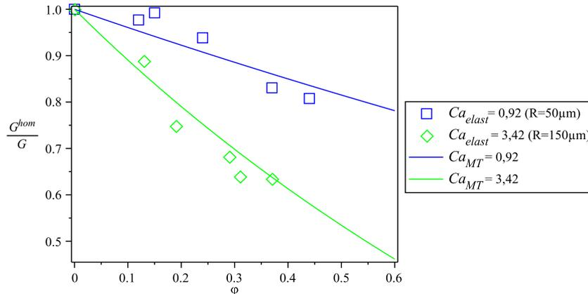
FIGURE 4.8 – Module élastique adimensionné en fonction de la fraction volumique en bulles pour des suspensions de bulles de 50  $\mu\text{m}$  dans l'émulsion 4a et de 150  $\mu\text{m}$  dans l'émulsion 4b. Les courbes en trait plein sont les estimations du module élastique adimensionné de Mori-Tanaka. Données expérimentales d'après Lucie Ducloué [29].
