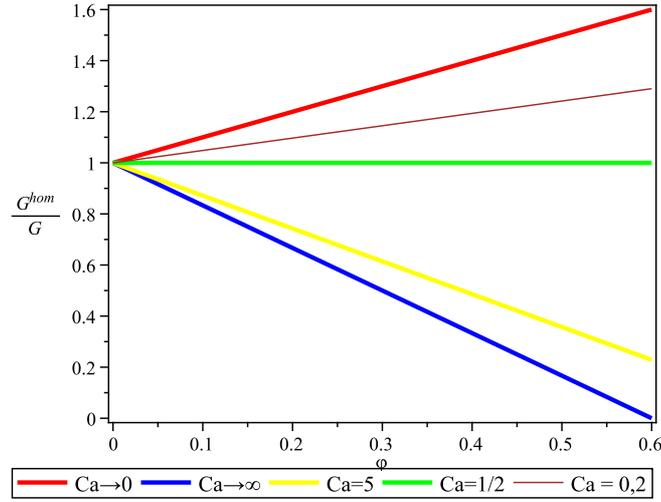
FIGURE 4.1 – Estimation diluée du module de cisaillement adimensionné en fonction de la concentration en bulles.
