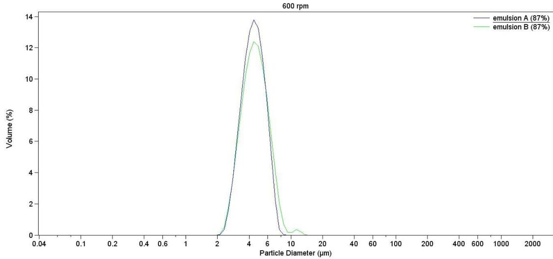
FIGURE 3.4 – Reproductibilité de la préparation des émulsions : deux émulsions de même fraction volumique en huile (87 %) et même taux de cisaillement ( $\dot{\gamma} = 14200 \text{ s}^{-1}$ ) obtenues à partir de deux prémélanges différents.
