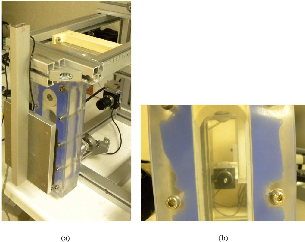
FIGURE 3.14 – (a) Dispositif de cisaillement d’une bulle dans un fluide fabriqué au laboratoire ; (b) Image d’une bulle déformée sous un cisaillement simple dans une expérience au laboratoire.
