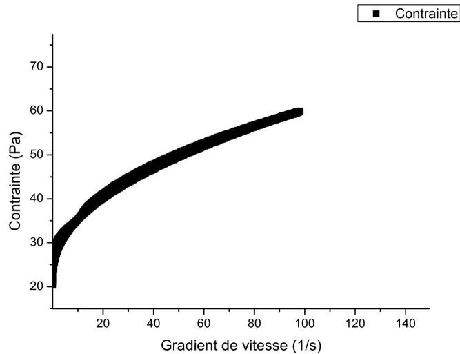
FIGURE 3.9 – Exemple de courbe d’écoulement du Carbopol.
