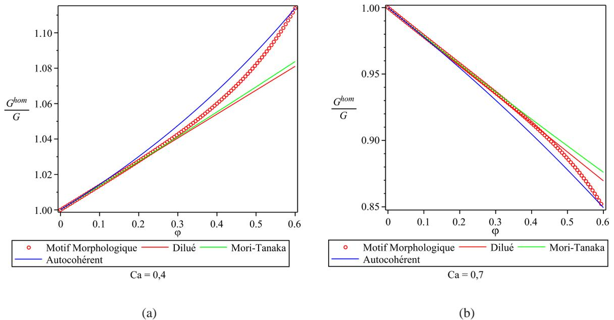
FIGURE 4.4 – Estimation du module de cisaillement adimensionné en fonction de la fraction volumique en bulles pour une suspension isotrope de bulles monodisperses pour  $Ca_{elast} = 0,4$  ( $f = 0,6$ ) et  $Ca_{elast} = 0,7$  ( $f = 0,6$ ).
