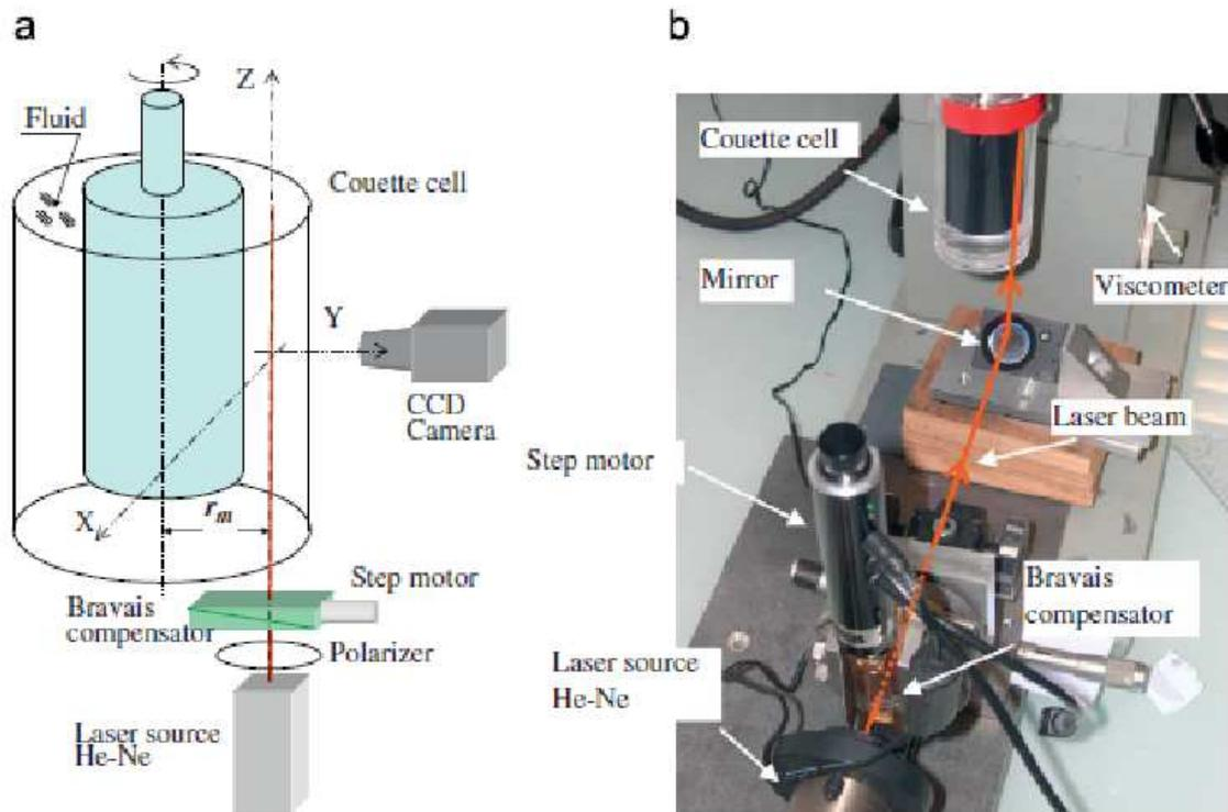
FIGURE 3.13 – Exemple d'un dispositif de cisaillement « cellule de Couette », d'après la référence [10].
