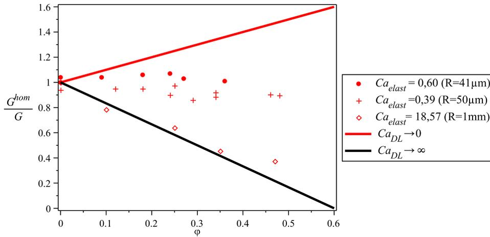
FIGURE 4.6 – Module élastique adimensionné en fonction de la fraction volumique en bulles. Rouge : prédiction pour  $Ca \rightarrow 0$ , noir : prédiction pour  $Ca \rightarrow \infty$ , disques pleins : bulles de 41  $\mu\text{m}$  - Forafac, croix : bulles de 50  $\mu\text{m}$  - SDS, losange : bulles de 1000  $\mu\text{m}$  - TTAB.
