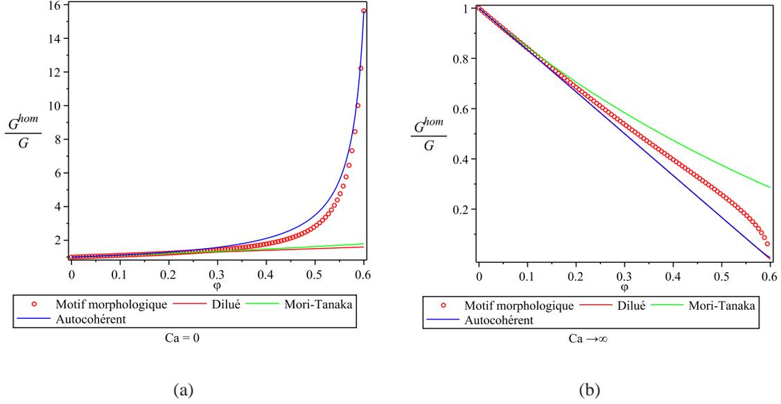
FIGURE 4.3 – Estimation du module de cisaillement adimensionné en fonction de la fraction volumique en bulles pour une suspension isotrope de bulles monodisperses pour  $Ca_{elast} = 0$  ( $f = 0, 6$ ) et  $Ca_{elast} \rightarrow \infty$  ( $f = 0, 6$ ).
