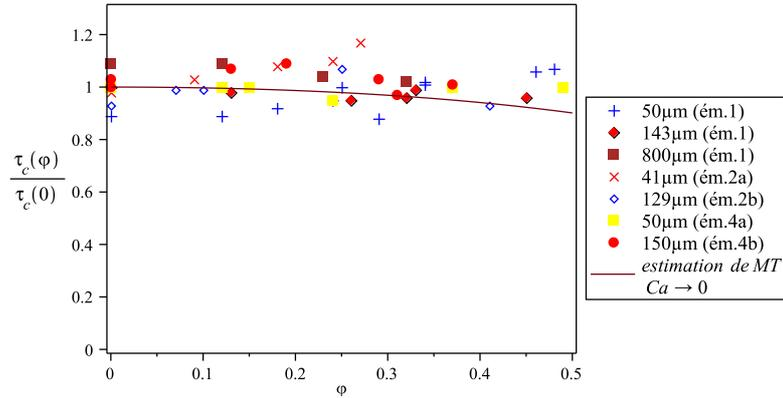
FIGURE 4.10 – Seuil de contrainte adimensionné en fonction de la fraction volumique en bulle. Courbe marron : estimation de Mori-Tanaka pour  $Ca \rightarrow 0$ . Les points expérimentaux sont mesurés pour 7 systèmes d'émulsions étudiées par Lucie Ducloué [29].
