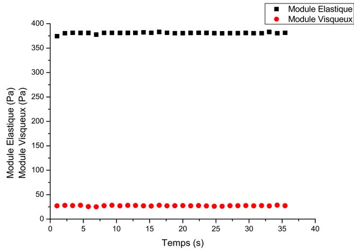
FIGURE 3.6 – Exemple de module élastique et module visqueux d’une émulsion contenant 87% d’huile.
