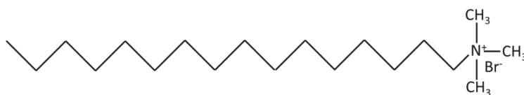
Figure 17: Formule semi-développée de la molécule de CTAB.
